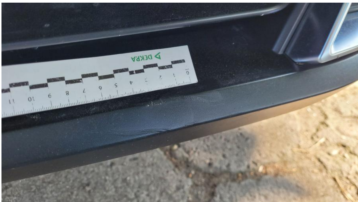
Fot. 32 Zderzak - Rysa/odprysk 1
