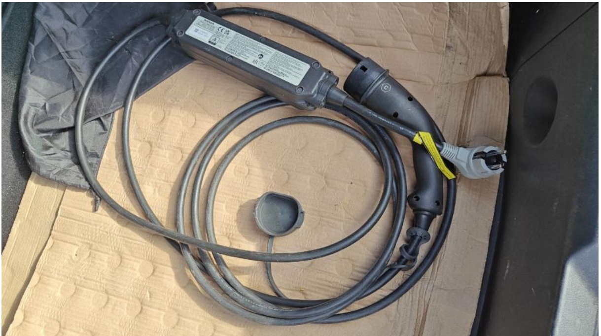
Fot. 28 Przewód ładowania baterii trakcyjnej
