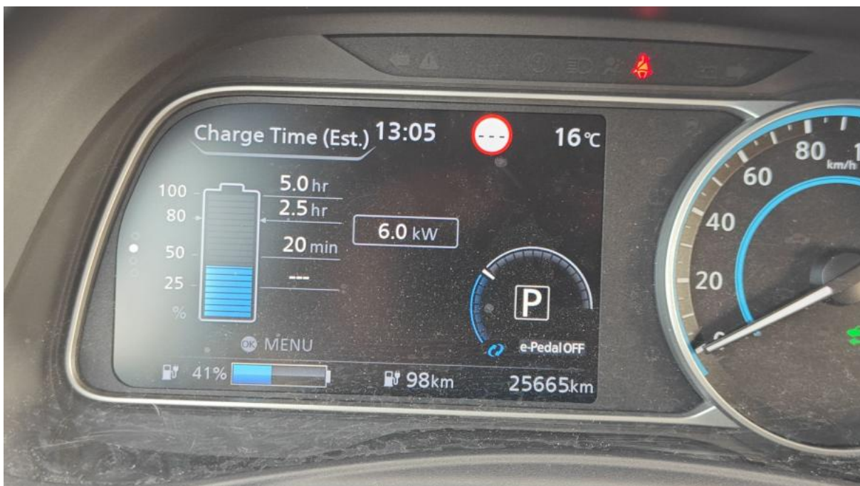
Fot. 16 Wskaźnik naładowania baterii trakcyjnej
