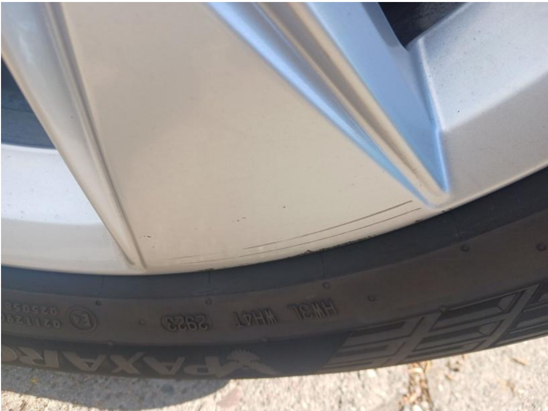
Fot. 39 Felga aluminiowa przednia P - Rysa/odprysk 1
