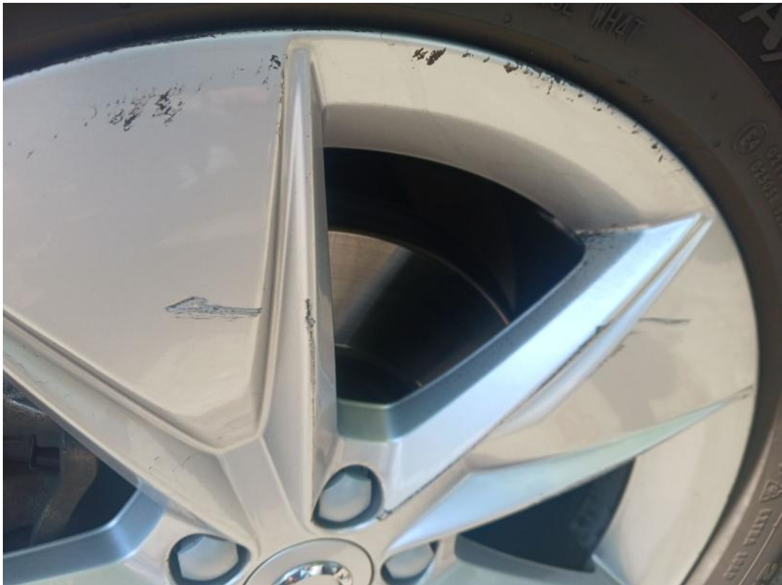
Fot. 43 Felga Aluminiowa przednia L - Rysa/odprysk 1
