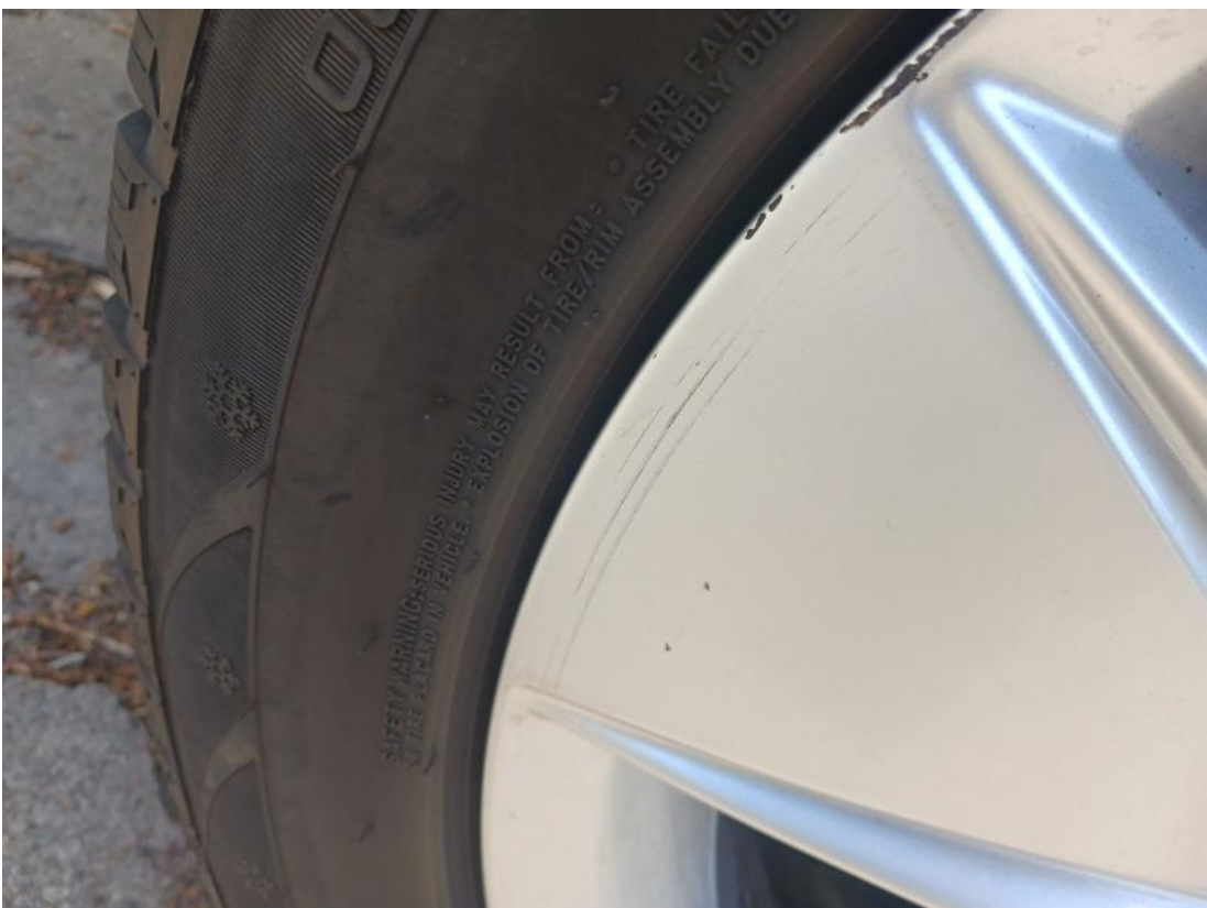
Fot. 40 Felga aluminiowa tylna P - Rysa/odprysk 1
