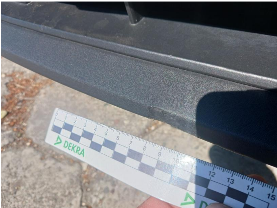
Fot. 38 Zderzak przedni cz dolna - Wgniecenie/odkształcenie 1
