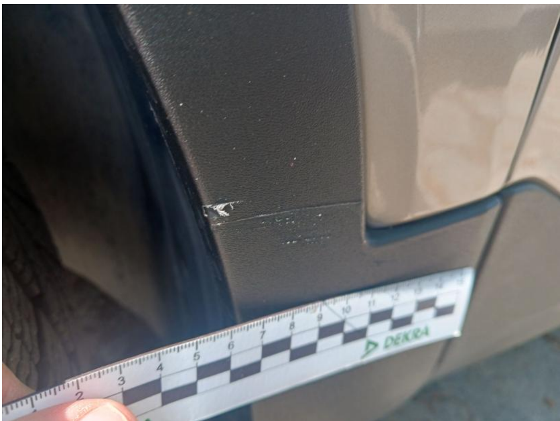
Fot. 44 Listwa błotnika przedniego L - Rysa/odprysk 1
