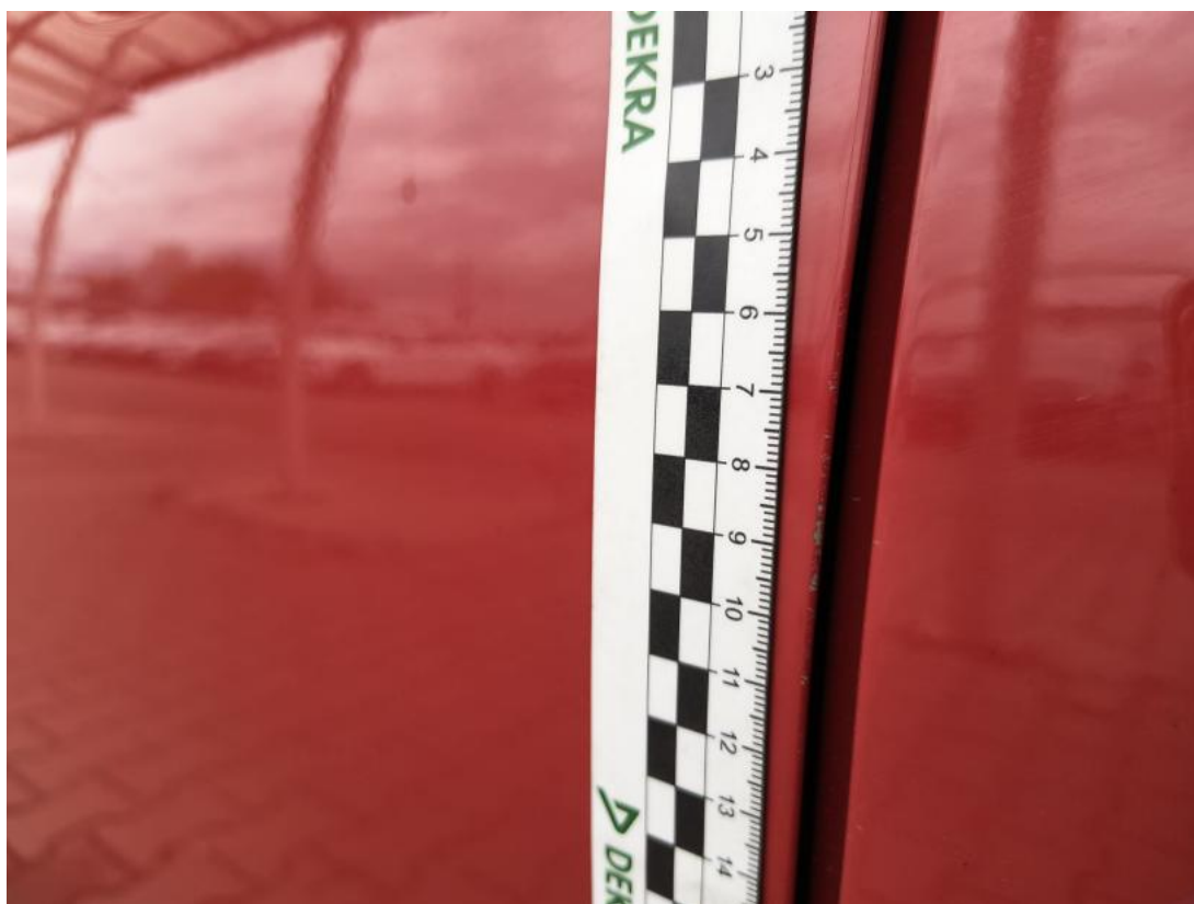
Fot. 45 Drzwi przed L - Rysa/odprysk 1
