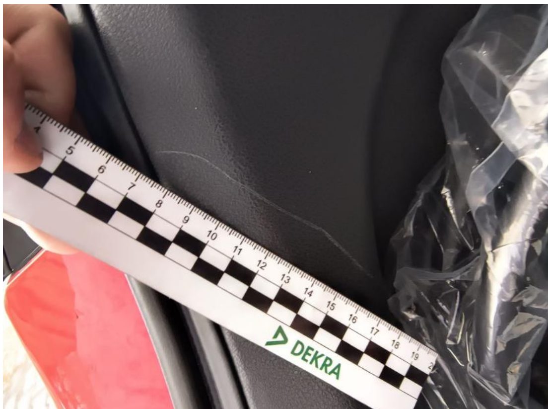
Fot. 49 Wykładzina przestrzeni bagażowej - Rysa/odprysk 1
