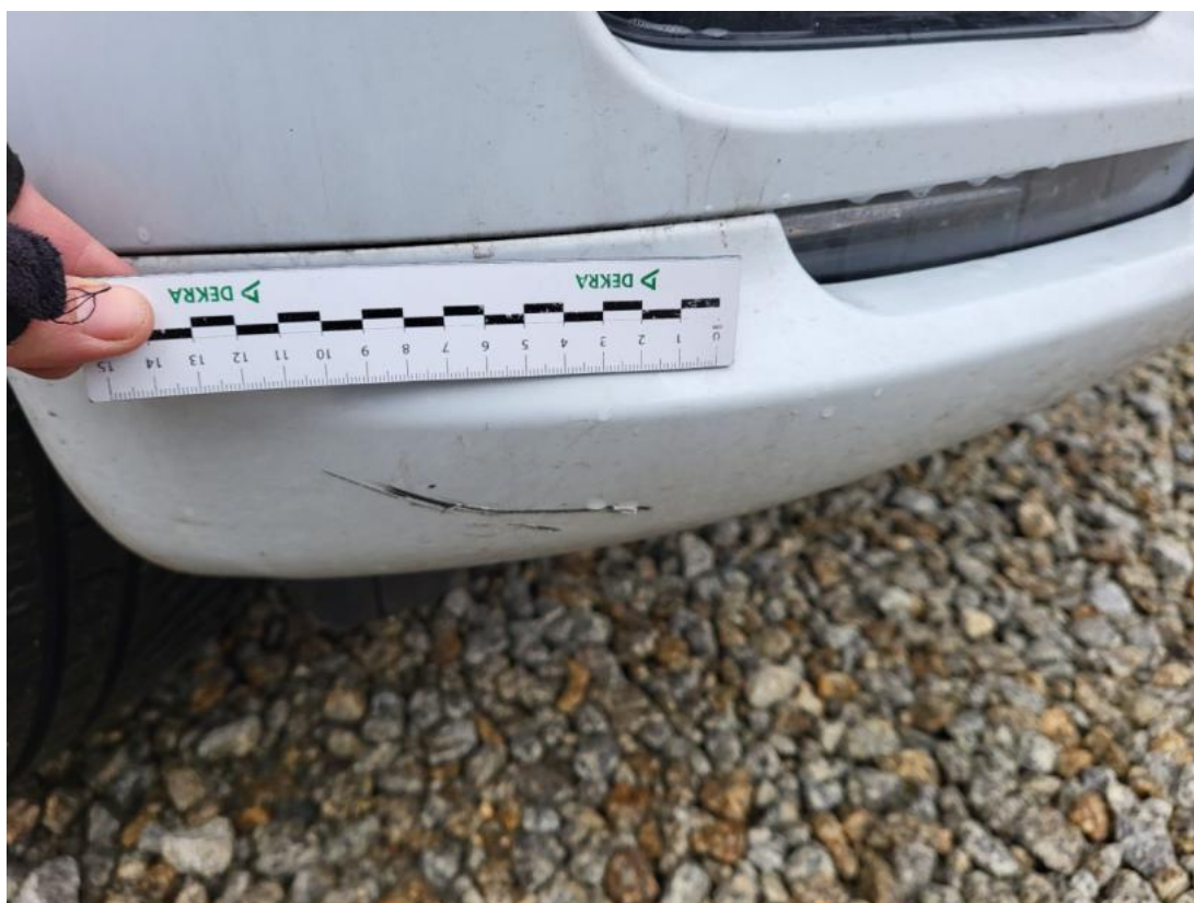
Fot. 41 Zderzak() - Rysa/odprysk 3
