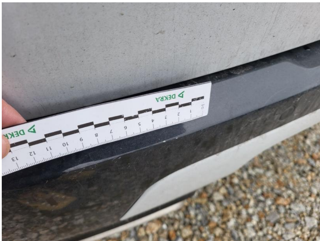
Fot. 45 Zderzak tylny - Rysa/odprysk 2
