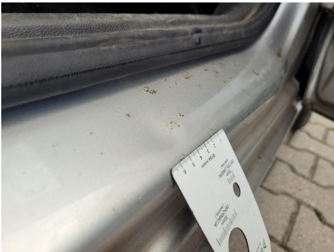
Fot. 42 Próg P - Wgniecenie/odkształcenie 1
