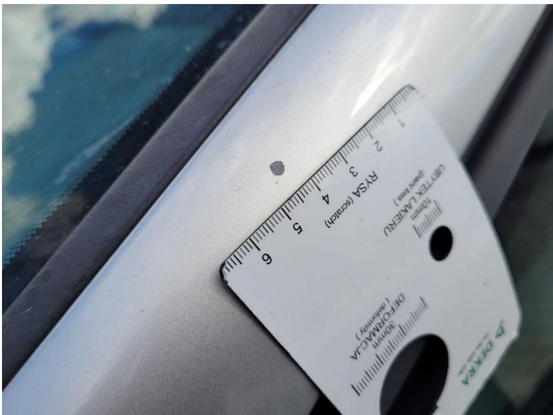
Fot. 56 Słupek przedni L - Rysa/odprysk 1
