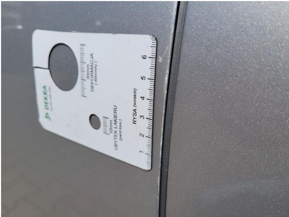
Fot. 55 Drzwi przed L - Rysa/odprysk 1
