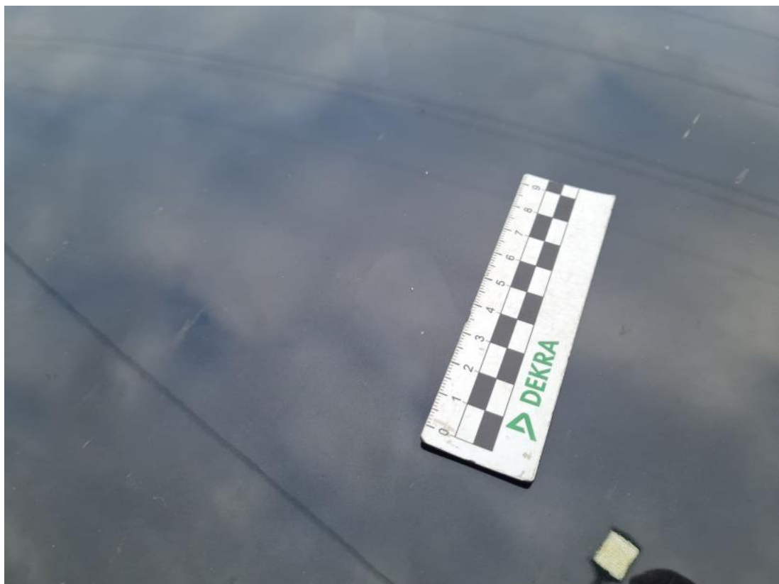
Fot. 42 Pokrywa komory silnika - Rysa/odprysk 1
