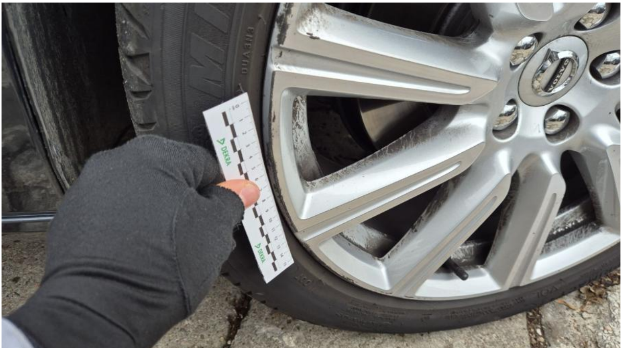
Fot. 44 Felga przednia P - Rysa/odprysk 1
