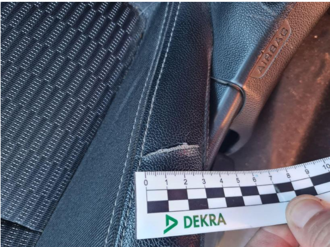
Fot. 40 Fotel prz. lew. - Pęknięcie/rozerwanie 1
