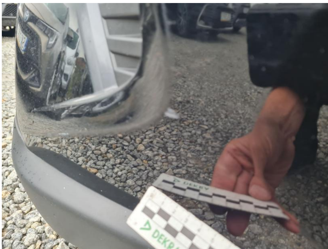
Fot. 50 Zderzak - Rysa/odprysk 2
