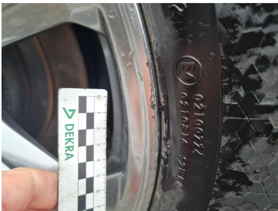
Fot. 62 Felga aluminiowa tylna P - Rysa/odprysk 2
