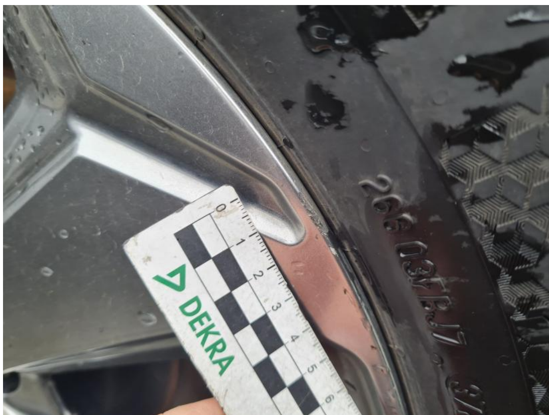
Fot. 61 Felga aluminiowa tylna P - Rysa/odprysk 1
