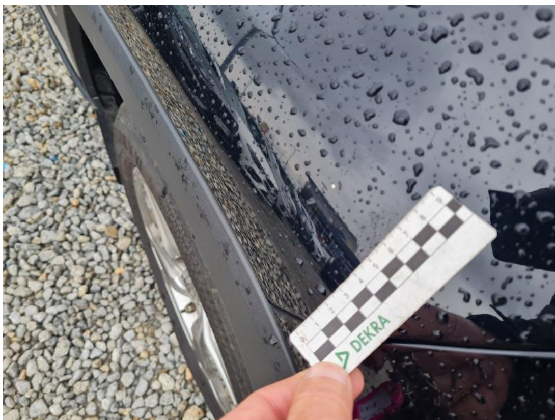
Fot. 52 Błotnik przedni P - Rysa/odprysk 1
