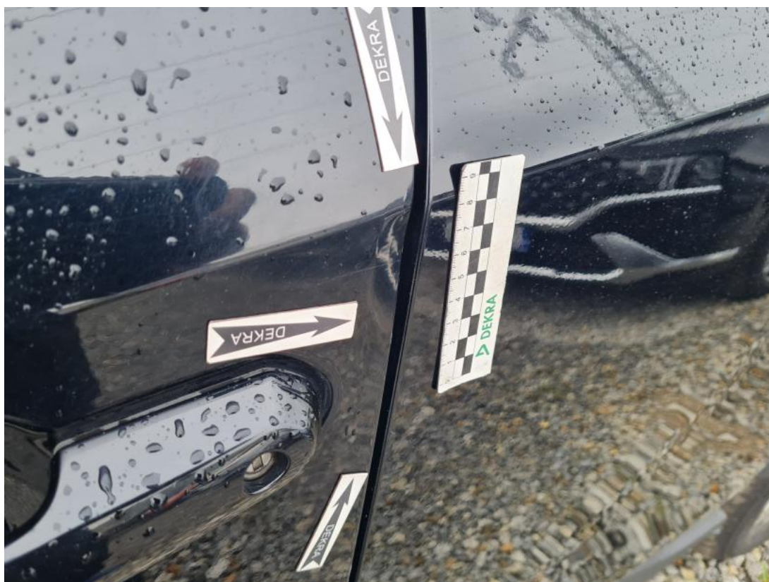
Fot. 67 Drzwi przed L - Wgniecenie/odkształcenie 1
