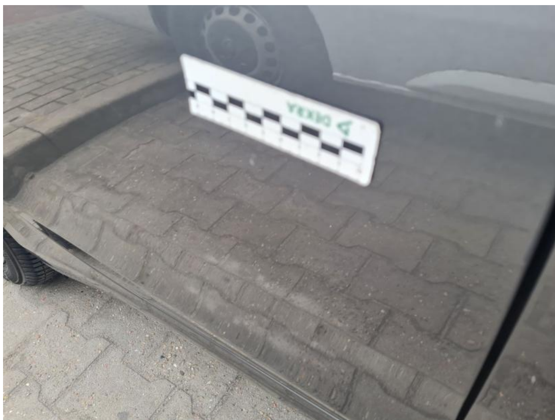
Fot. 40 Drzwi tylne P - Rysa/odprysk 1
