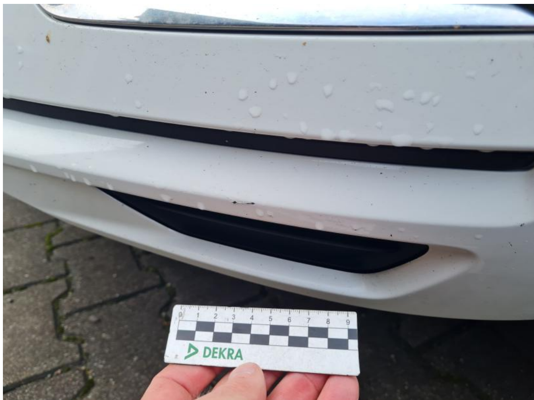
Fot. 44 Spoiler zderzaka przedniego - Rysa/odprysk 1
