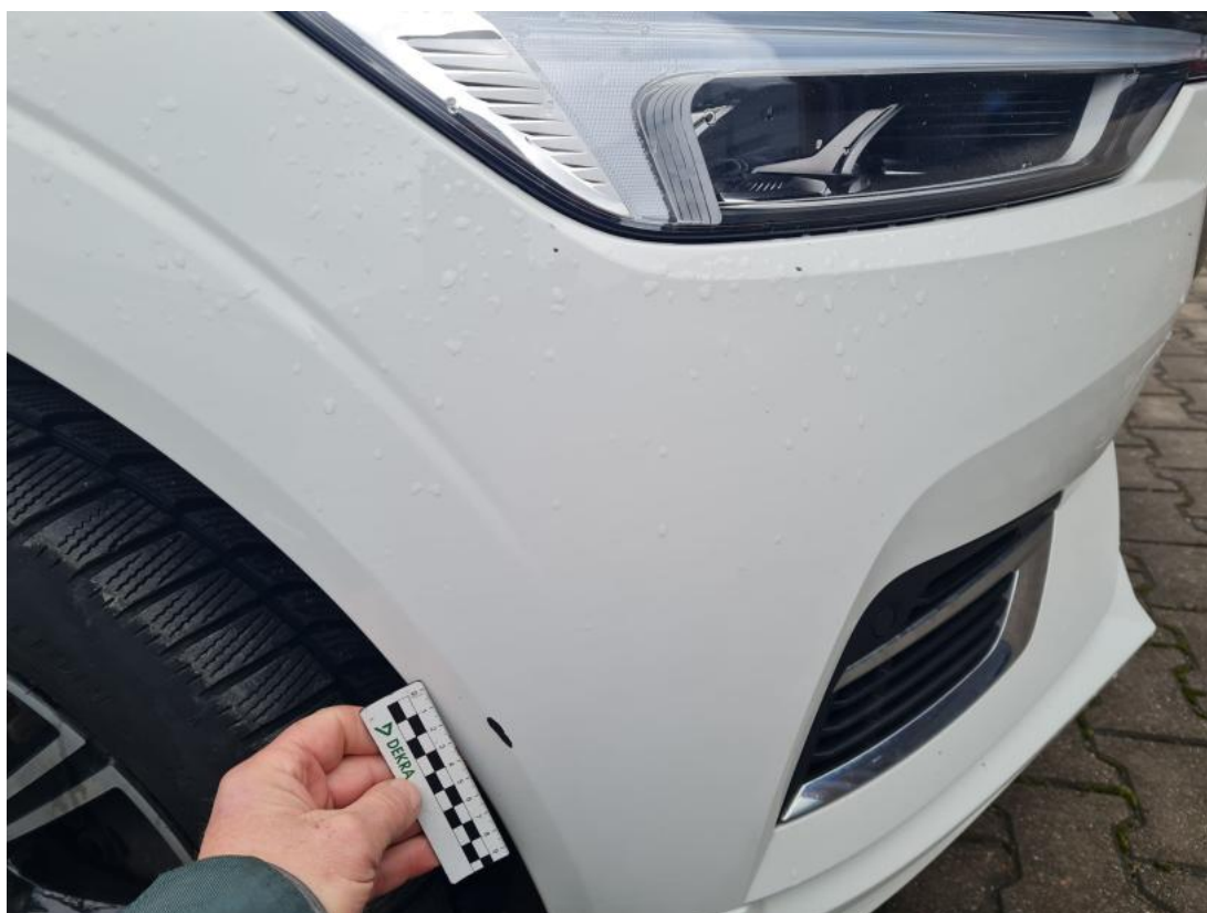
Fot. 47 Zderzak() - Rysa/odprysk 3
