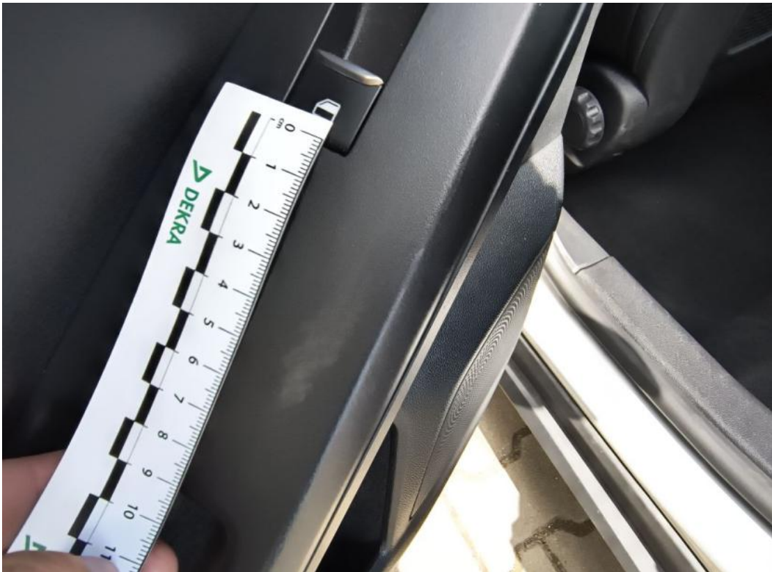
Fot. 45 Tapicerka drzwi tylnych L - Rysa/odprysk 1
