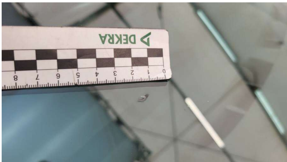
Fot. 32 Szyba czołowa - Pęknięcie/rozerwanie 1
