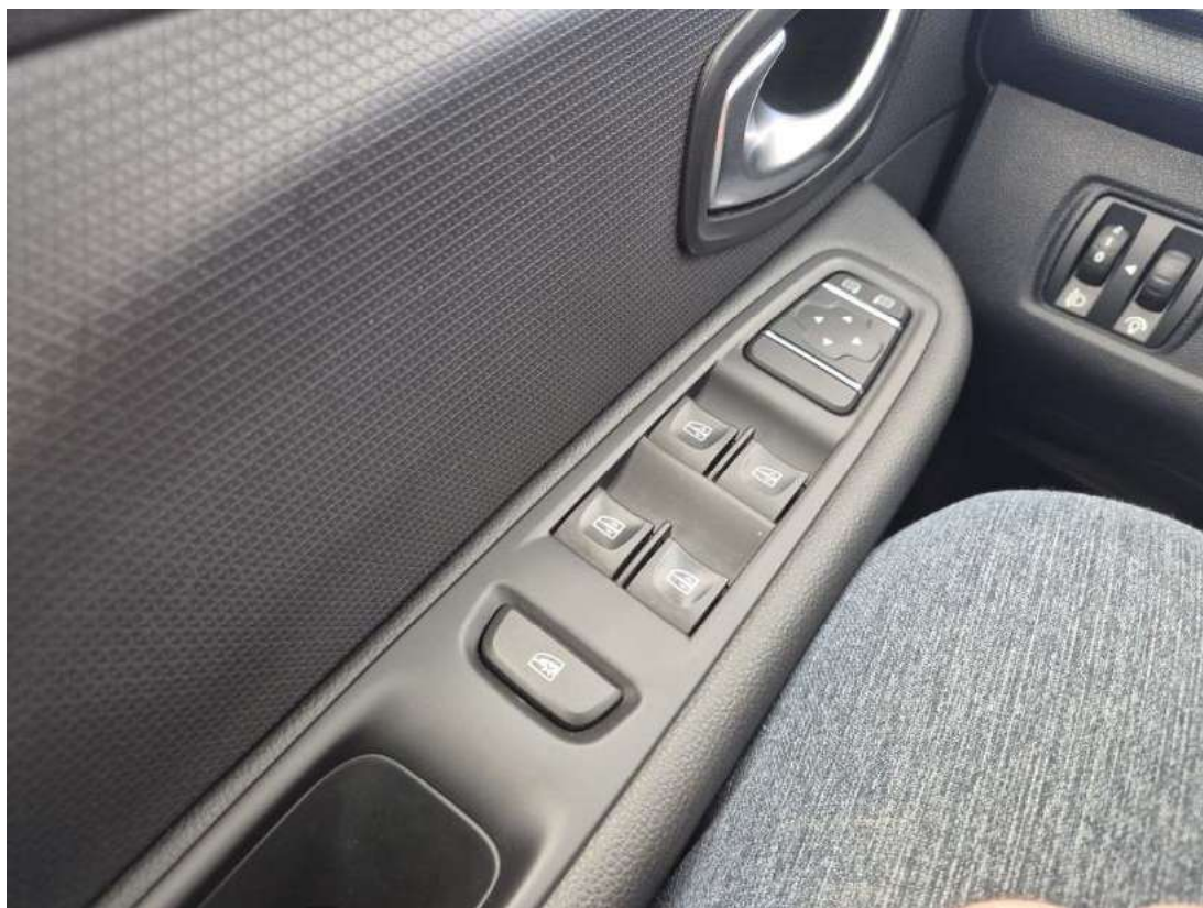
Fot. 35 Włączniki/przełączniki drzwi prz L - Inne 1
