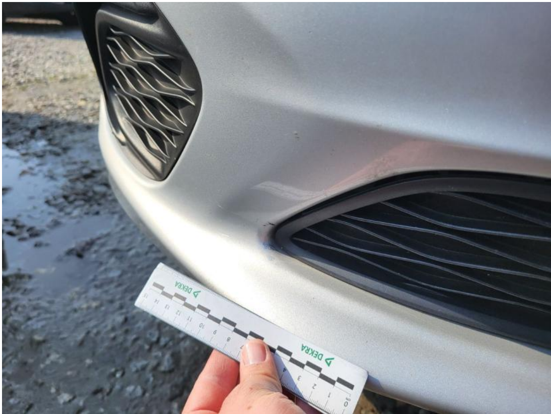
Fot. 37 Zderzak - Rysa/odprysk 2
