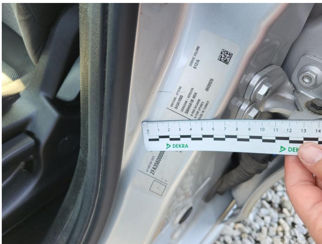
Fot. 44 Słupek środkowy L - Rysa/odprysk 1
