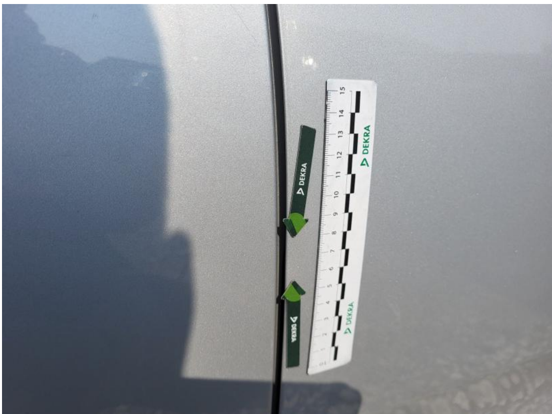
Fot. 38 Drzwi przednie P - Wgniecenie/odkształcenie 1
