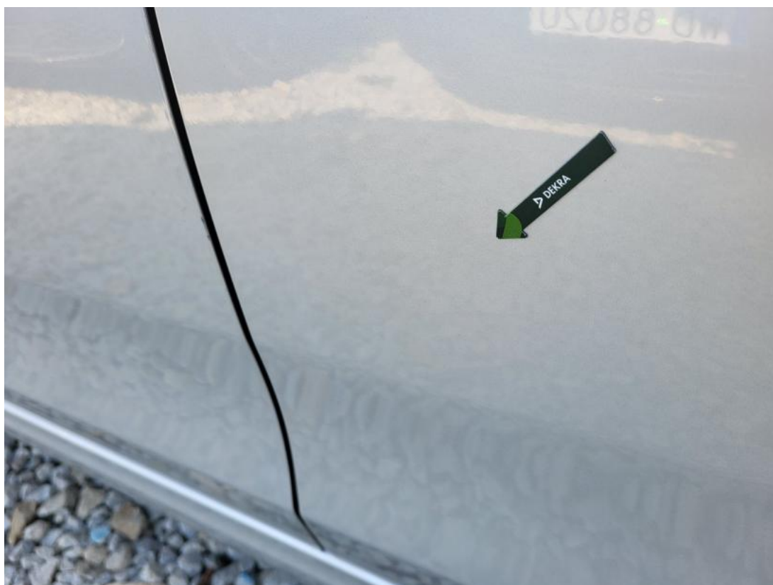
Fot. 43 Drzwi tylne L - Wgniecenie/odkształcenie 1
