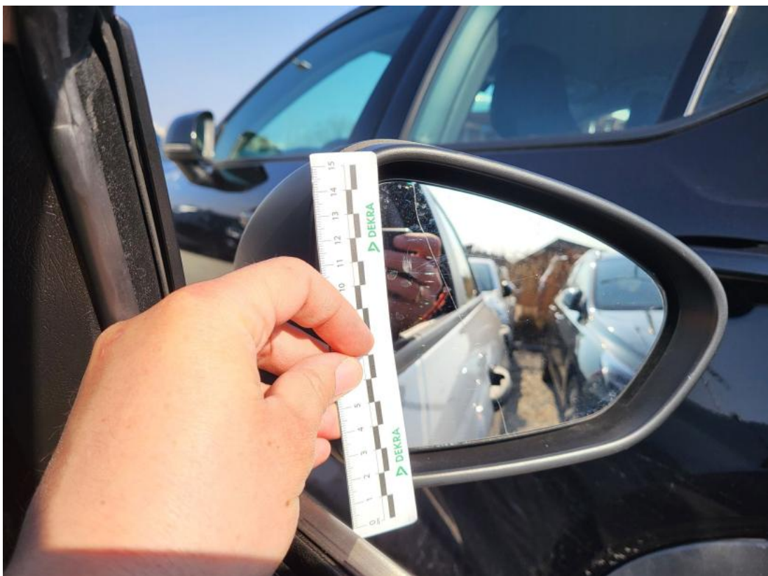
Fot. 40 Wkład lusterka zew P - Pęknięcie/rozerwanie 1
