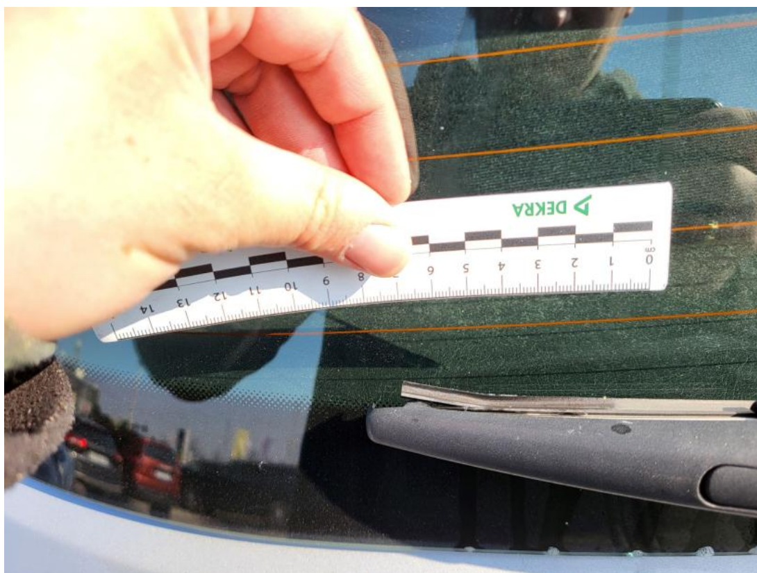
Fot. 41 Pióro wycieraczki szyby tyl - Pęknięcie/rozerwanie 1
