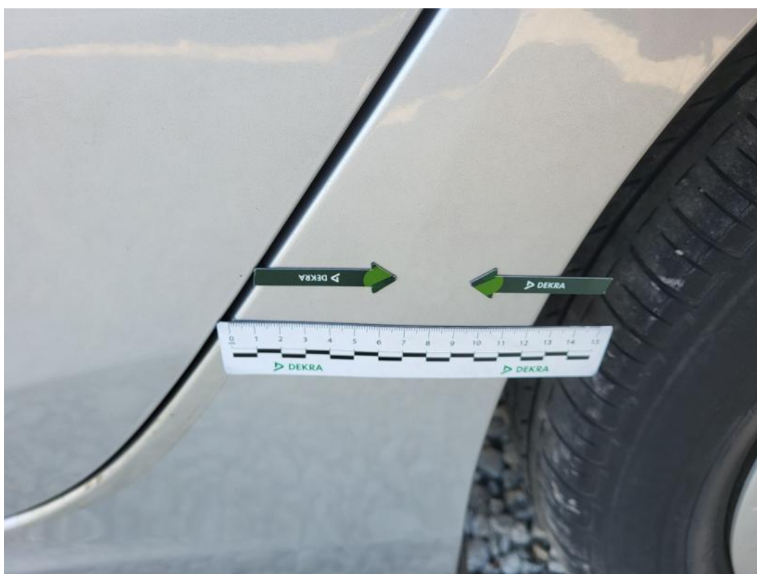
Fot. 42 Błotnik tylny L / Ściana boczna L - Wgniecenie/odkształcenie 1
