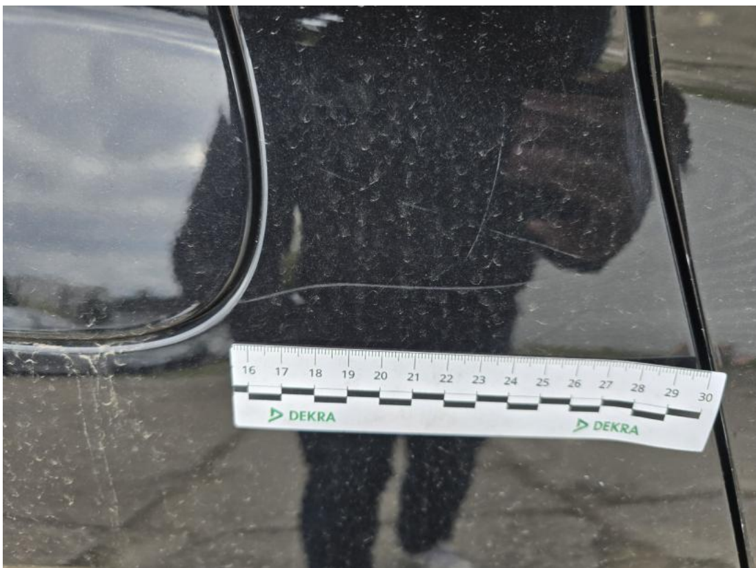
Fot. 54 Błotnik tylny P / Ściana boczna P - Rysa/odprysk 1
