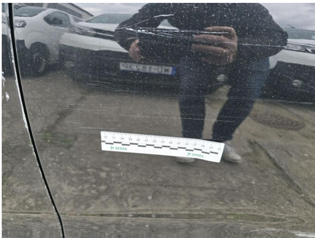
Fot. 72 Drzwi tylne L - Rysa/odprysk 2
