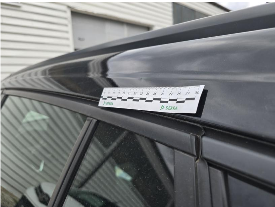
Fot. 64 Rama dachu L - Wgniecenie/odkształcenie 1
