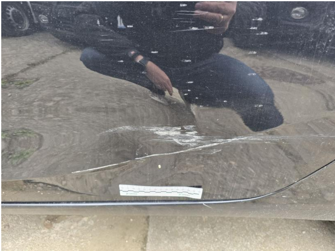
Fot. 73 Drzwi tylne L() - Rysa/odprysk 3
