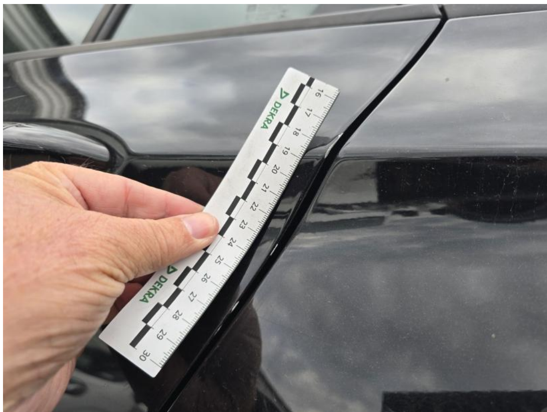
Fot. 71 Drzwi tylne L - Rysa/odprysk 1
