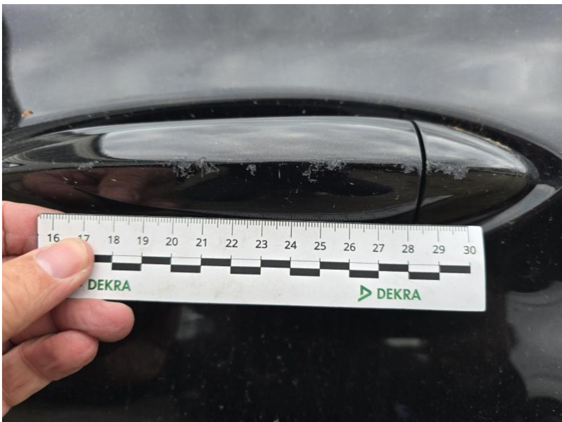
Fot. 74 Klamka drzwi prz L - Rysa/odprysk 1
