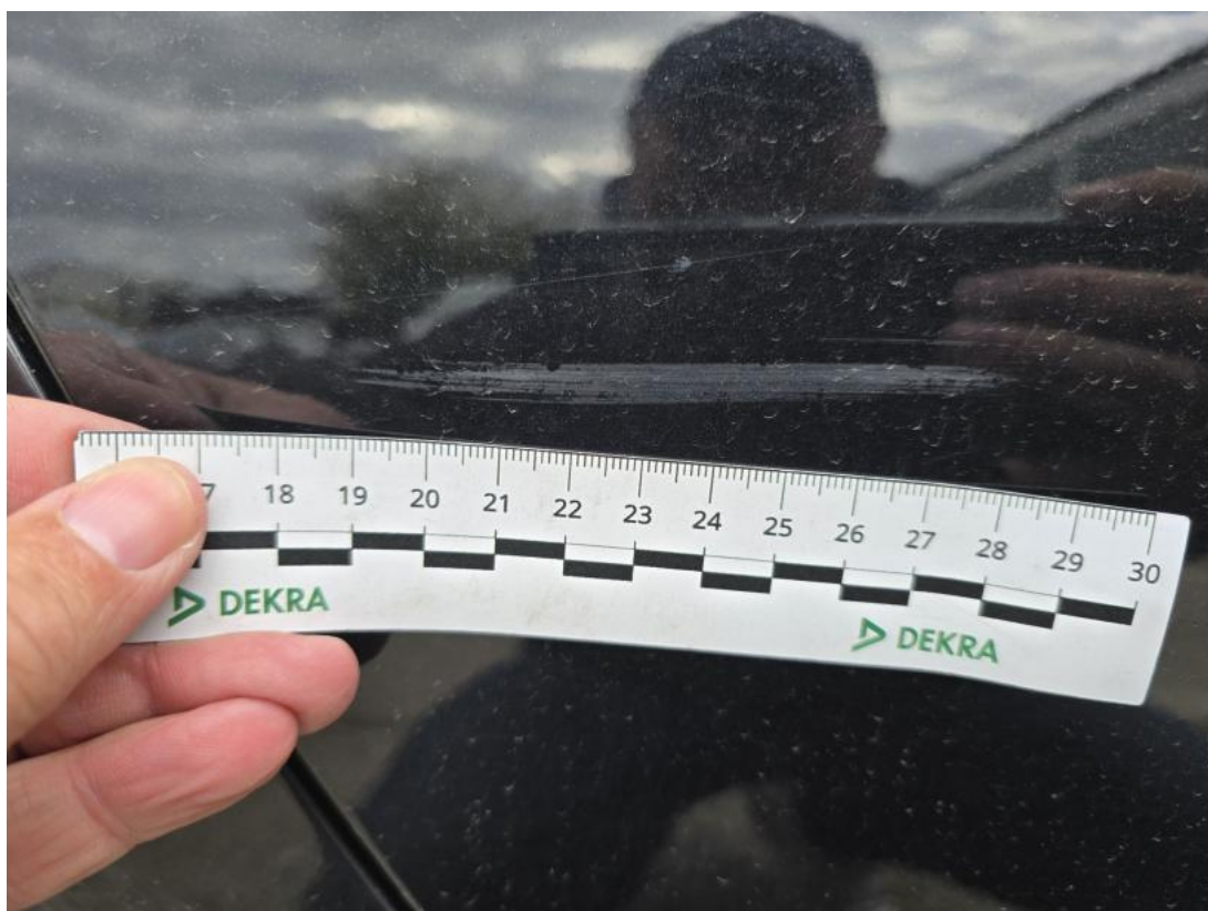
Fot. 51 Drzwi tylne P - Rysa/odprysk 2
