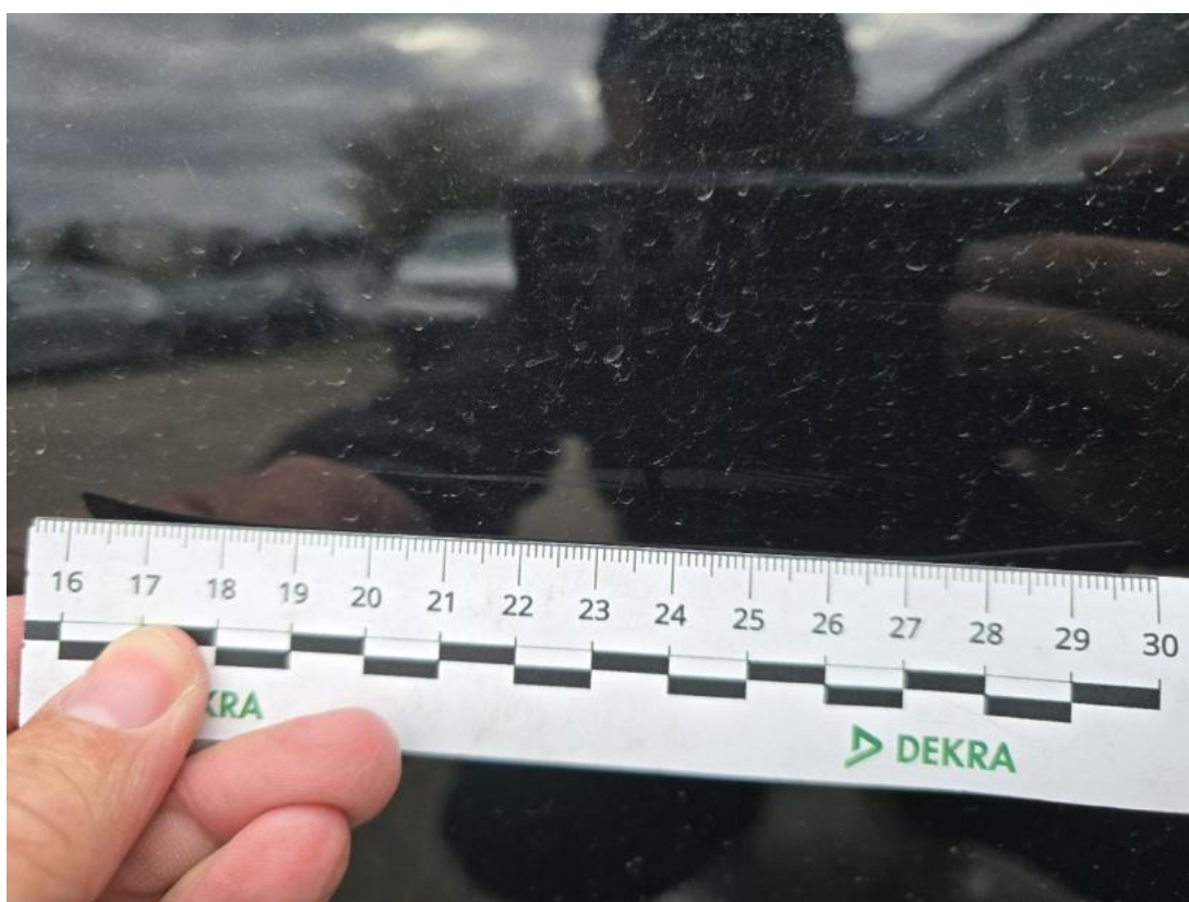
Fot. 52 Drzwi tylne P() - Rysa/odprysk 3
