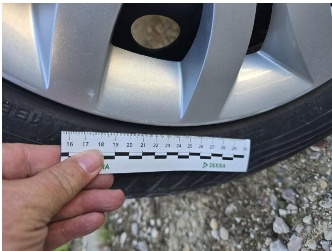
Fot. 36 Kołpak tylny P - Rysa/odprysk 1
