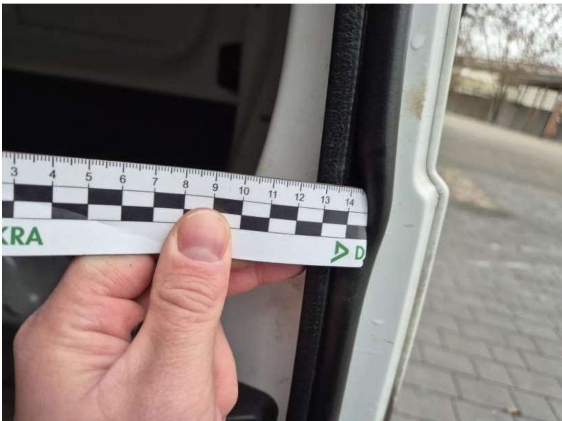
Fot. 58 Uszczelka drzwi tylnych P - Pęknięcie/rozerwanie 1
