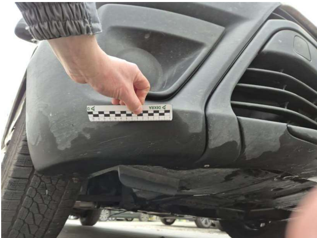
Fot. 38 Zderzak przedni cz dolna - Rysa/odprysk 2
