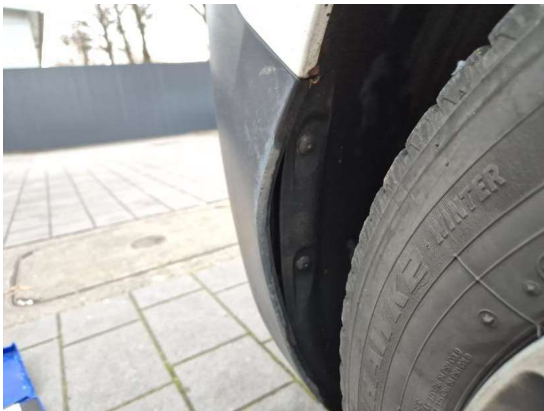
Fot. 39 Zderzak przedni cz dolna - Wgniecenie/odkształcenie 1
