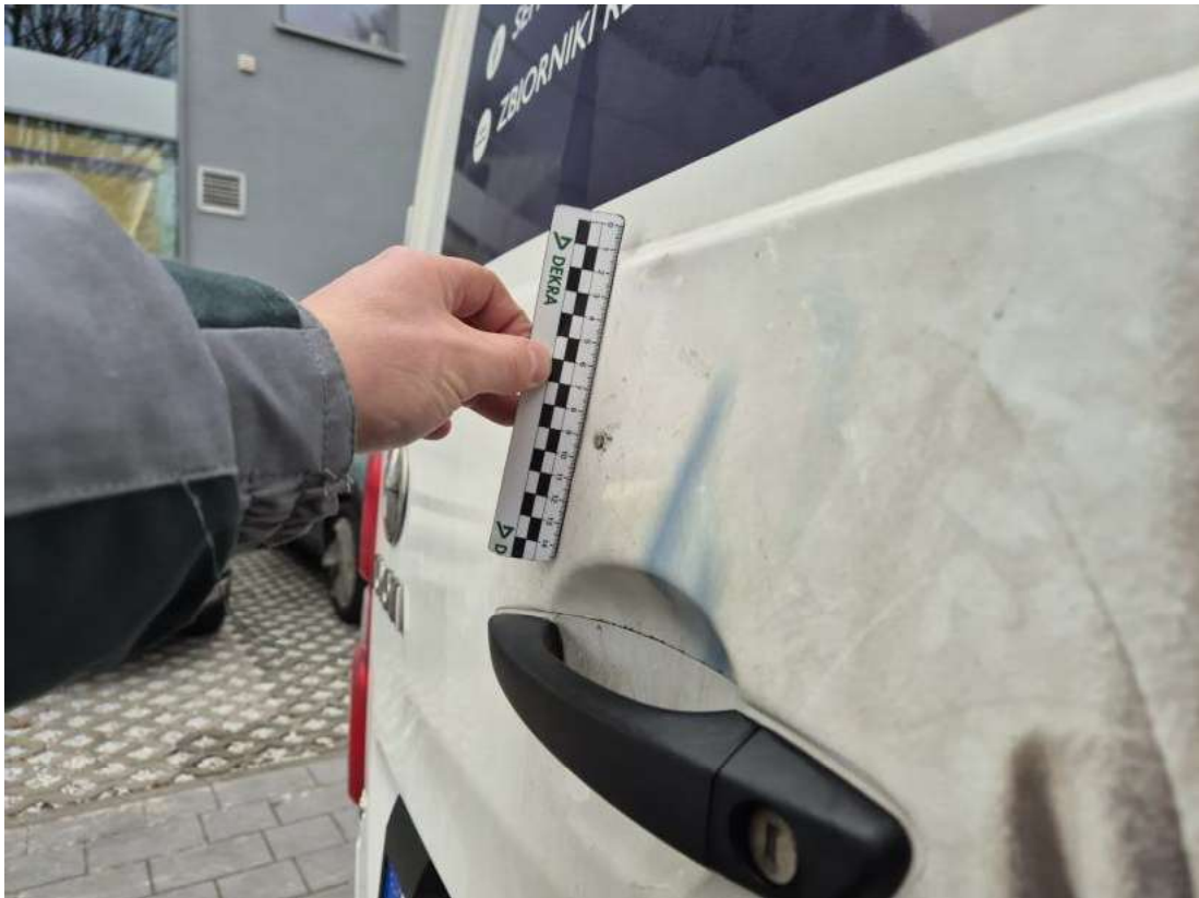
Fot. 59 Drzwi tyłu lewe - Wgniecenie/odkształcenie 1
