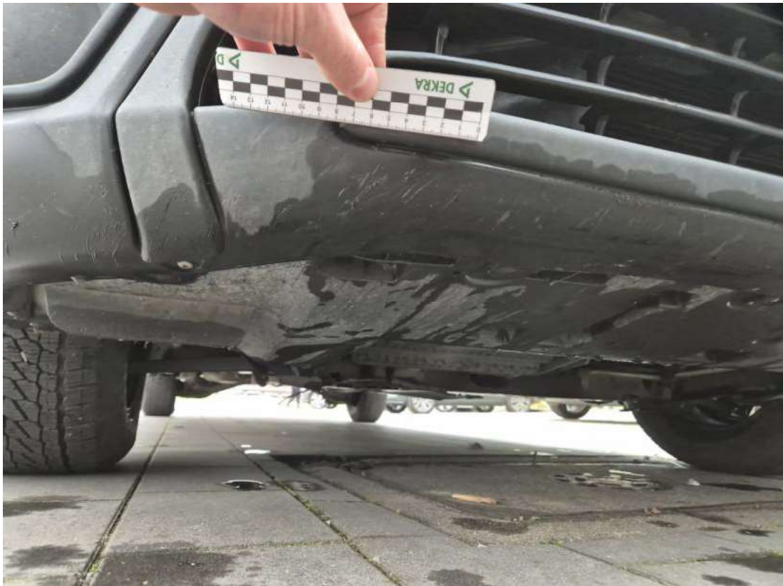
Fot. 37 Zderzak przedni cz dolna - Rysa/odprysk 1
