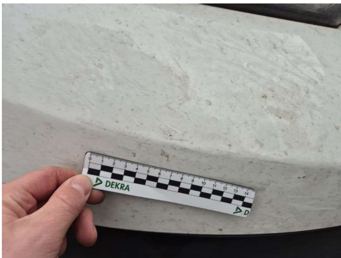
Fot. 36 Zderzak - Rysa/odprysk 1
