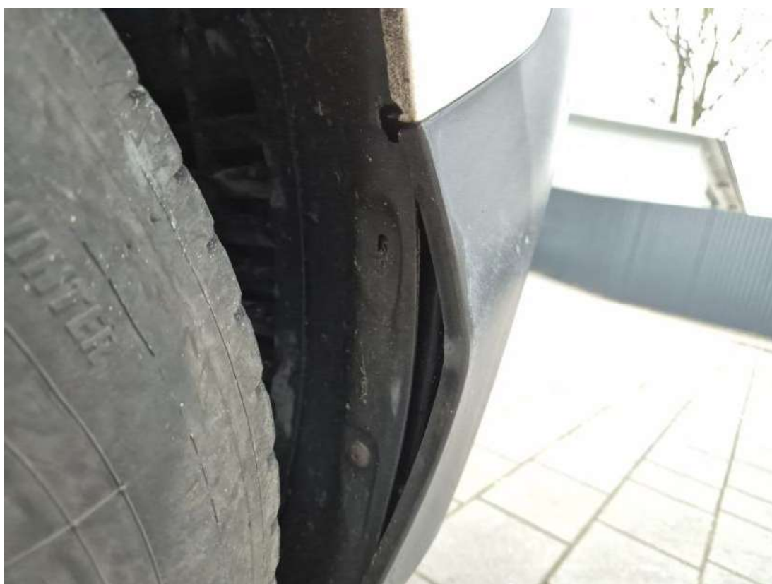
Fot. 40 Zderzak przedni cz dolna - Wgniecenie/odkształcenie 2
