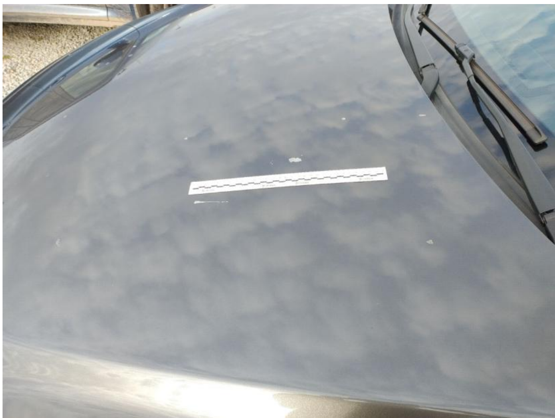
Fot. 37 zabrudzenia powłoki lakierniczej
