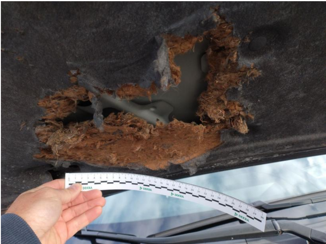
Fot. 43 Wykładzina pokrywy komory silnika - Pęknięcie/rozerwanie 1
