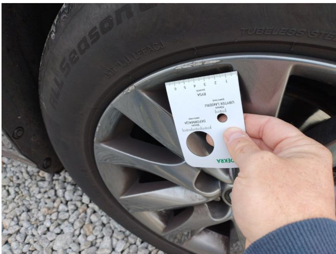
Fot. 46 Felga aluminiowa przednia P - Rysa/odprysk 1
