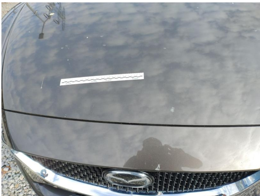
Fot. 36 zabrudzenia powłoki lakierniczej
