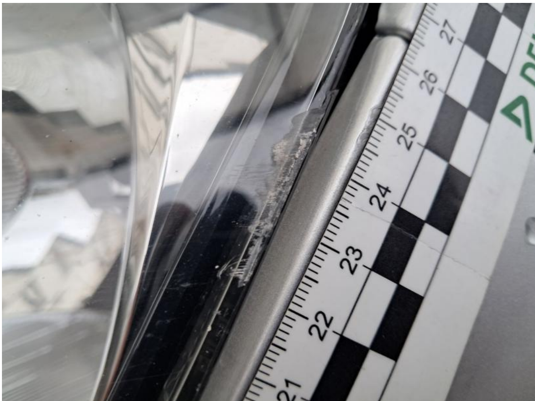
Fot. 60 Reflektor L - Rysa/odprysk 1
