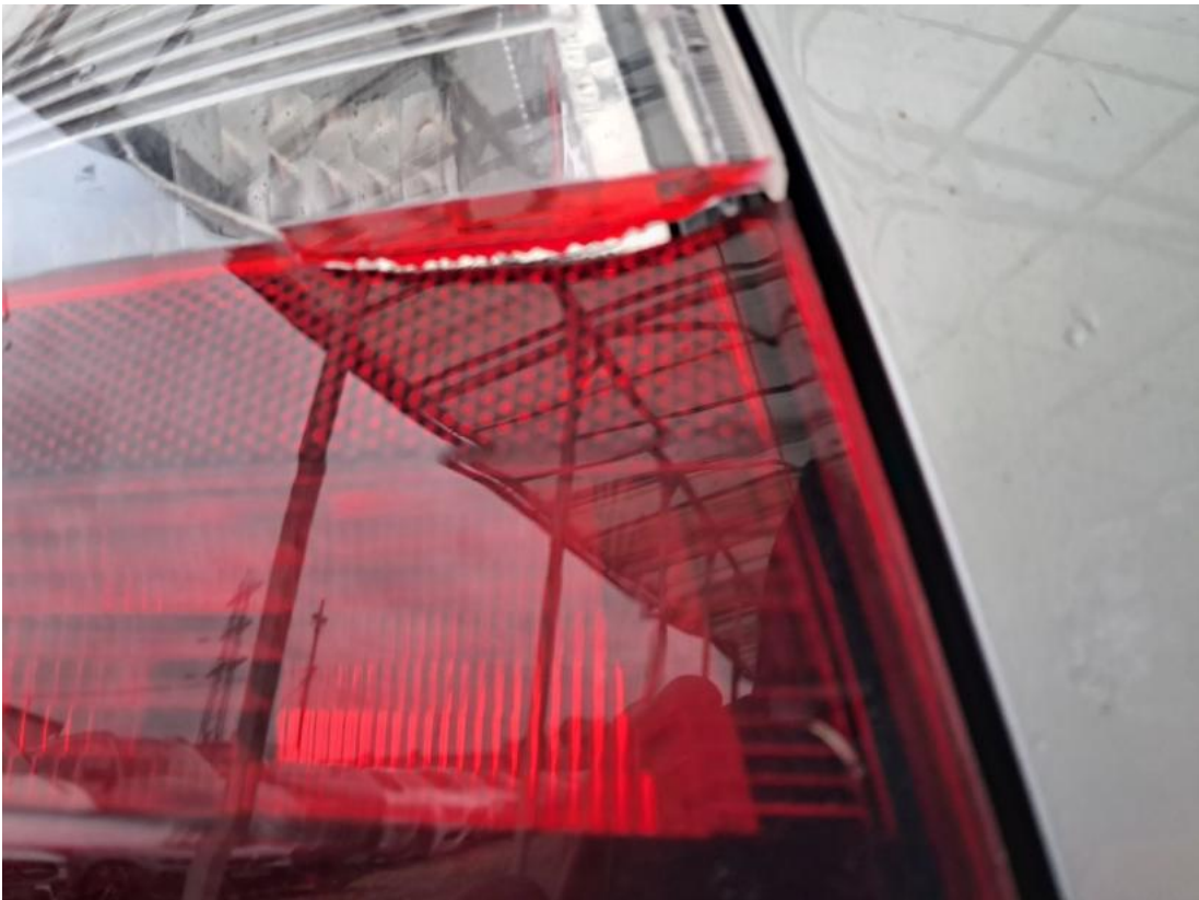
Fot. 57 Lampa zespolona tylna L - Pęknięcie/rozerwanie 2
