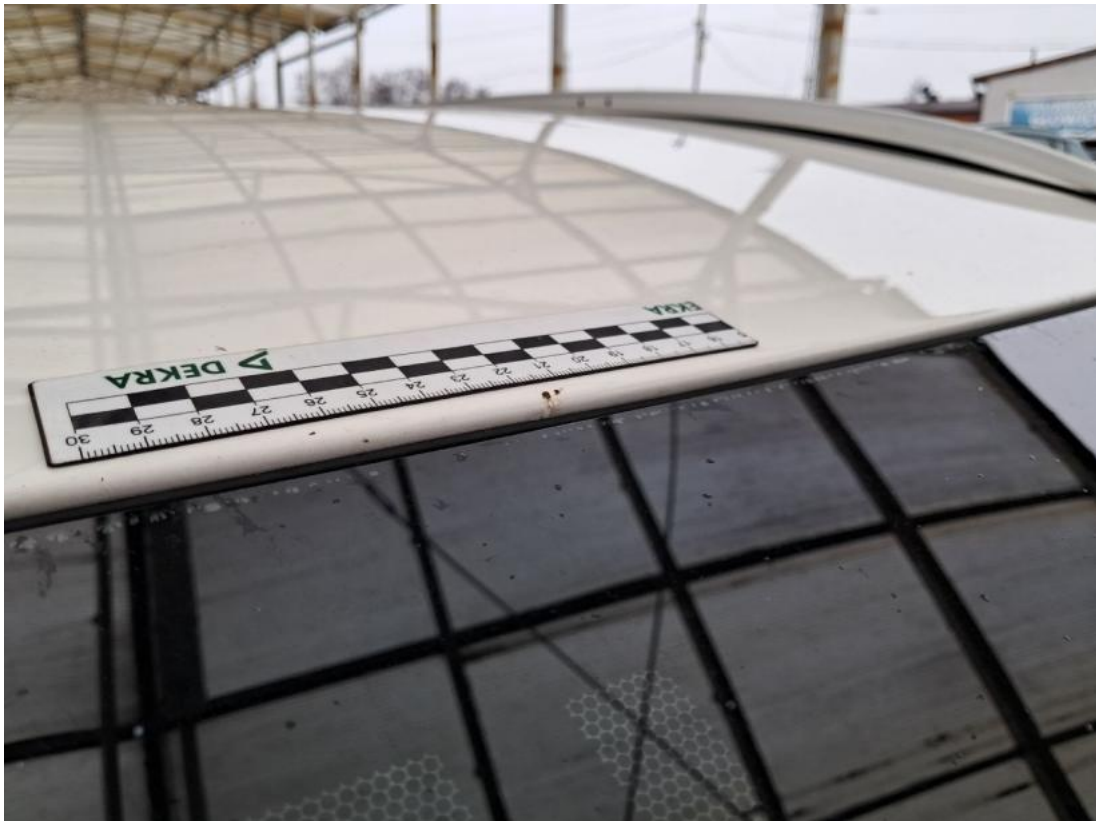
Fot. 49 Dach - Rysa/odprysk 2
