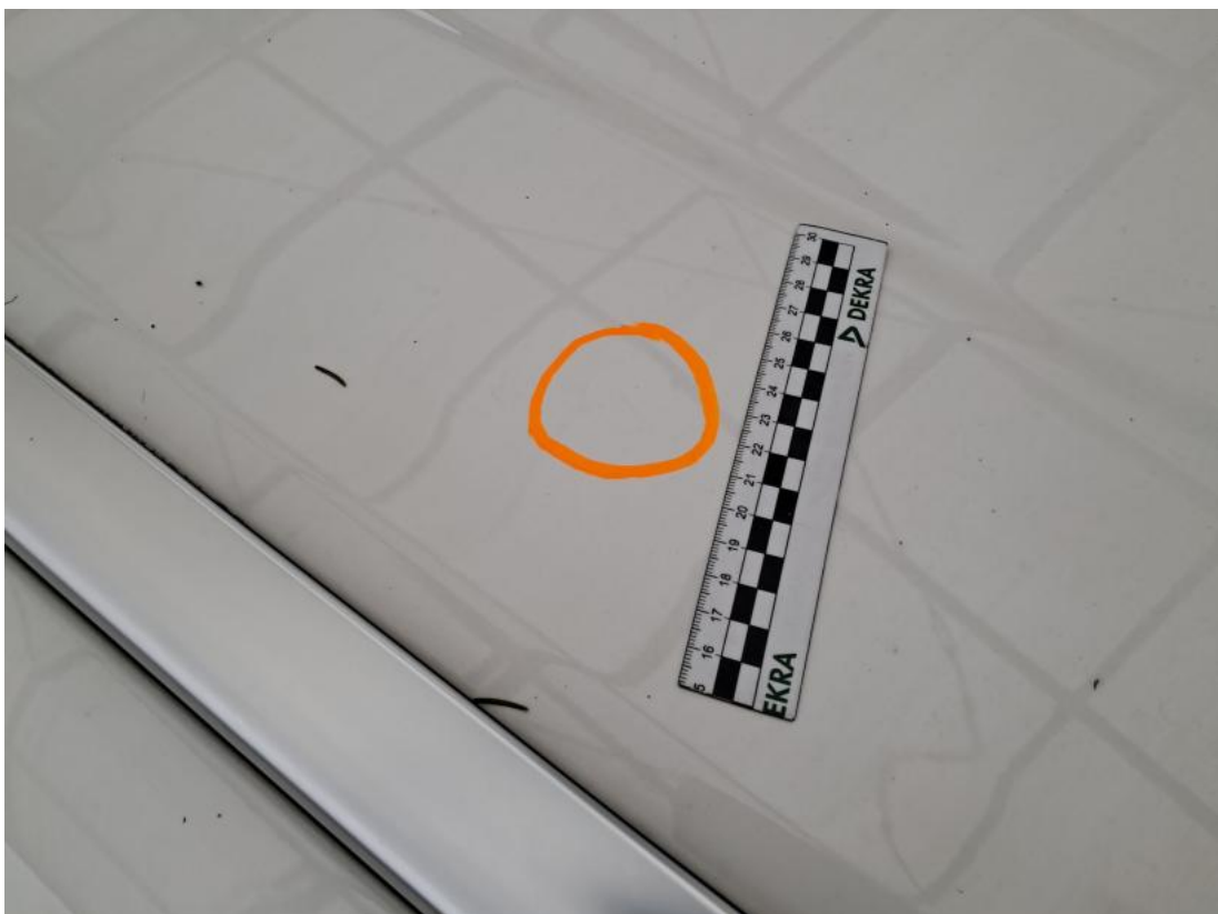
Fot. 50 Dach - Wgniecenie/odkształcenie 1
