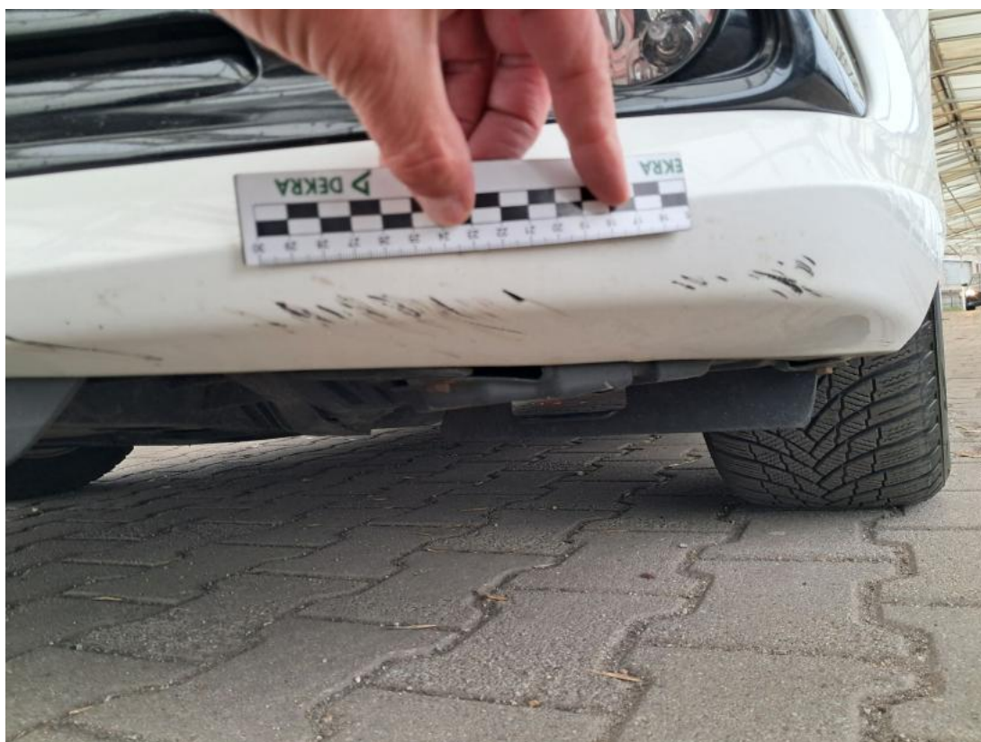
Fot. 41 Zderzak - Rysa/odprysk 1
