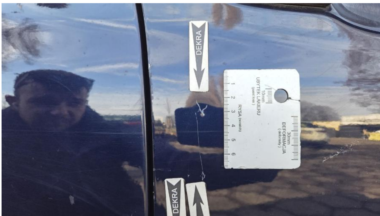
Fot. 44 Drzwi przednie P - Rysa/odprysk 1
