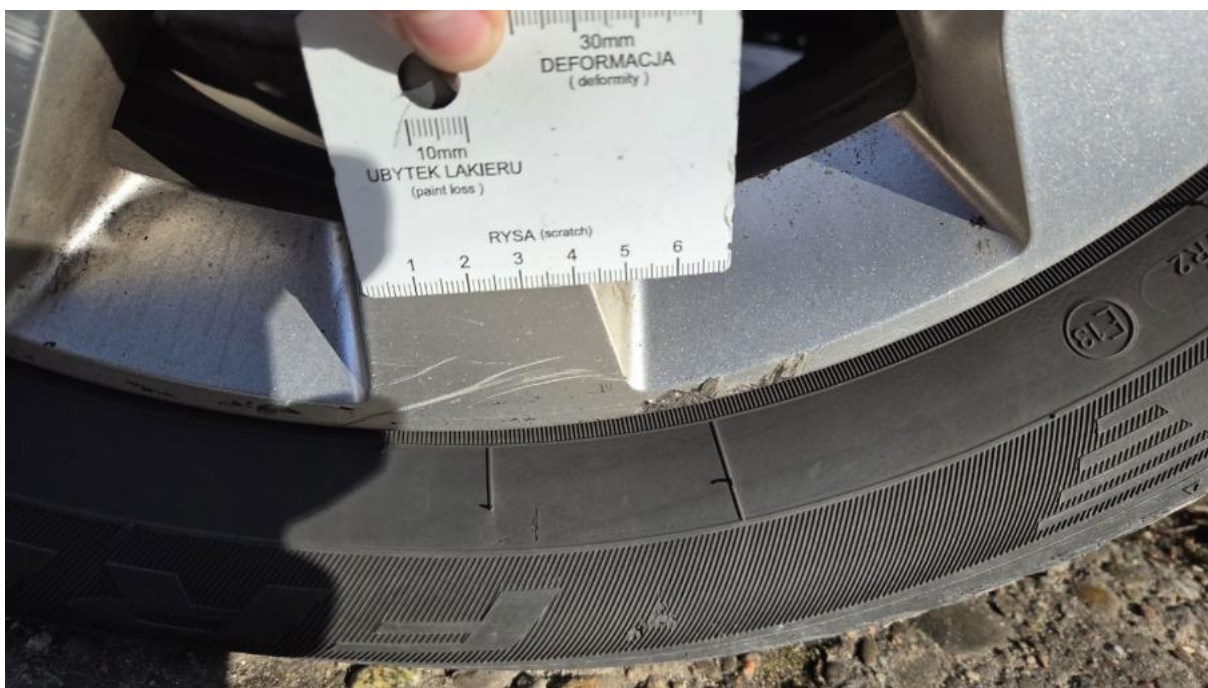
Fot. 81 Felga Aluminiowa przednia L - Rysa/odprysk 1
