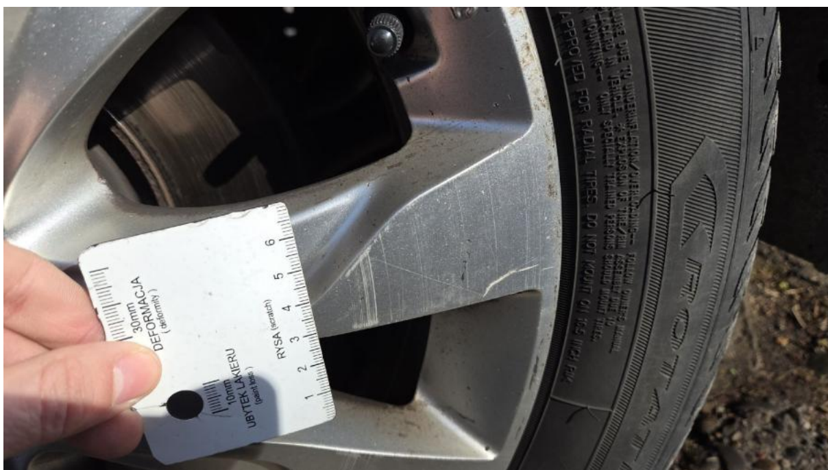
Fot. 82 Felga Aluminiowa przednia L - Rysa/odprysk 2
