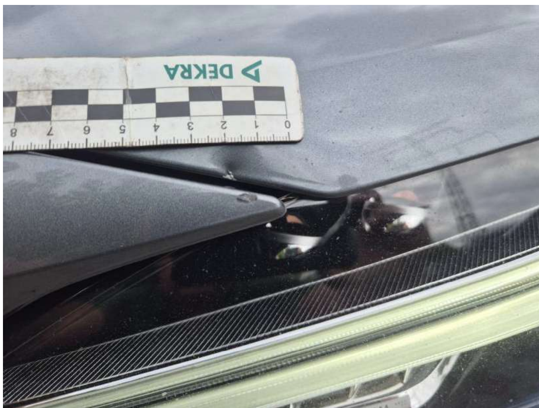
Fot. 41 Zderzak przedni cz górna - Rysa/odprysk 1
