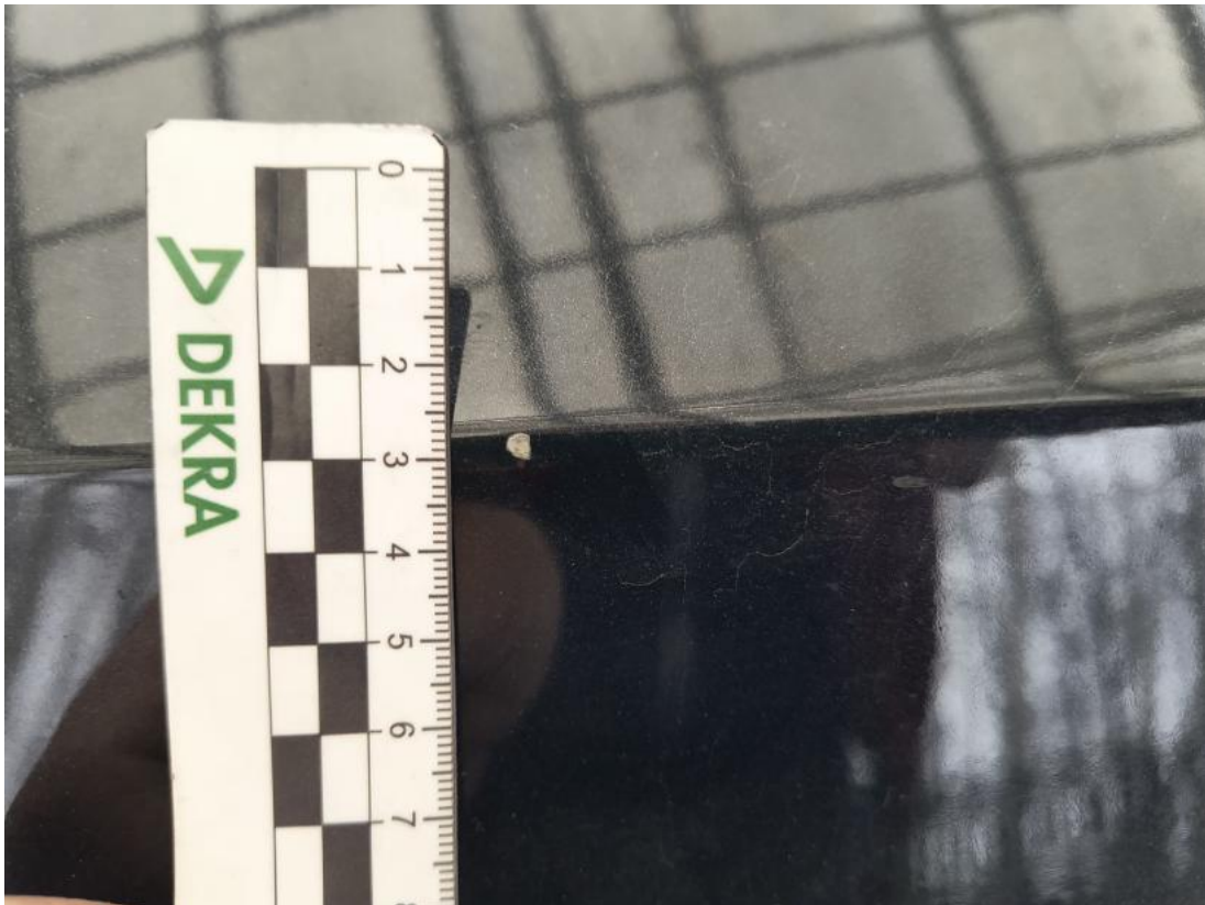
Fot. 37 Pokrywa komory silnika - Rysa/odprysk 1
