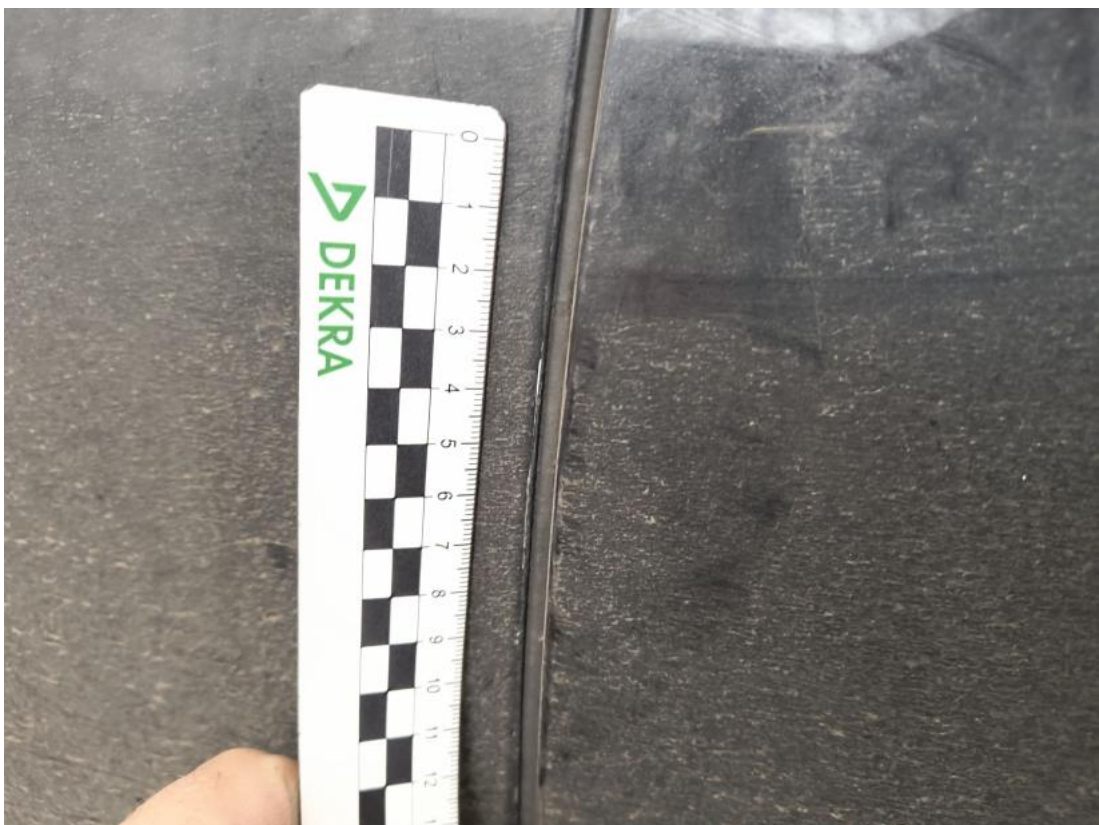
Fot. 48 Drzwi przed L - Rysa/odprysk 1
