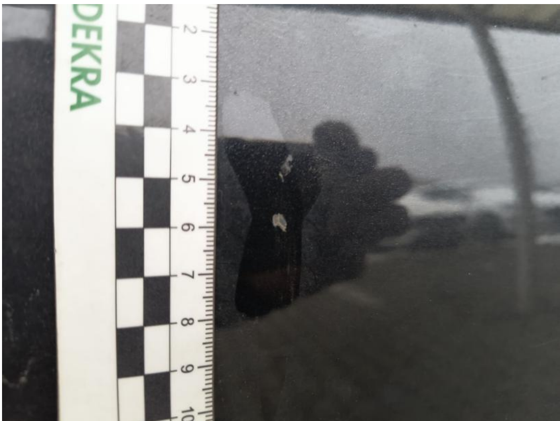
Fot. 44 Drzwi tylne P - Rysa/odprysk 1
