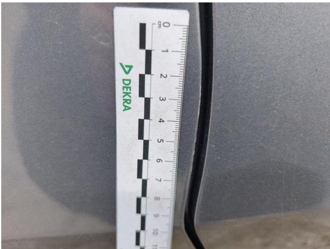
Fot. 60 Drzwi przed L - Rysa/odprysk 1
