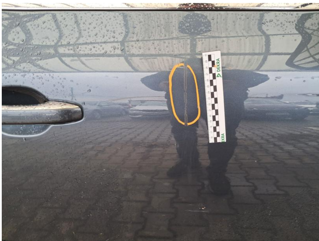
Fot. 47 Drzwi przednie P - Wgniecenie/odkształcenie 1
