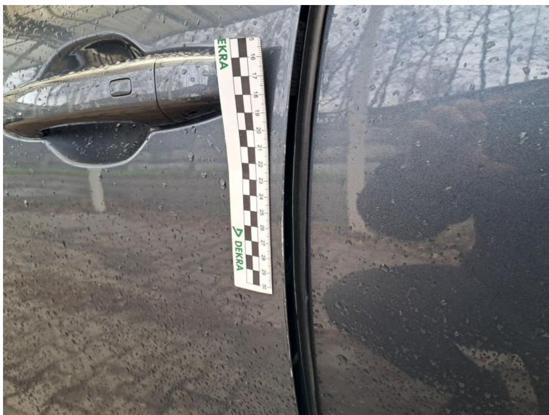
Fot. 48 Drzwi przed L - Rysa/odprysk 1
