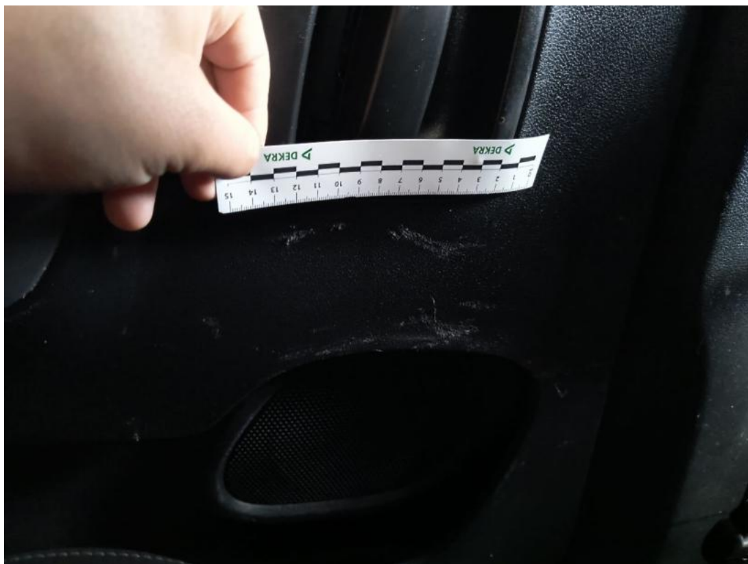
Fot. 73 Tapicerka drzwi tylnych L - Rysa/odprysk 1
