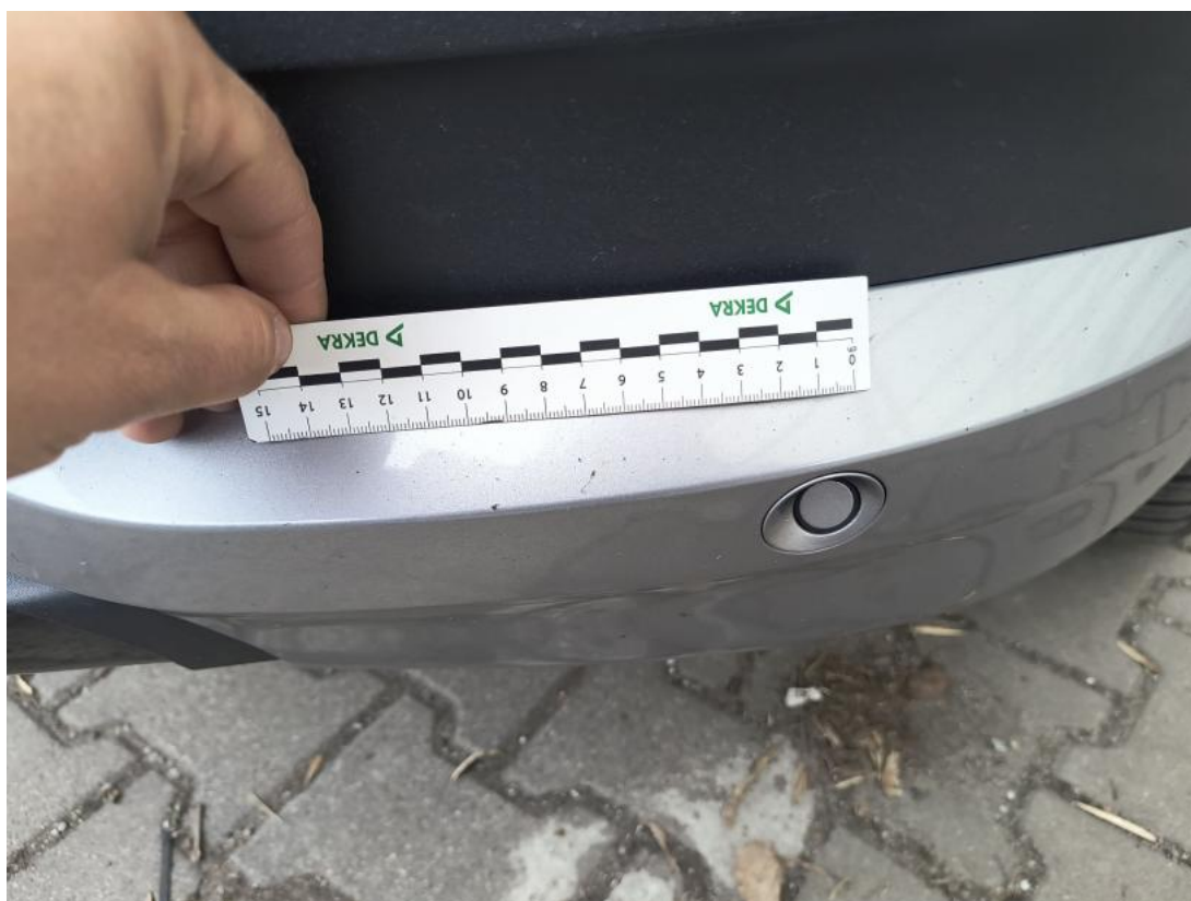
Fot. 43 Zderzak - Rysa/odprysk 1
