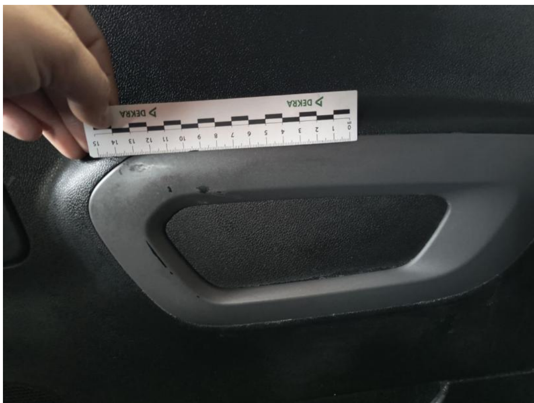
Fot. 74 Tapicerka drzwi tylnych P - Rysa/odprysk 1
