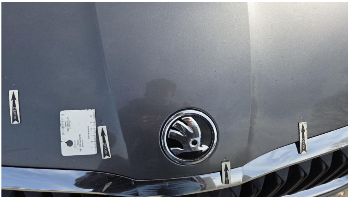
Fot. 30 Pokrywa komory silnika - Rysa/odprysk 1
