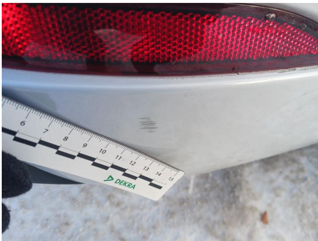
Fot. 45 Zderzak tylny cz P - Rysa/odprysk 1
