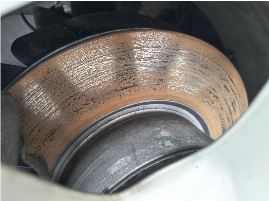
Fot. 29 Tarcza hamulcowa przednia prawa
