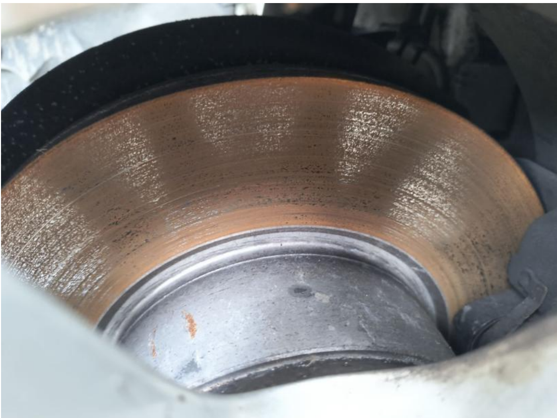
Fot. 28 Tarcza hamulcowa przednia lewa
