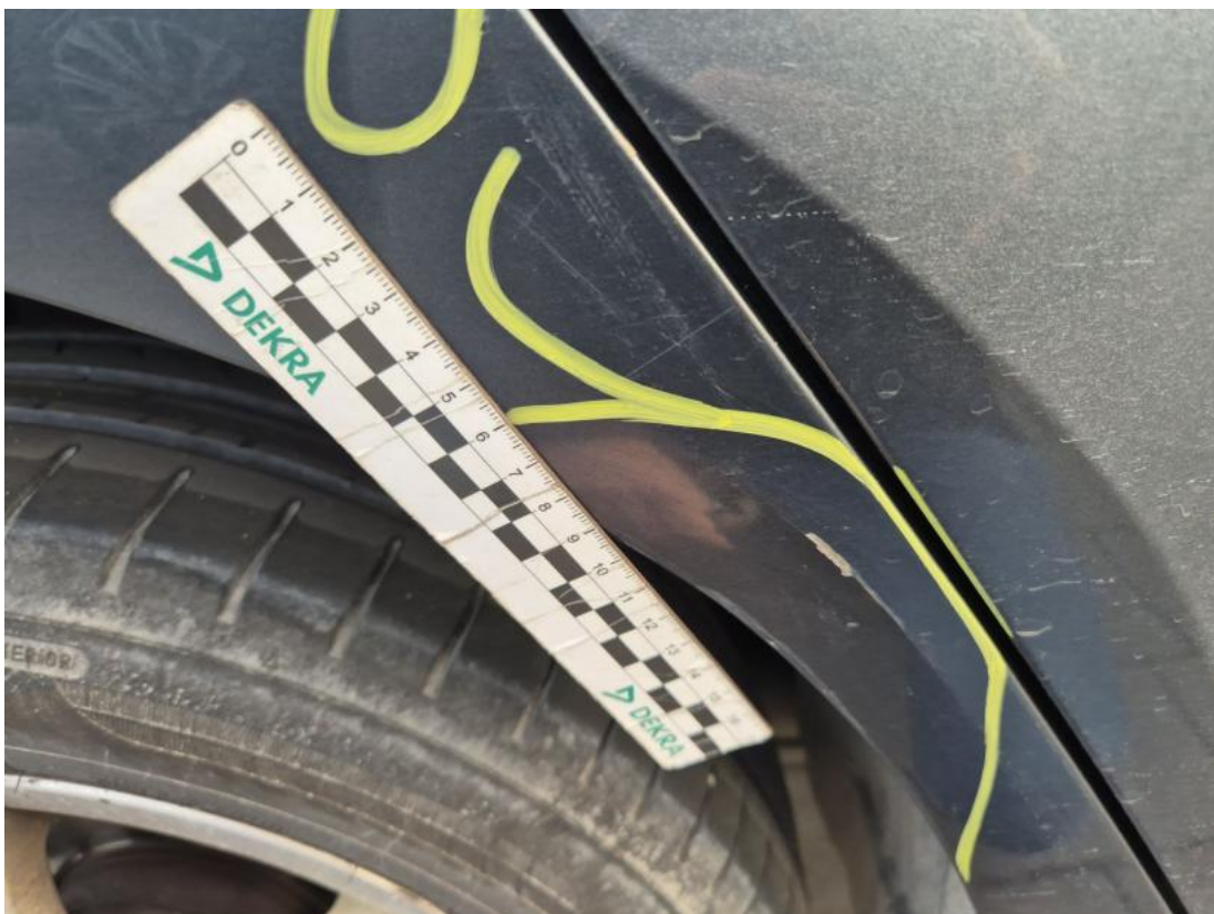
Fot. 36 Błotnik tylny P / Ściana boczna P - Rysa/odprysk 1
