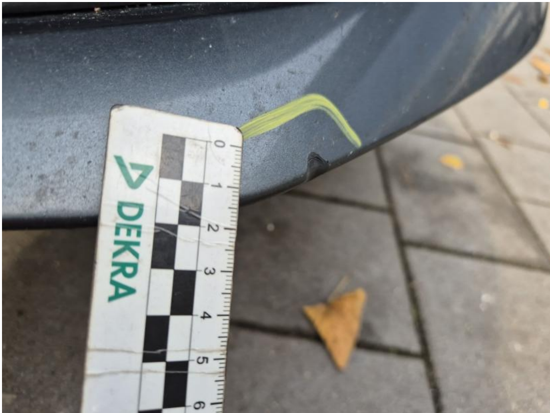
Fot. 35 Zderzak - Wgniecenie/odkształcenie 1
