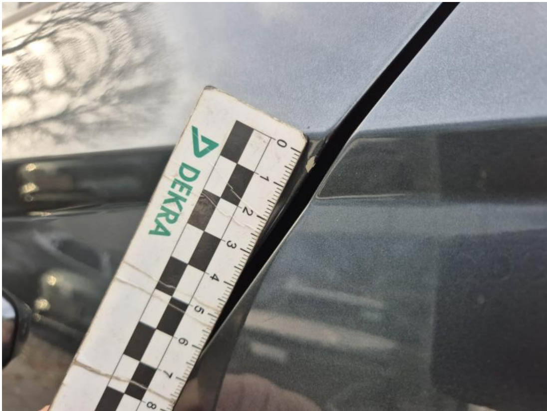
Fot. 45 Drzwi tylne L - Rysa/odprysk 1
