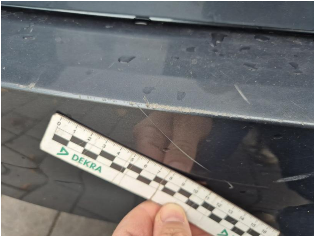
Fot. 39 Zderzak tylny - Rysa/odprysk 1
