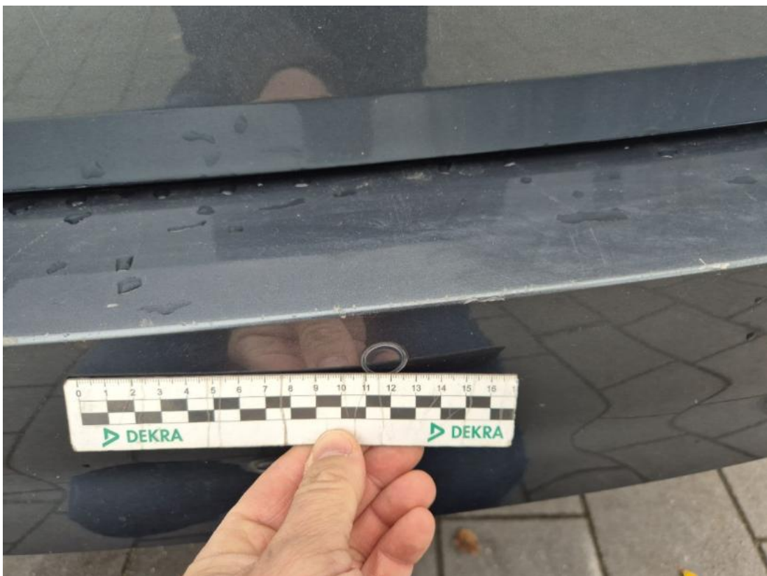
Fot. 40 Zderzak tylny - Rysa/odprysk 2
