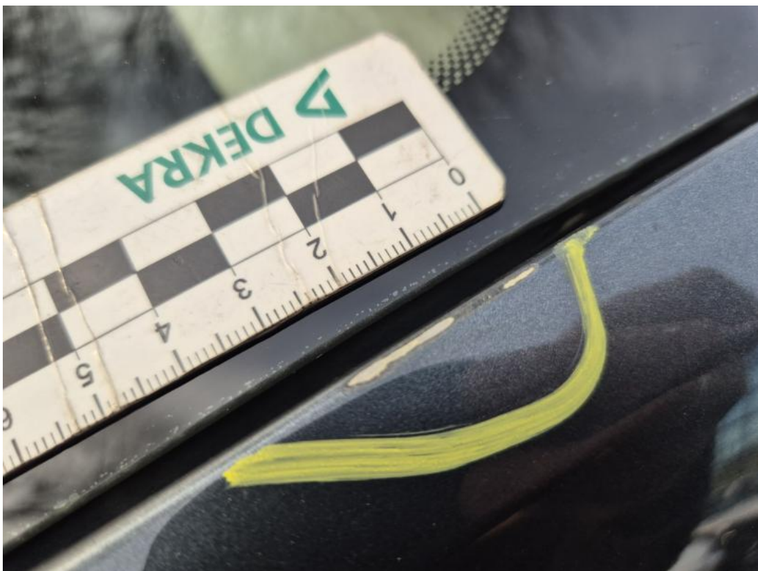
Fot. 46 Słupek przedni L - Rysa/odprysk 1
