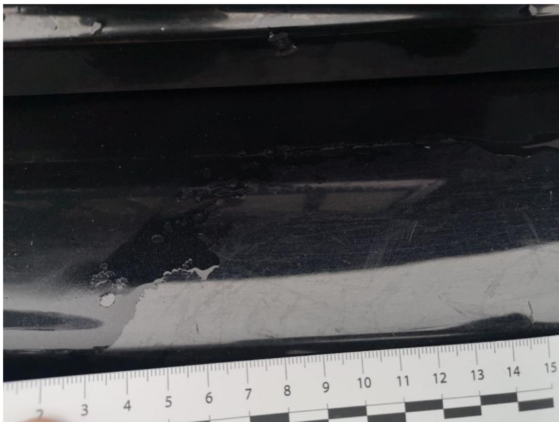
Fot. 69 Zderzak tylny - Rysa/odprysk 2
