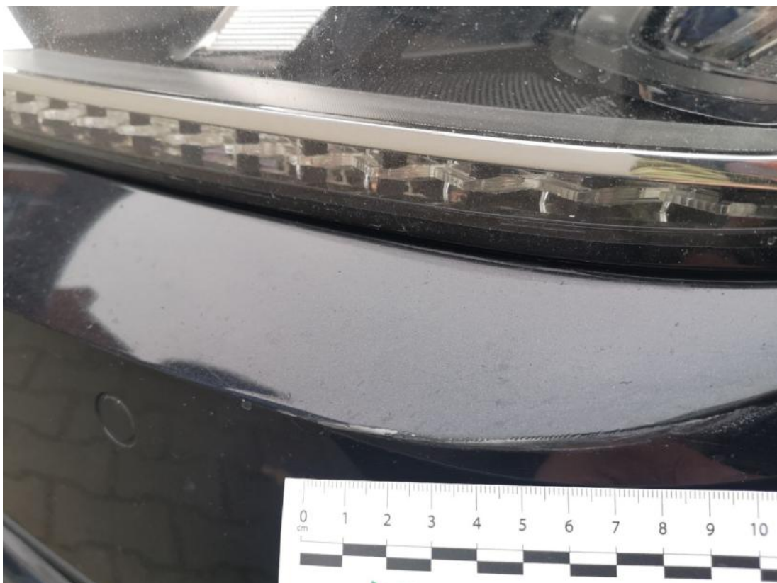
Fot. 48 Zderzak - Rysa/odprysk 1
