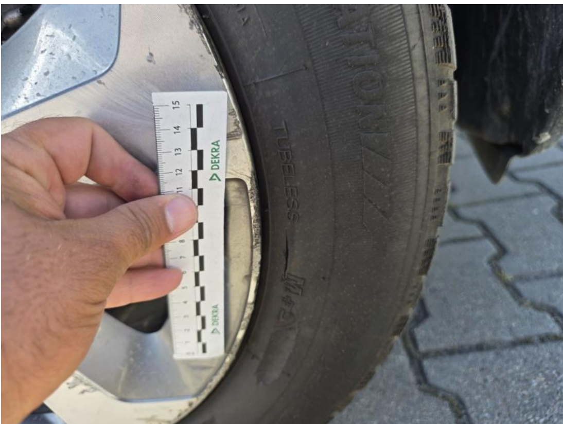
Fot. 54 Opona przednia P - Pęknięcie/rozerwanie 1
