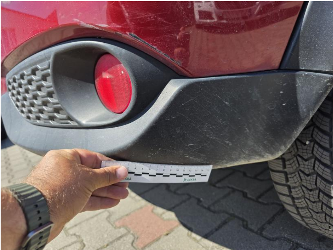
Fot. 67 Spojler zderzaka tylnego - Rysa/odprysk 1
