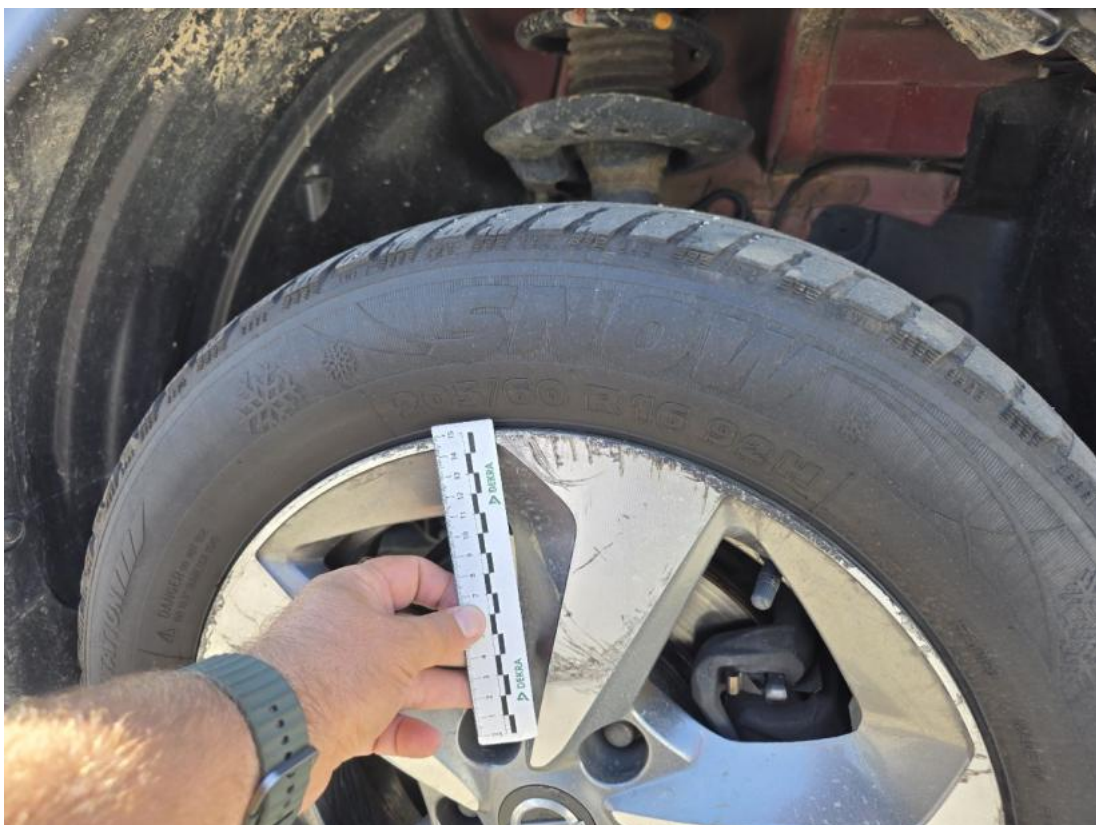
Fot. 44 Felga aluminiowa przednia P - Rysa/odprysk 1
