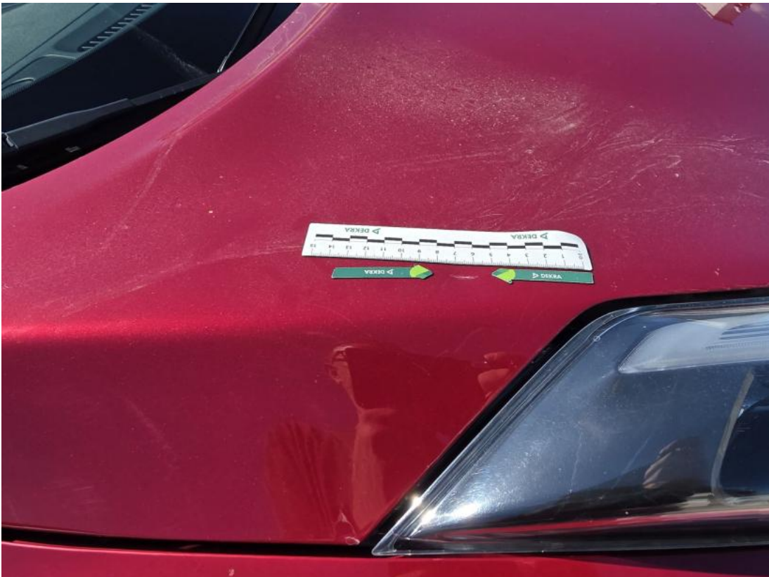
Fot. 37 Pokrywa komory silnika - Wgniecenie/odkształcenie 1
