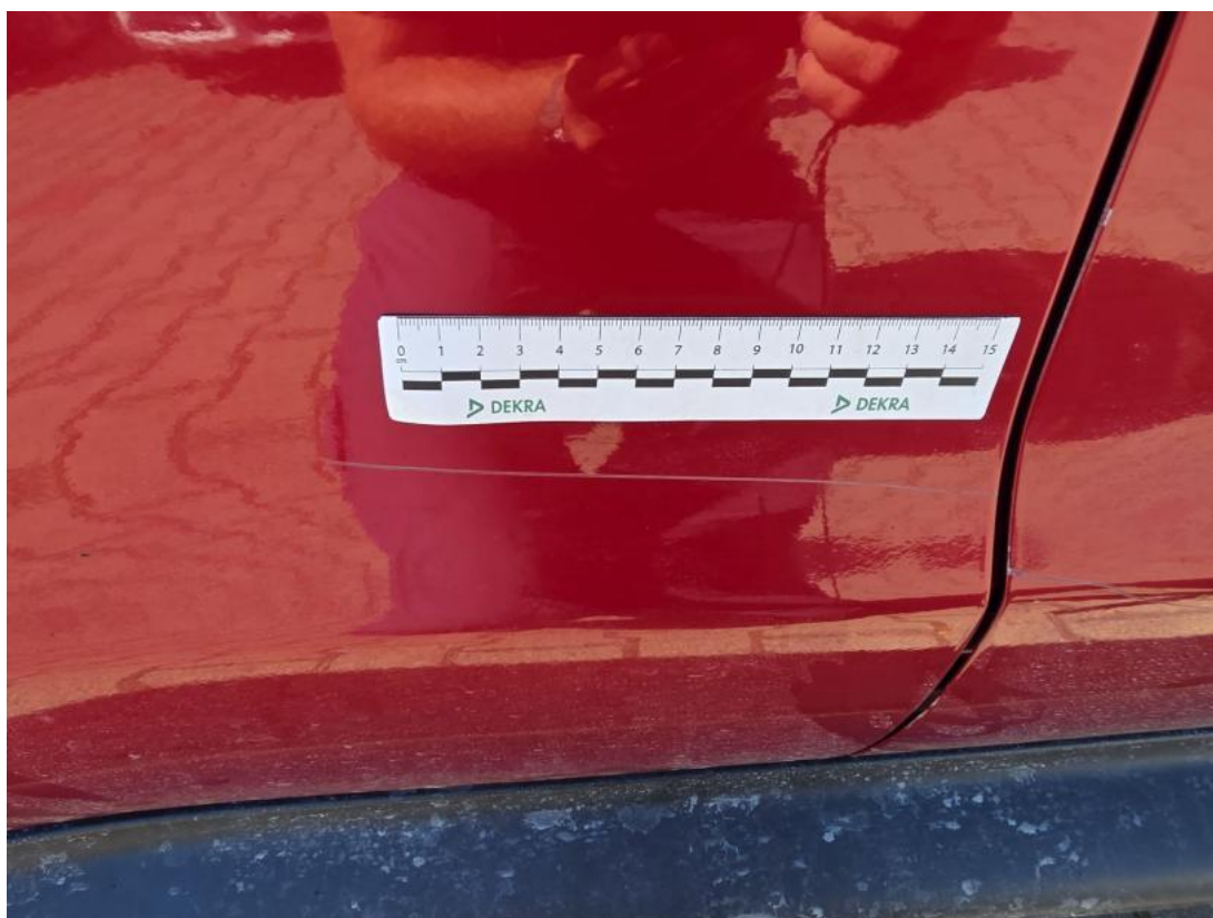
Fot. 63 Drzwi tylne P - Rysa/odprysk 1
