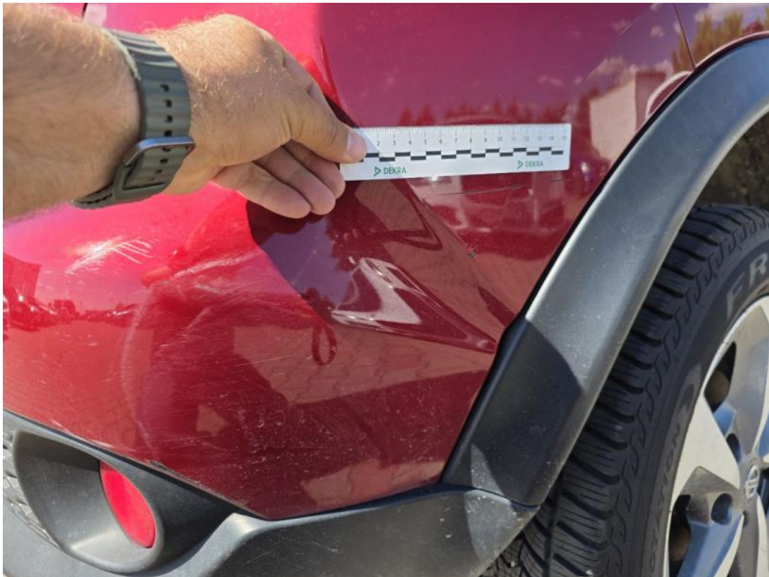
Fot. 71 Zderzak tylny - Rysa/odprysk 2
