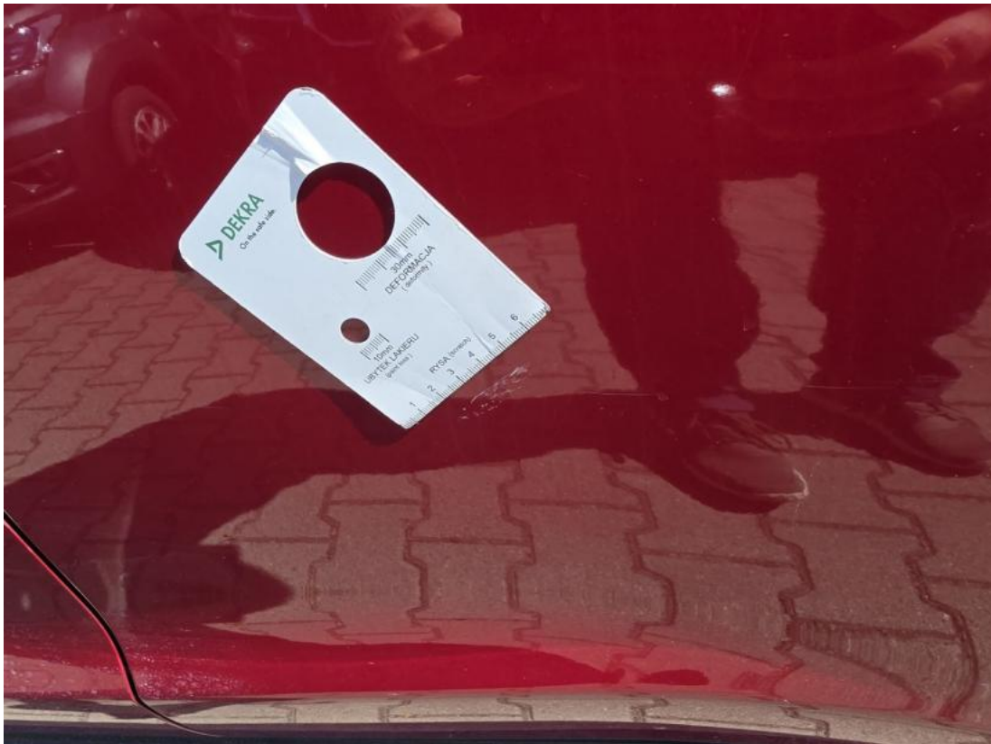
Fot. 81 Drzwi tylne L - Rysa/odprysk 2
