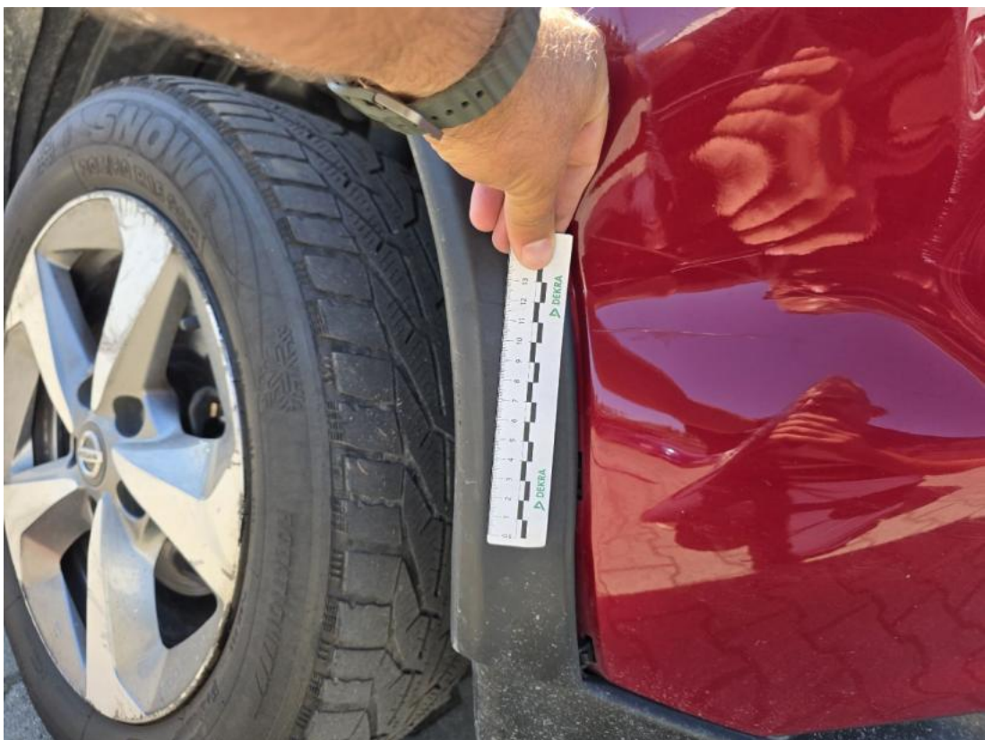
Fot. 50 Nadkole przednie P - Wgniecenie/odkształcenie 1
