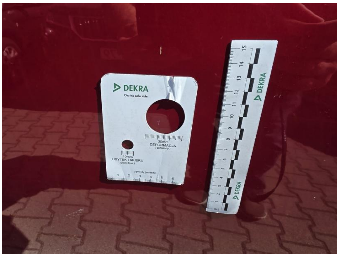
Fot. 83 Drzwi tylne L - Wgniecenie/odkształcenie 1
