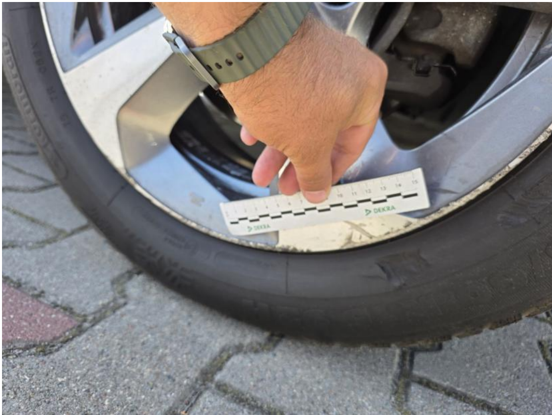
Fot. 45 Felga aluminiowa przednia P - Rysa/odprysk 2
