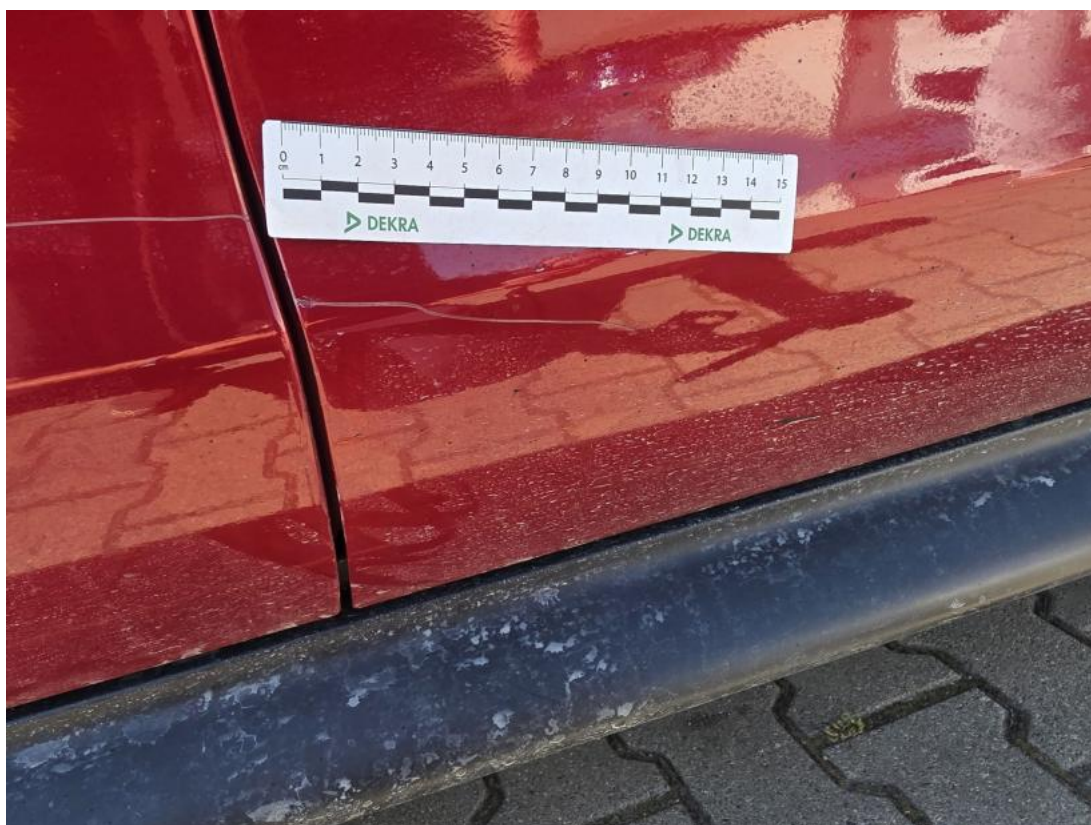
Fot. 58 Drzwi przednie P - Rysa/odprysk 2
