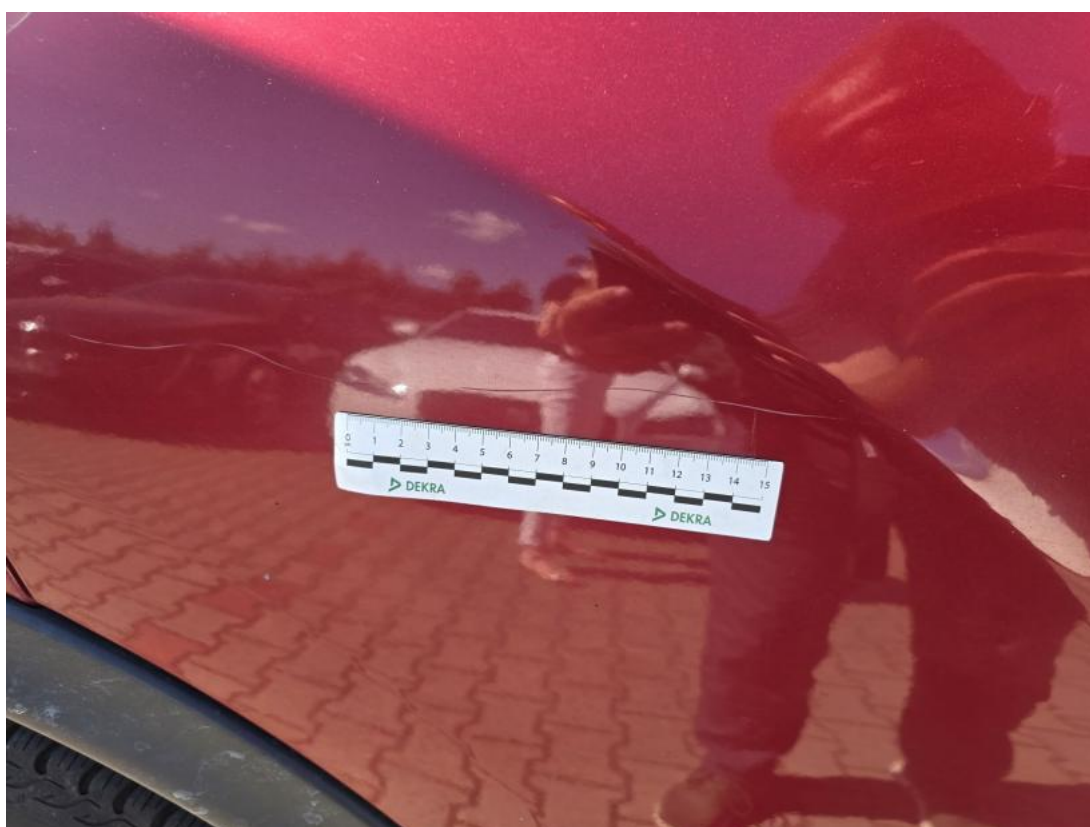
Fot. 64 Drzwi tylne P - Rysa/odprysk 2
