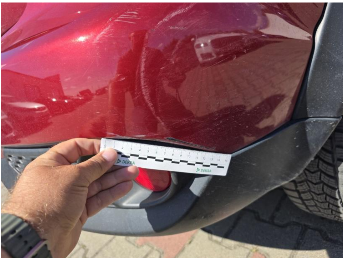
Fot. 72 Zderzak tylny() - Rysa/odprysk 3
