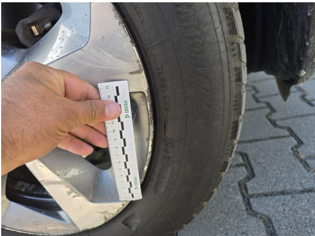
Fot. 46 Felga aluminiowa przednia P - Wgniecenie/odkształcenie 1
