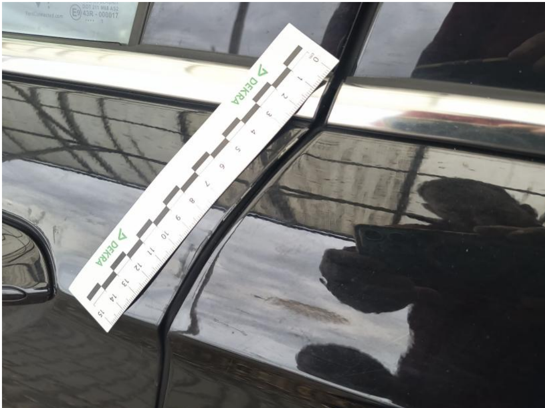
Fot. 49 Drzwi przed L - Rysa/odprysk 2
