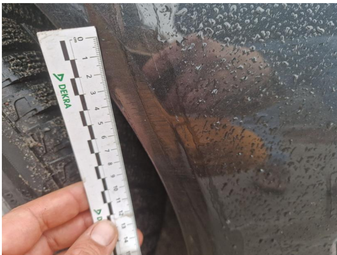
Fot. 41 Zderzak - Rysa/odprysk 2
