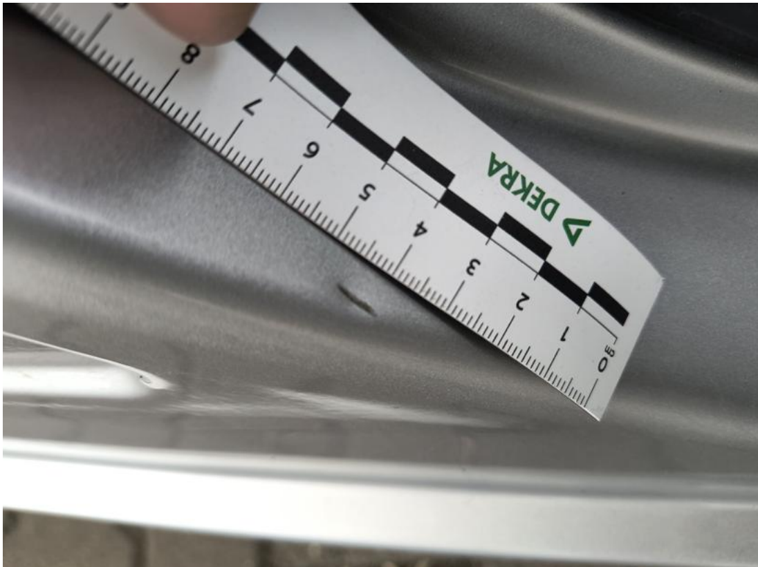
Fot. 49 Słupek środkowy P - Wgniecenie/odkształcenie 1
