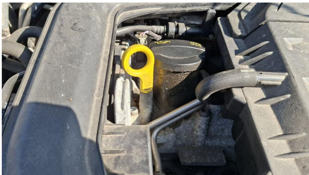
Fot. 36 Wlew oleju silnikowego - inne
