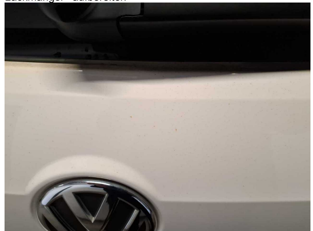
Beschädigung #12: Karosserie: Karosserie (Flugrost) - Lackmangel - aufbereiten
