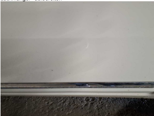
Beschädigung #12: Karosserie: Karosserie (Flugrost) - Lackmangel - aufbereiten
