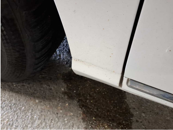
Beschädigung #12: Karosserie: Karosserie (Flugrost) - Lackmangel - aufbereiten
