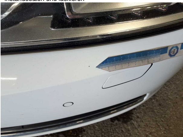
Beschädigung #6: Stossfänger vorn: Stossfänger vorn (Komplett... Vorderwagen) - Steinschlag
