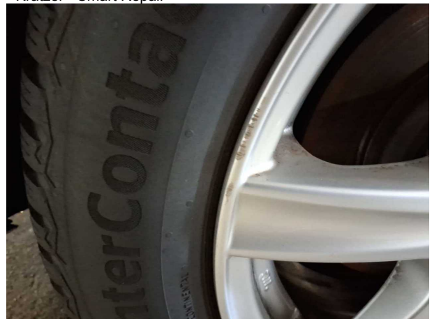
Beschädigung #4: Rad/Reifen: Leichtmetallfelge hinten rechts - Kratzer - Smart Repair
