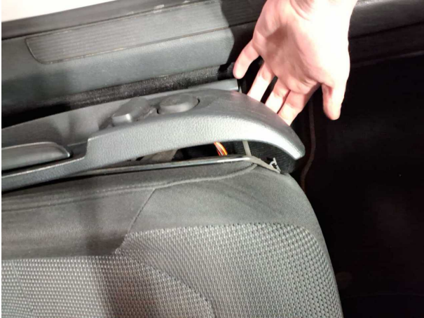
Beschädigung #14: Sitz vorn: Sitzkastenverkleidung links - lose - instandsetzen
