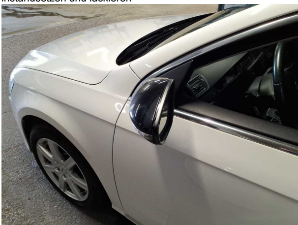
Beschädigung #9: Außenspiegel links: Spiegelgehäuse - gebrochen / gerissen - erneuern
