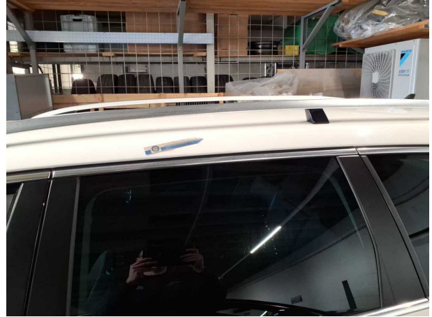
Beschädigung #10: Fahrzeugdach: Dachholm links - Delle(n... sanft instandsetzen
