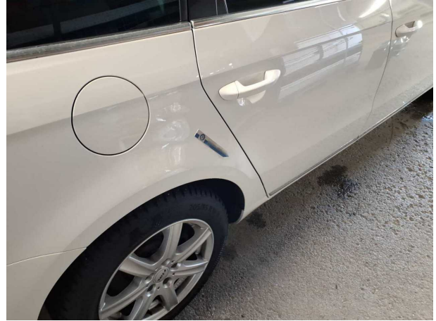
Beschädigung #7: Seitenwand rechts: Seitenwand - Delle(n) - sanft instandsetzen
