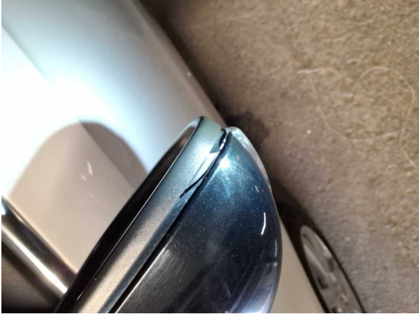
Beschädigung #9: Außenspiegel links: Spiegelgehäuse - gebrochen / gerissen - erneuern
