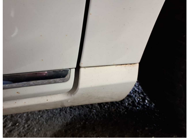
Beschädigung #12: Karosserie: Karosserie (Flugrost) - Lackmangel - aufbereiten
