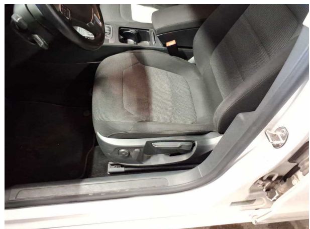
Beschädigung #14: Sitz vorn: Sitzkastenverkleidung links - lose - instandsetzen
