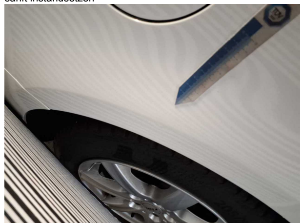
Beschädigung #7: Seitenwand rechts: Seitenwand - Delle(n) - sanft instandsetzen
