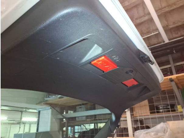
Beschädigung #1: Verkleidungen/Abdeckungen: Heckdeckel, Innenverkleidung - Kratzer
