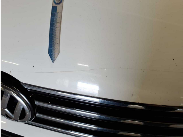
Beschädigung #5: Motorhaube: Motorhaube - verkratzt / versch... - instandsetzen und lackieren
