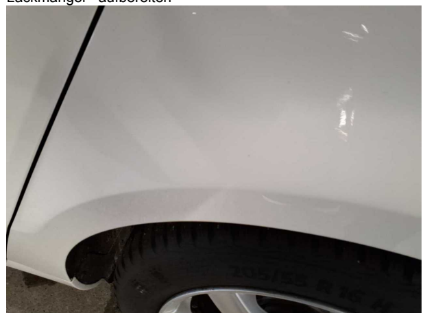
Beschädigung #12: Karosserie: Karosserie (Flugrost) - Lackmangel - aufbereiten
