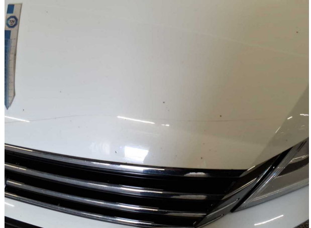
Beschädigung #5: Motorhaube: Motorhaube - verkratzt / verschürft - instandsetzen und lackieren
