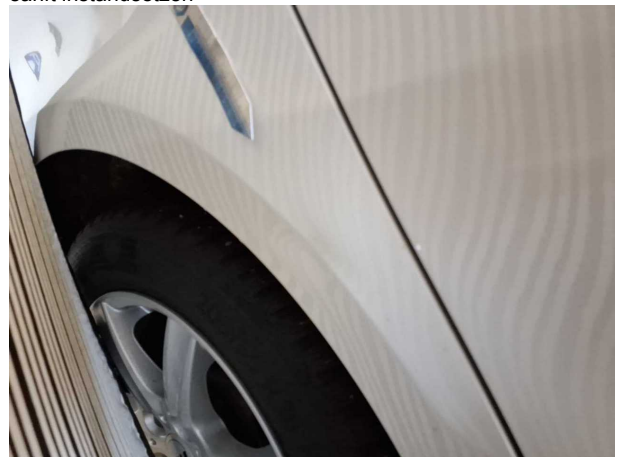
Beschädigung #7: Seitenwand rechts: Seitenwand - Delle(n) - sanft instandsetzen
