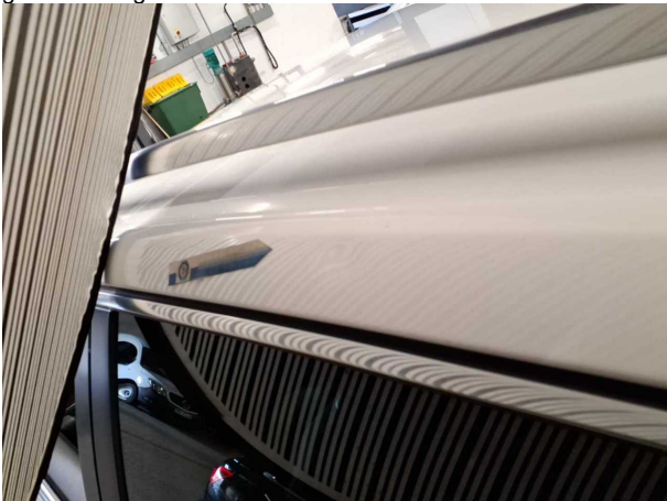
Beschädigung #10: Fahrzeugdach: Dachholm links - Delle(n) - sanft instandsetzen
