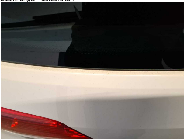
Beschädigung #12: Karosserie: Karosserie (Flugrost) - Lackmangel - aufbereiten
