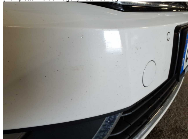
Beschädigung #6: Stossfänger vorn: Stossfänger vorn (Kompletter Vorderwagen) - Steinschlag
