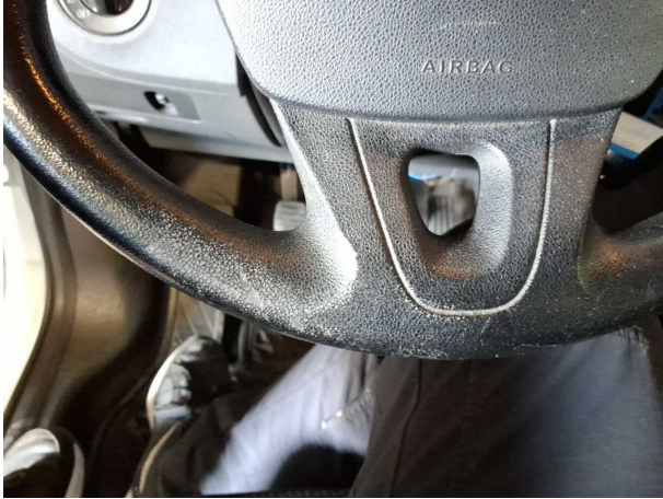
Beschädigung #17: Lenkanlage: Lenkrad - beschädigt - erneuern
