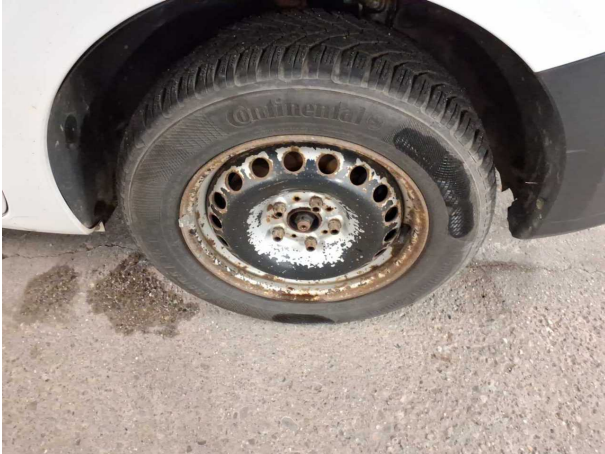
Beschädigung #19: Rad/Reifen: Felgensatz komplett (Alle 4x) - Korrosion
