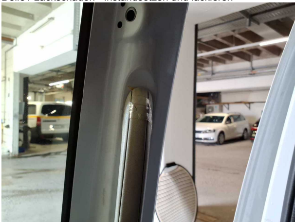
Beschädigung #3: Tür hinten links: Haltegriff - lose - instandsetzen
