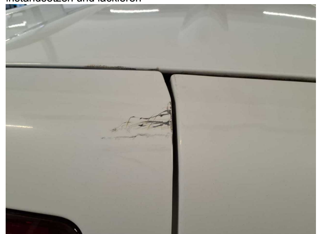
Beschädigung #28: Heckklappe/-tür: Hecktür links - verformt - instandsetzen und lackieren
