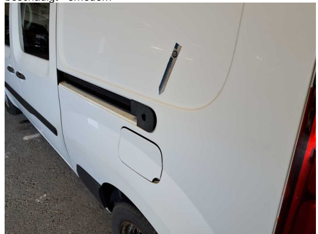
Beschädigung #30: Seitenwand links: Seitenwand (Blende) - verformt - erneuern
