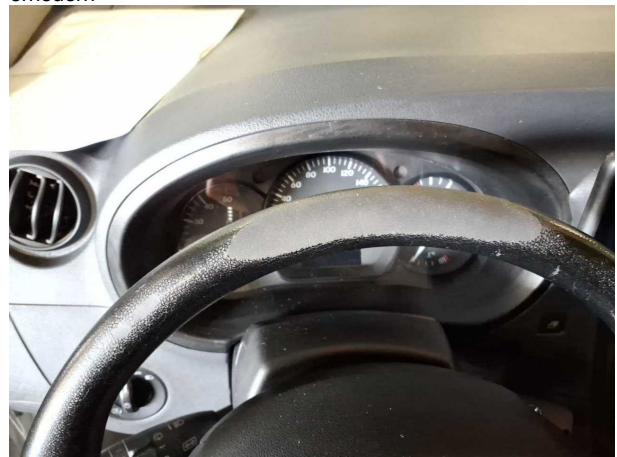
Beschädigung #17: Lenkanlage: Lenkrad - beschädigt - erneuern
