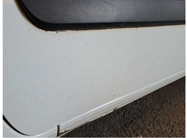
Beschädigung #34: Karosserie: Karosserie (Flugrost) - Lackmangel - entfernen
