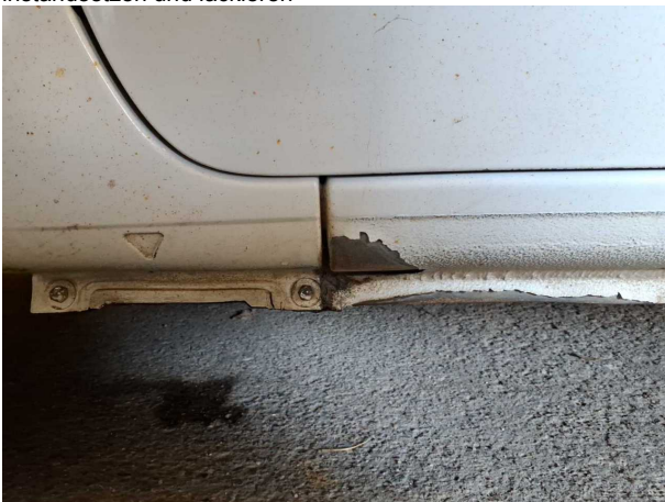
Beschädigung #31: Schweller links: Schweller - Korrosion - instandsetzen und lackieren
