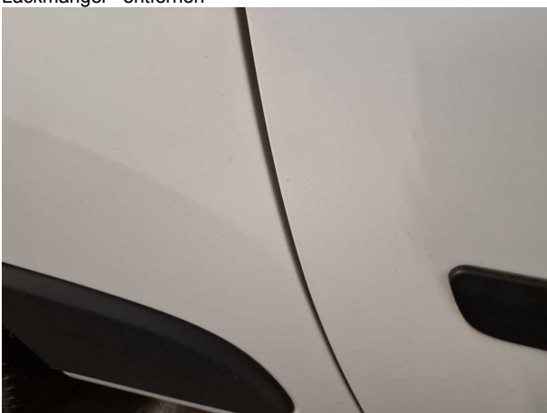
Beschädigung #34: Karosserie: Karosserie (Flugrost) - Lackmangel - entfernen
