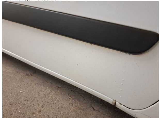
Beschädigung #34: Karosserie: Karosserie (Flugrost) - Lackmangel - entfernen
