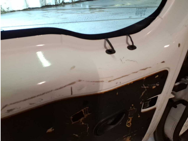
Beschädigung #8: Heckklappe/-tür: Hecktür links (Innenseite) - Delle / Lackschaden - instandsetzen und lackieren
