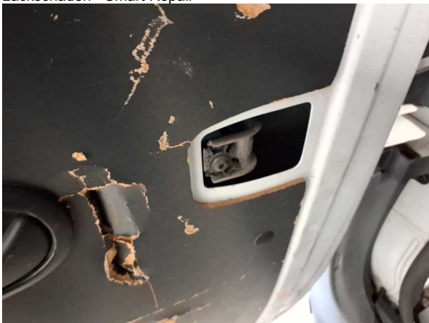
Beschädigung #7: Heckklappe/-tür: Verkleidung Standard unten (Rechts und links) - gebrochen / gerissen - erneuern
