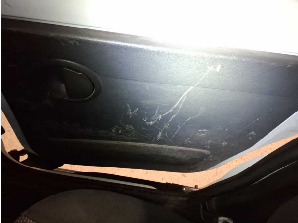
Beschädigung #11: Verkleidungen/Abdeckungen: Türverkleidung hinten rechts - verkratzt / verschürft - erneuern
