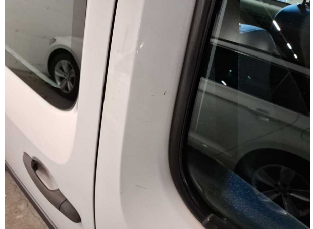
Beschädigung #22: Karosserie: Karosserie - Kratzer - aufbereiten
