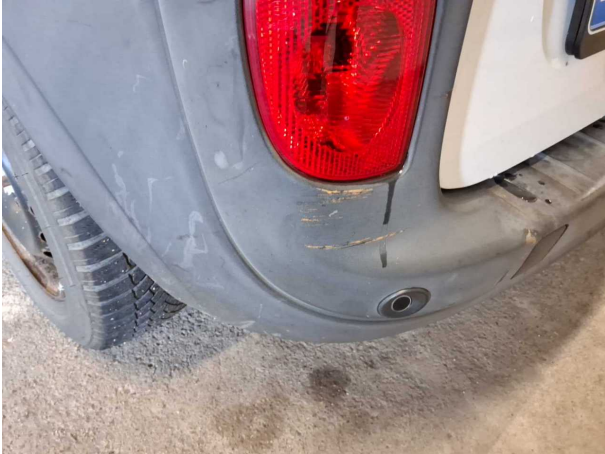
Beschädigung #27: Stossfänger hinten: Stossfänger hinten (unlackiert) - beschädigt - erneuern
