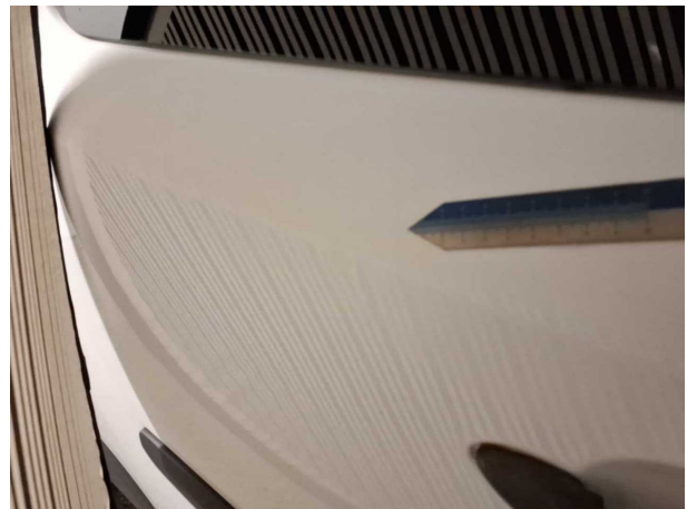
Beschädigung #24: Schiebetür rechts: Schiebetür - Delle(n)
