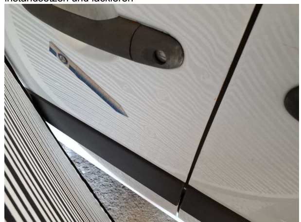
Beschädigung #32: Tür vorn links: Tür - Delle / Lackschaden - instandsetzen und lackieren
