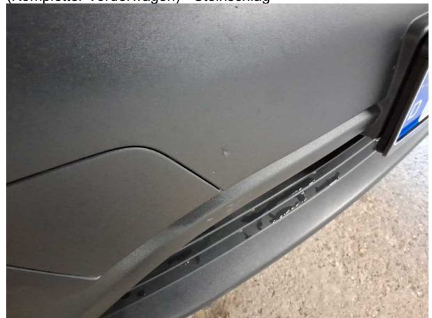
Beschädigung #18: Stossfänger vorn: Stossfänger vorn (Kompletter Vorderwagen) - Steinschlag
