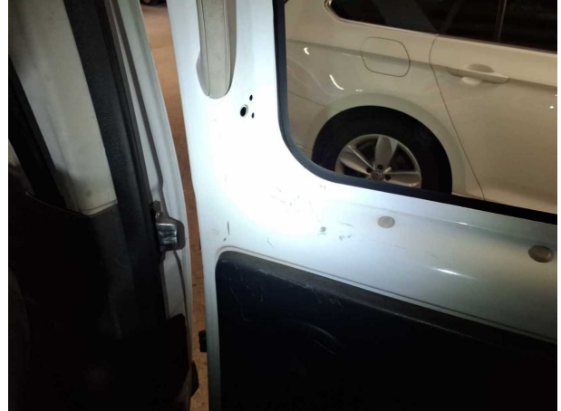
Beschädigung #12: Schiebetür rechts: Schiebetür (Innenseit... - Delle / Lackschaden - Smart Repair
