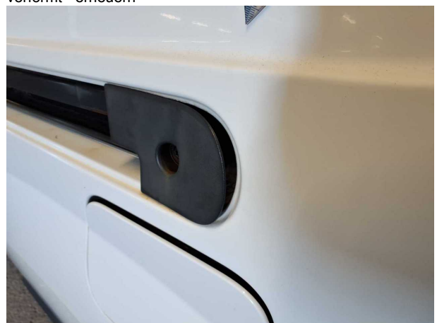
Beschädigung #30: Seitenwand links: Seitenwand (Blende) - verformt - erneuern
