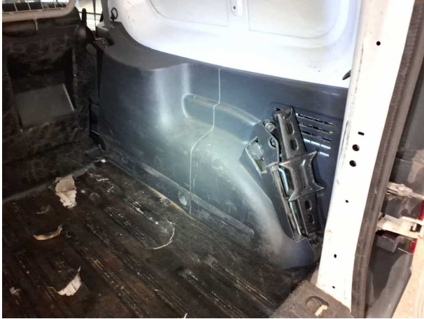
Beschädigung #5: Verkleidungen/Abdeckungen: Laderaumverkleidung rechts (Alle Verkleidungen) - Kratzer
