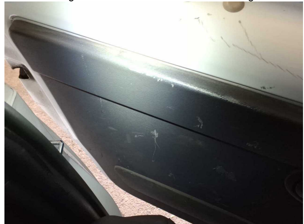
Beschädigung #1: Verkleidungen/Abdeckungen: Türverkleidung hinten links - Kratzer - Wertminderung
