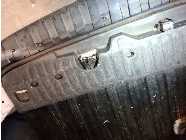
Beschädigung #5: Verkleidungen/Abdeckungen: Laderaumverkleidung rechts (Alle Verkleidungen) - Kratzer
