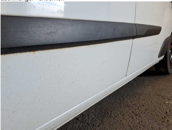
Beschädigung #34: Karosserie: Karosserie (Flugrost) - Lackmangel - entfernen
