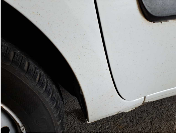
Beschädigung #34: Karosserie: Karosserie (Flugrost) - Lackmangel - entfernen
