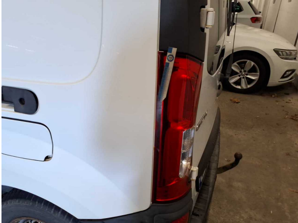
Beschädigung #29: Heckleuchte: Heckleuchte links - beschädigt - erneuern
