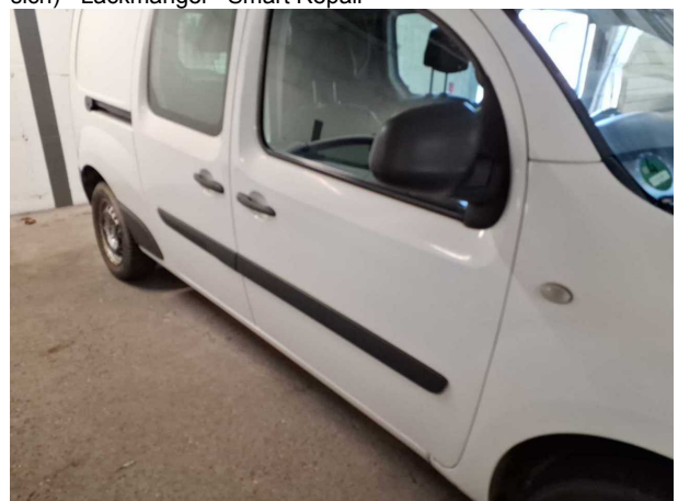
Beschädigung #22: Karosserie: Karosserie - Kratzer - aufbereiten
