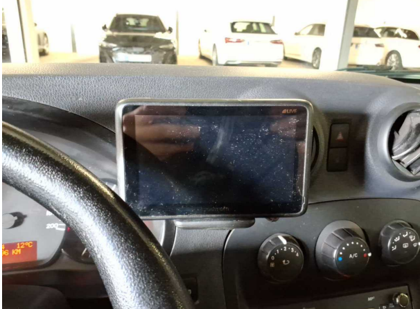
Beschädigung #15: Multimediasystem: Navigationssystem - ohne Funktion - Diagnose durchführen
