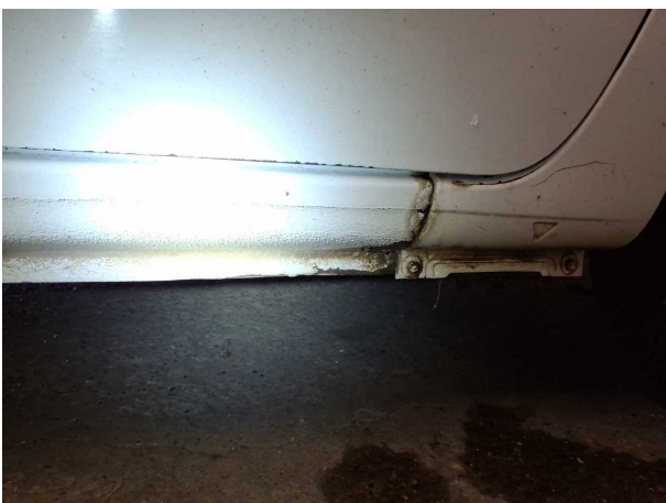
Beschädigung #21: Schweller rechts: Schweller (Lack löst sich) - Lackmangel - Smart Repair
