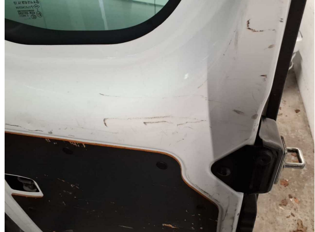
Beschädigung #9: Heckklappe/-tür: Hecktür rechts (Innenseite) - Delle / Lackschaden - instandsetzen und
