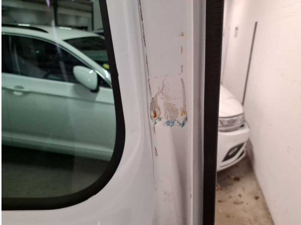
Beschädigung #9: Heckklappe/-tür: Hecktür rechts (Innenseite) - Delle / Lackschaden - instandsetzen und lackieren
