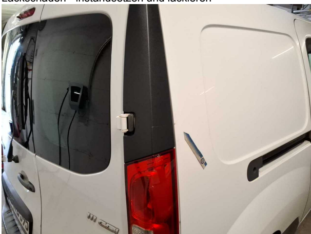
Beschädigung #26: Karosserie: D-Säule rechts (Blende außen) - Kratzer - erneuern
