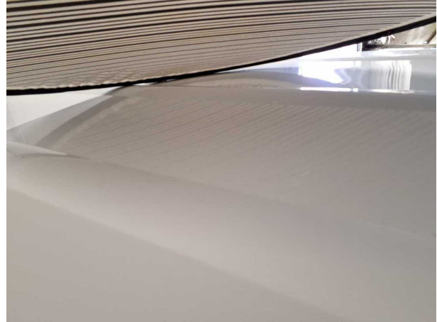
Beschädigung #10: Karosserie: Karosserie - Hagelschaden - sanft instandsetzen
