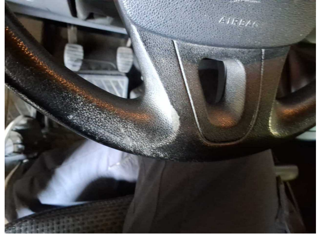
Beschädigung #17: Lenkanlage: Lenkrad - beschädigt - erneuern
