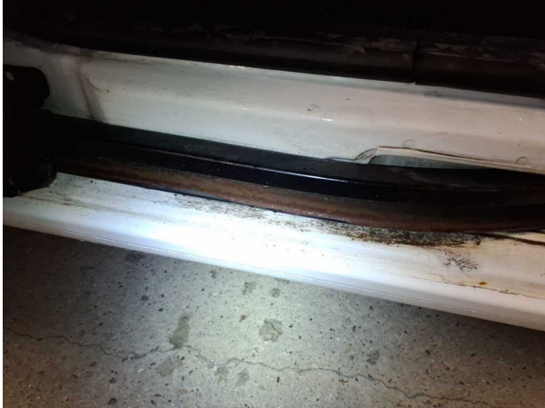
Beschädigung #14: Schiebetür rechts: Führungsschiene (Schwergängig, und links) - Funktion / Zulässigkeit - instandsetzen
