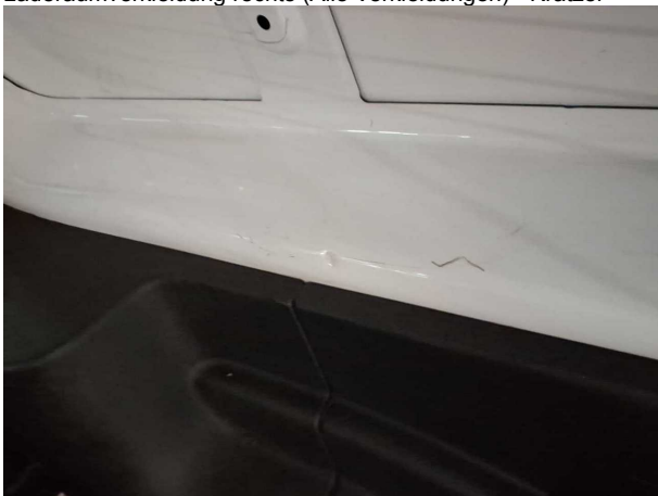
Beschädigung #5: Verkleidungen/Abdeckungen: Laderaumverkleidung rechts (Alle Verkleidungen) - Kratzer
