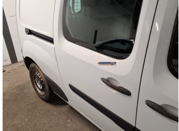
Beschädigung #24: Schiebetür rechts: Schiebetür - Delle(n)
