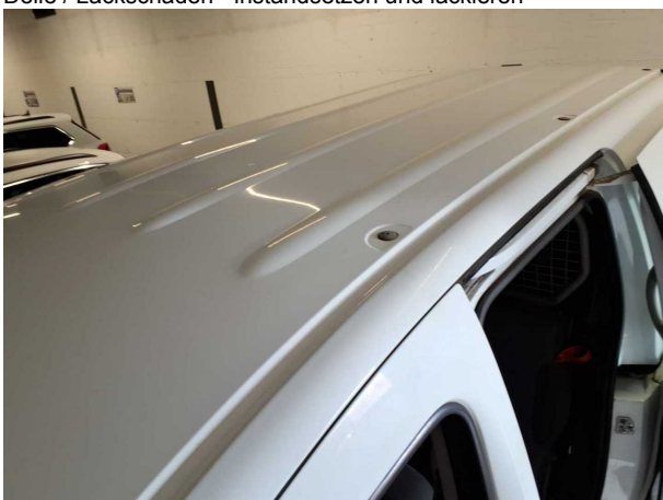
Beschädigung #10: Karosserie: Karosserie - Hagelschaden - sa... instandsetzen
