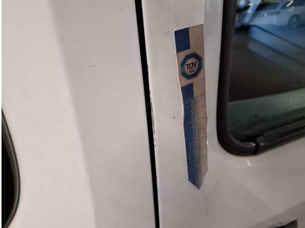
Beschädigung #23: Tür vorn rechts: Türkante - Kratzer
