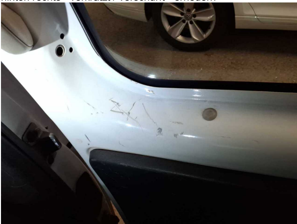
Beschädigung #12: Schiebetür rechts: Schiebetür (Innenseite) - Delle / Lackschaden - Smart Repair
