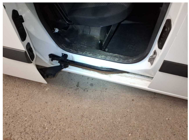
Beschädigung #14: Schiebetür rechts: Führungsschiene (Schwergängig, und links) - Funktion / Zulässigkeit -
