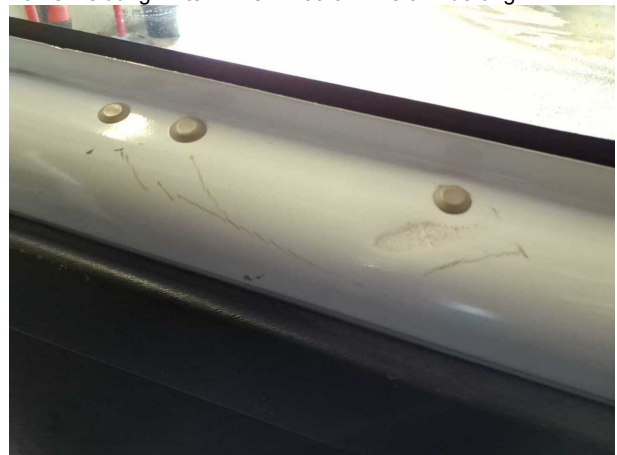
Beschädigung #2: Schiebetür links: Schiebetür (Innenseite) - Delle / Lackschaden - instandsetzen und lackieren
