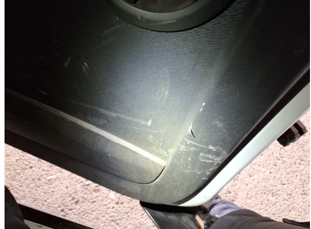
Beschädigung #1: Verkleidungen/Abdeckungen: Türverkleidung hinten links - Kratzer - Wertminderung
