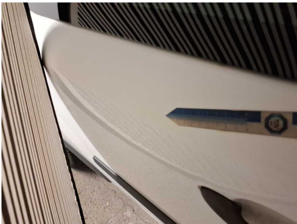
Beschädigung #24: Schiebetür rechts: Schiebetür - Delle(n)
