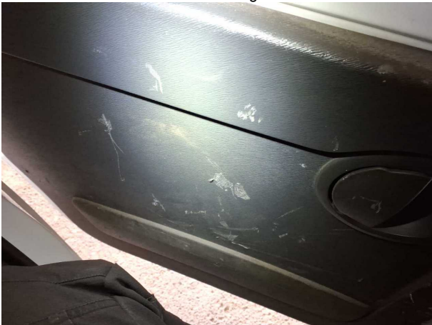
Beschädigung #1: Verkleidungen/Abdeckungen: Türverkleidung hinten links - Kratzer - Wertminderung
