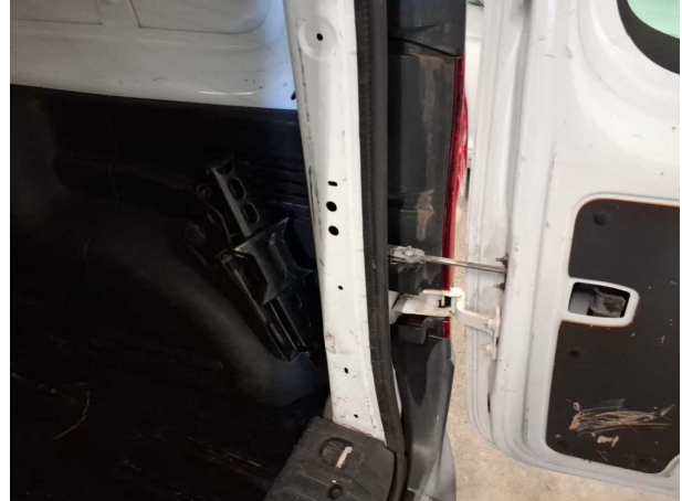
Beschädigung #6: Karosserie: D-Säule rechts (und links) - Delle / Lackschaden - Smart Repair
