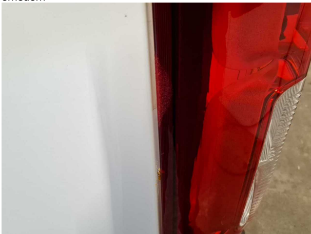
Beschädigung #29: Heckleuchte: Heckleuchte links - beschädigt - erneuern
