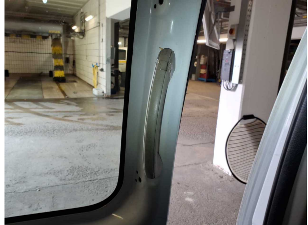
Beschädigung #3: Tür hinten links: Haltegriff - lose - instandsetzen
