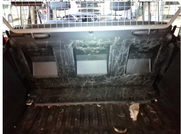
Beschädigung #5: Verkleidungen/Abdeckungen: Laderaumverkleidung rechts (Alle Verkleidungen) - Kratzer
