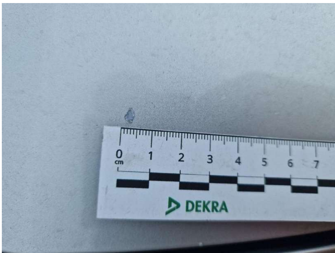
Fot. 37 Pokrywa komory silnika - Rysa/odprysk 1
