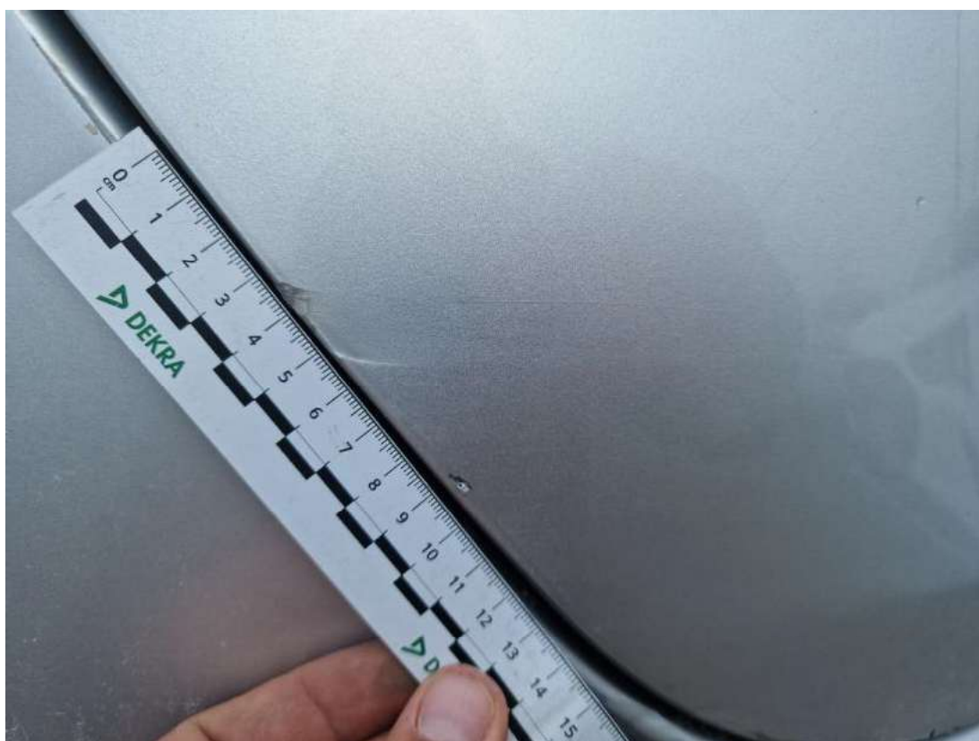
Fot. 50 Pokrywy bagażnika - Wgniecenie/odkształcenie 1
