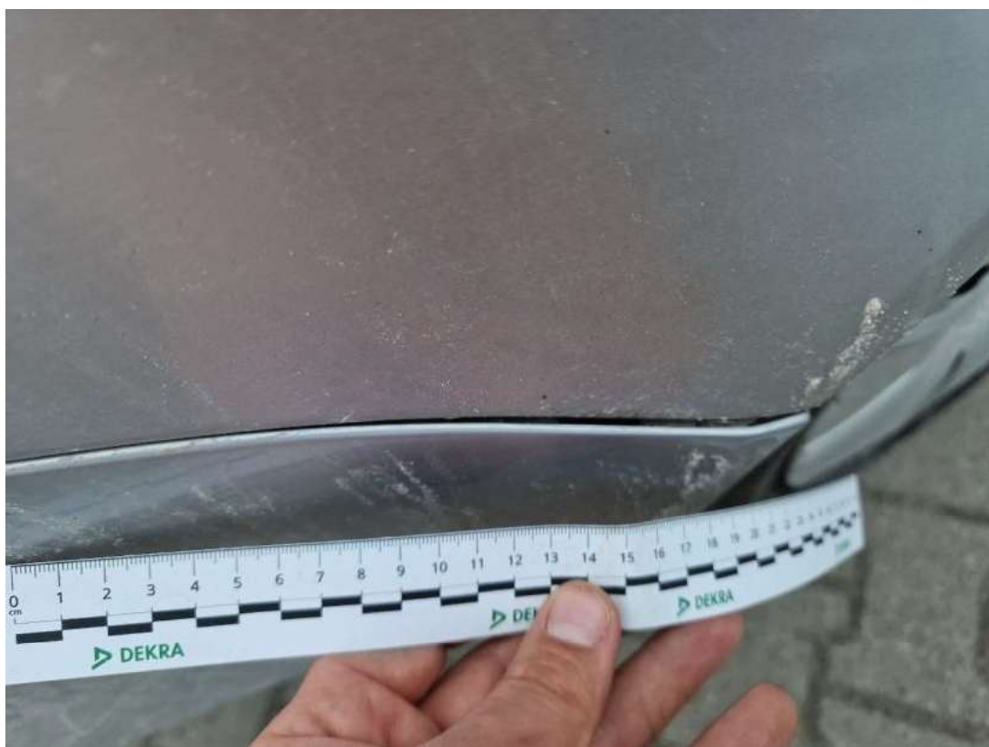
Fot. 55 Zderzak tylny() - Pęknięcie/rozerwanie 3
