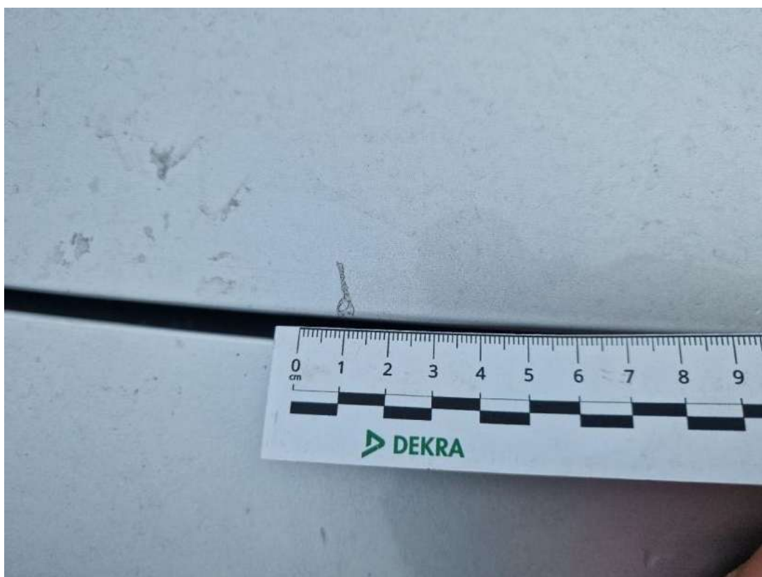
Fot. 38 Pokrywa komory silnika - Rysa/odprysk 2
