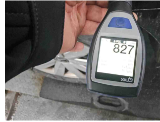
Lackstärke Seitenwand hinten links
