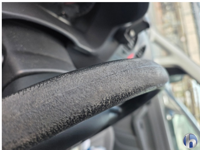
4. Lenkrad Verschlissen - Erneuern 371,05 € / 371,05 €
