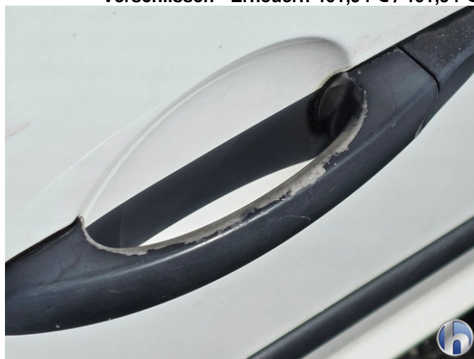
9. Türgriff 4x Verschlissen - Erneuern 466,89 € / 93,38 €
