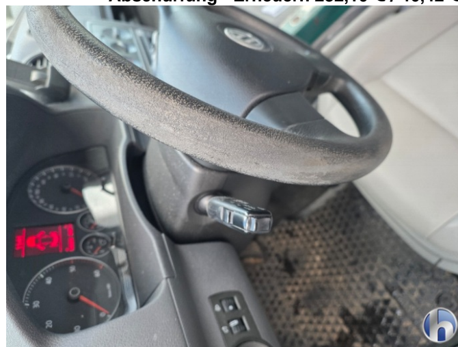
4. Lenkrad Verschlissen - Erneuern 371,05 € / 371,05 €
