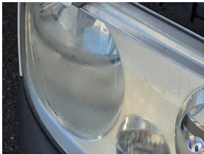
8. Scheinwerfer Halogen - Rechts Verschlissen - Erneuern 461,94 € / 461,94 €
