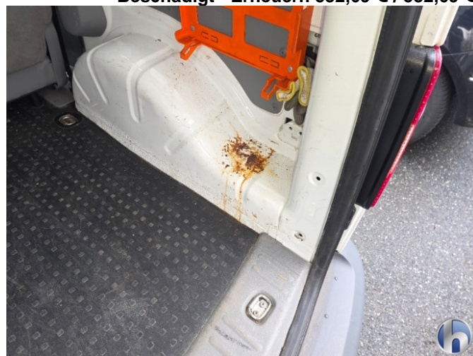
6. Korrosion Kofferraum Korrodiert - Lackieren 527,11 € / 105,42 €
