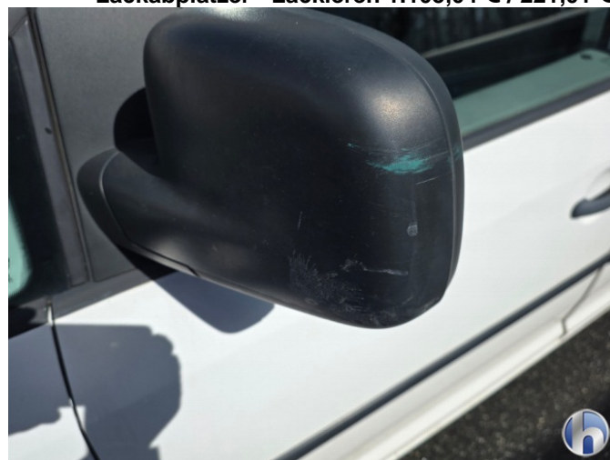
3. Außenspiegel Gehäuse - Links Abschürfung - Erneuern 232,10 € / 46,42 €
