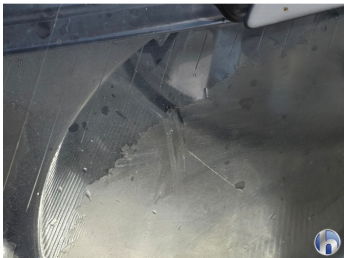
7. Scheinwerfer Halogen - Links Verschlissen - Erneuern 461,94 € / 461,94 €
