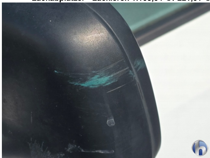
3. Außenspiegel Gehäuse - Links Abschürfung - Erneuern 232,10 € / 46,42 €
