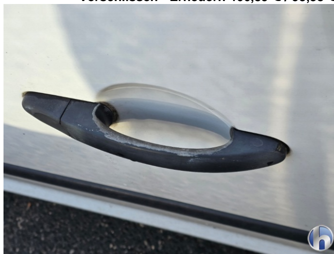
9. Türgriff 4x Verschlissen - Erneuern 466,89 € / 93,38 €
