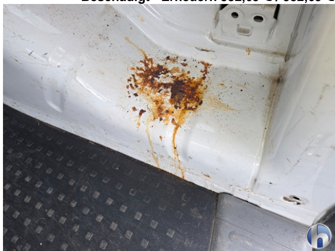
6. Korrosion Kofferraum Korrodiert - Lackieren 527,11 € / 105,42 €
