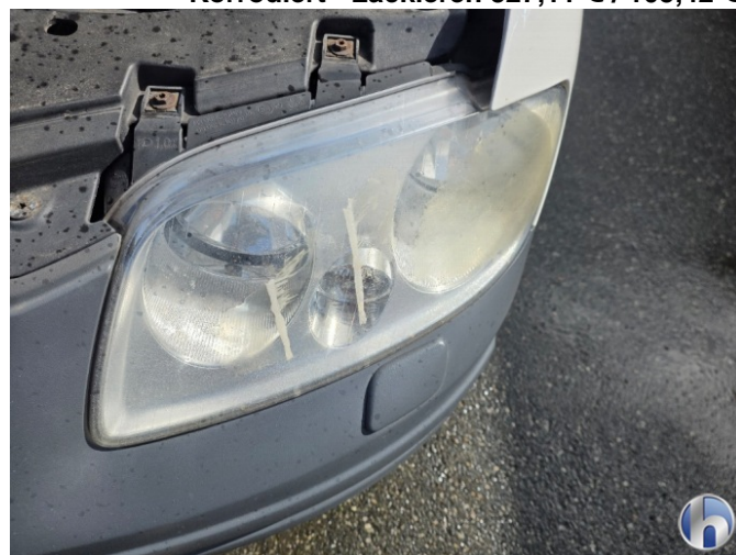
7. Scheinwerfer Halogen - Links Verschlissen - Erneuern 461,94 € / 461,94 €
