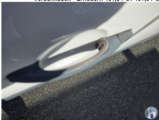
9. Türgriff 4x Verschlissen - Erneuern 466,89 € / 93,38 €
