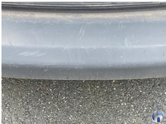
1. Stoßfänger Hinten Kratzer - Erneuern 549,47 € / 109,89 €
