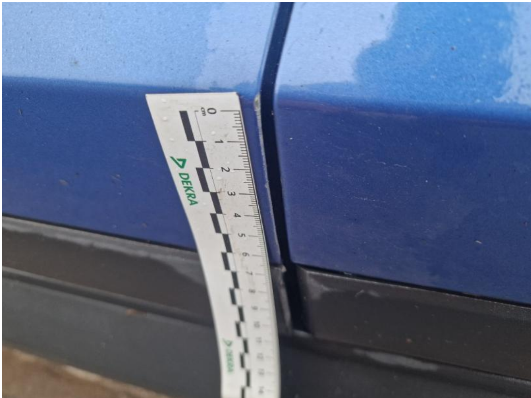
Fot. 41 Drzwi przed L - Rysa/odprysk 1
