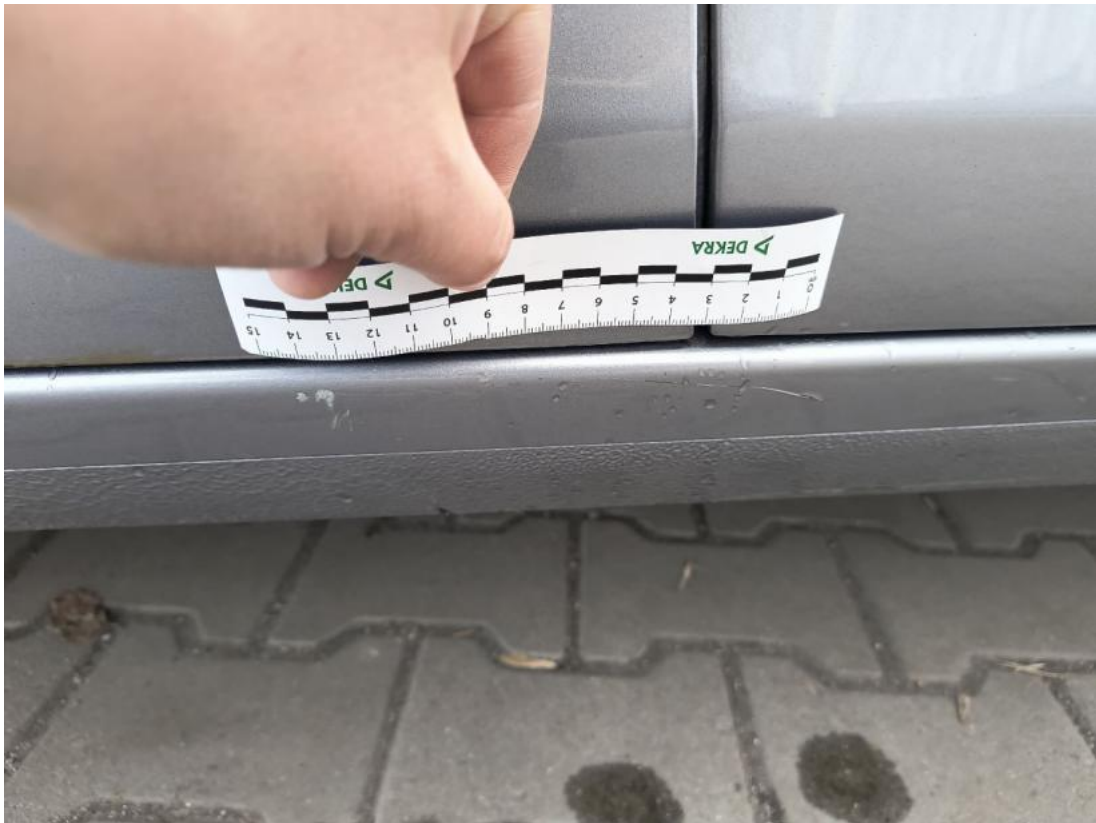
Fot. 73 Próg L - Rysa/odprysk 1
