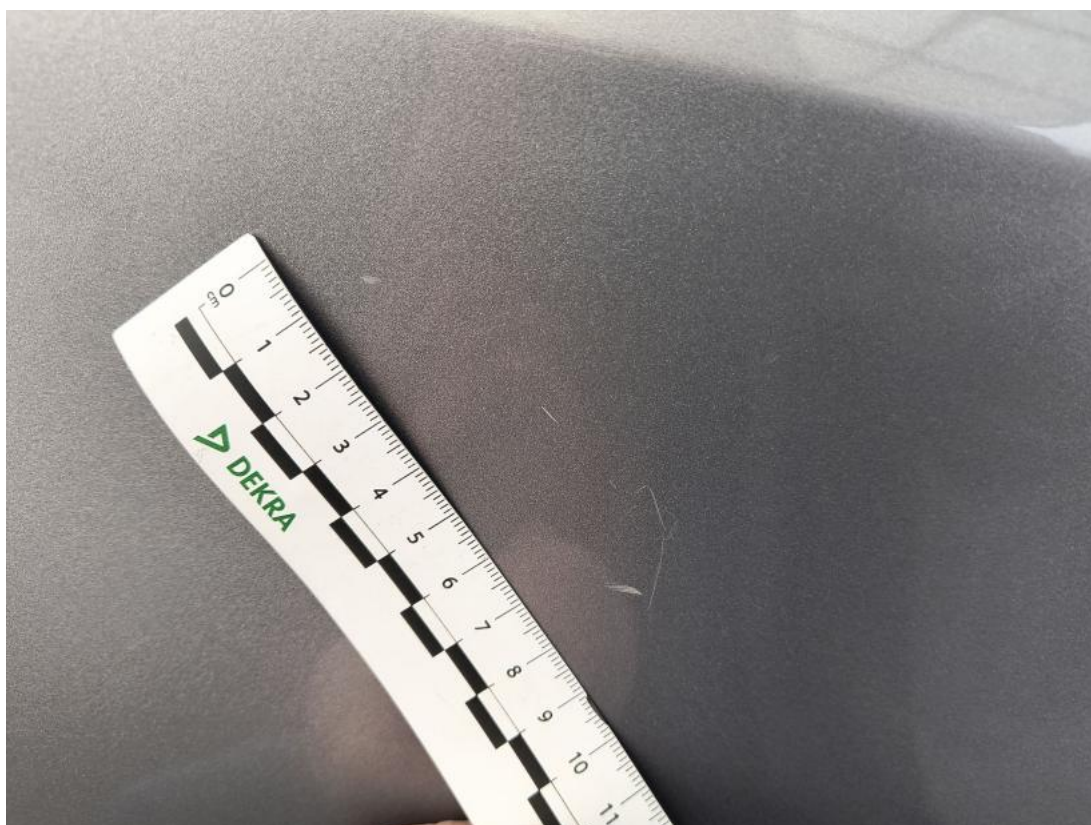
Fot. 53 Drzwi tylne P - Rysa/odprysk 1
