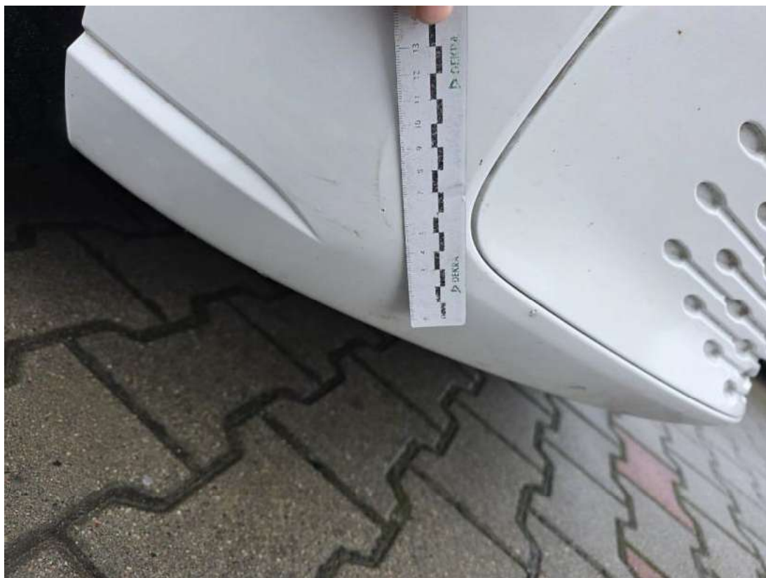
Fot. 41 Zderzak() - Rysa/odprysk 3
