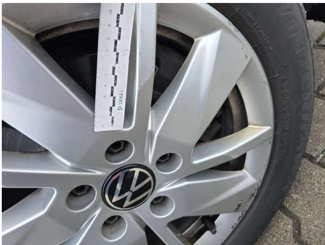
Fot. 45 Felga aluminiowa przednia P - Rysa/odprysk 2
