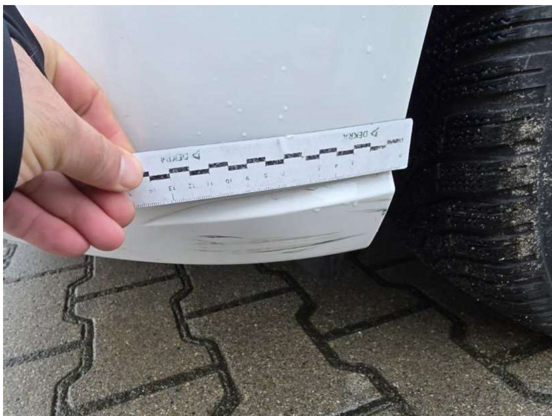
Fot. 39 Zderzak - Rysa/odprysk 1
