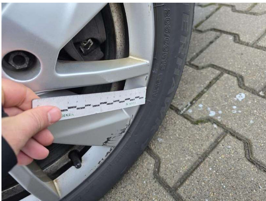
Fot. 46 Felga aluminiowa przednia P() - Rysa/odprysk 3
