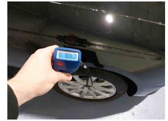
Lackstärke Kotflügel vorne rechts
