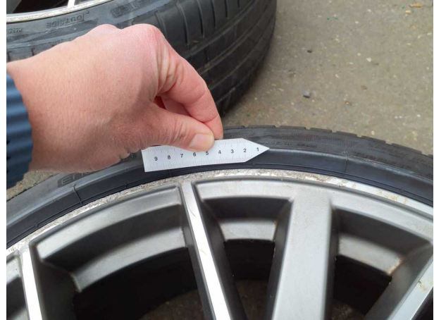
Beschädigung #17: 2.Radsatz: Leichtmetallfelgensatz komplett - verkratzt / verschürft - erneuern
