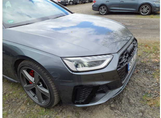
Beschädigung #10: Stossfänger vorn: Blende unter Scheinwerfer - verkratzt / verschürft - erneuern
