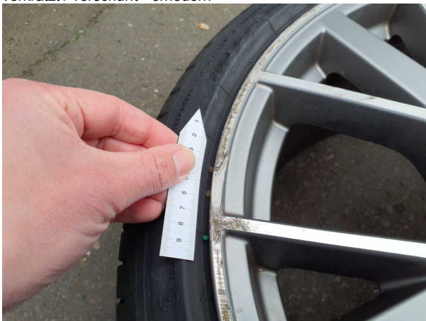
Beschädigung #17: 2.Radsatz: Leichtmetallfelgensatz komplett - verkratzt / verschürft - erneuern
