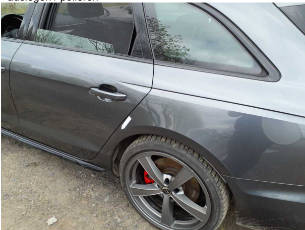
Beschädigung #16: Seitenwand links: Seitenwand - Delle(n) - Smart Repair
