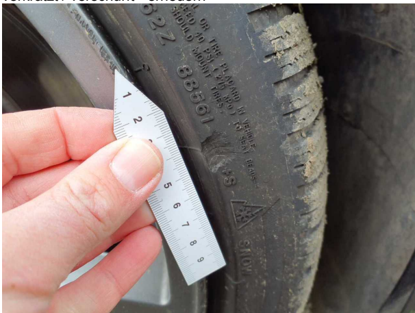
Beschädigung #5: Rad/Reifen: Reifen vorn rechts - beschädigt - erneuern
