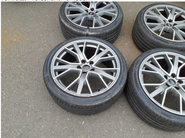
Beschädigung #17: 2.Radsatz: Leichtmetallfelgensatz komplett - verkratzt / verschürft - erneuern
