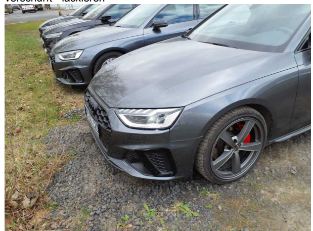
Beschädigung #9: Stossfänger vorn: Stossfänger vorn - verformt - erneuern
