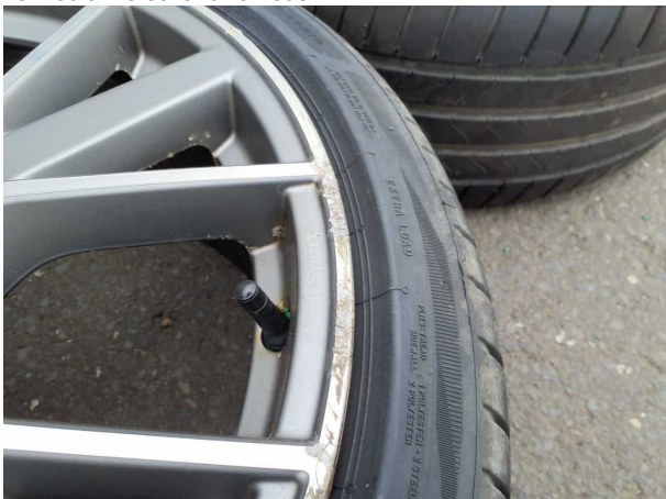
Beschädigung #17: 2.Radsatz: Leichtmetallfelgensatz komplett - verkratzt / verschürft - erneuern
