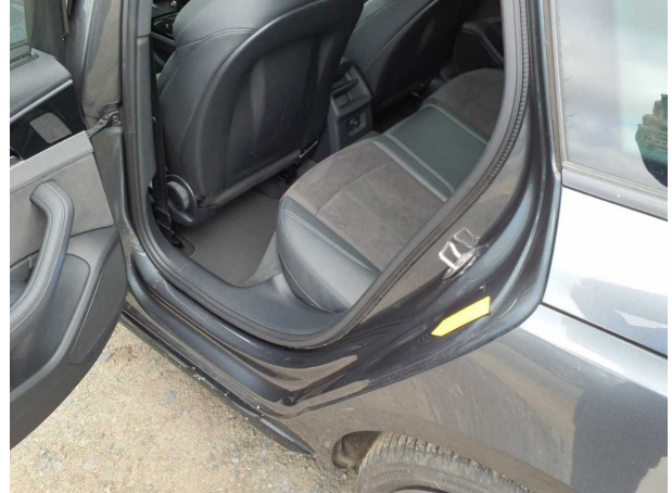
Beschädigung #8: Seitenwand links: Einstieg - verkratzt / verschürft - lackieren
