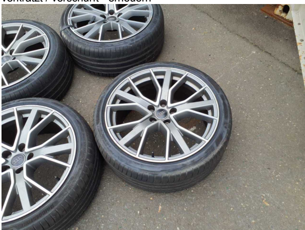
Beschädigung #17: 2.Radsatz: Leichtmetallfelgensatz komplett - verkratzt / verschürft - erneuern
