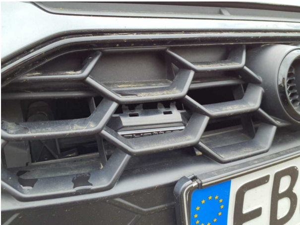
Beschädigung #11: Motorhaube: Kühlergrill (Emblem) - beschädigt... - erneuern
