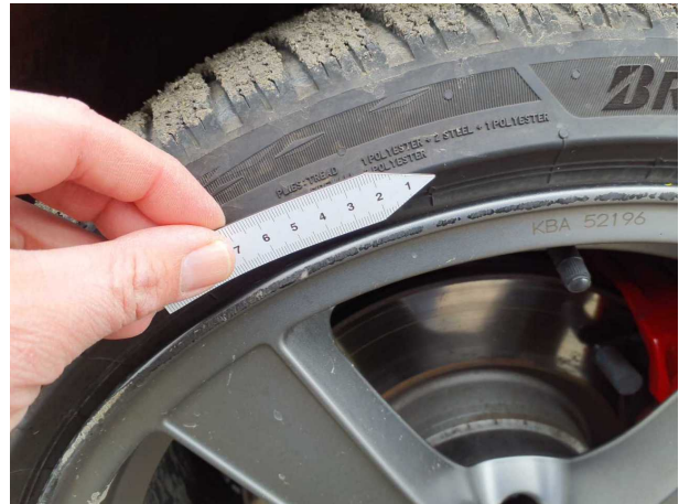
Beschädigung #1: Rad/Reifen: Leichtmetallfelge vorn links - verkratzt / verschürft - erneuern
