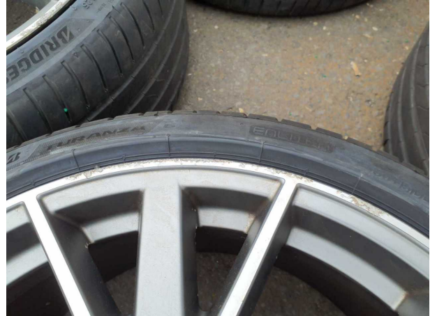
Beschädigung #17: 2.Radsatz: Leichtmetallfelgensatz komplett - verkratzt / verschürft - erneuern
