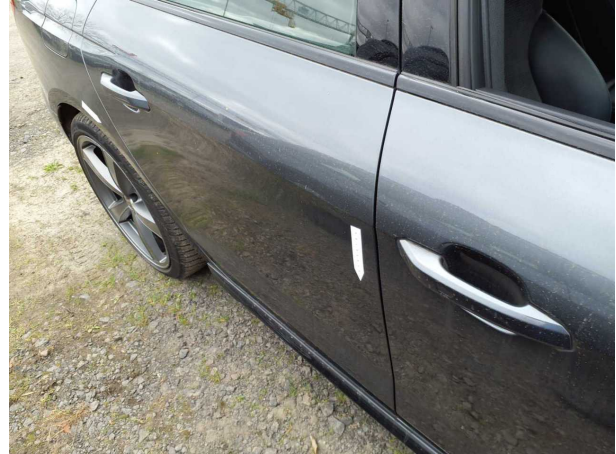
Beschädigung #13: Tür hinten rechts: Tür - Kratzer - auslegen / polieren
