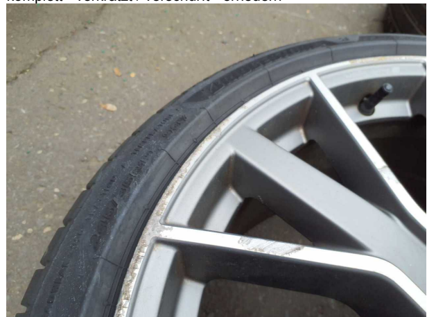
Beschädigung #17: 2.Radsatz: Leichtmetallfelgensatz komplett - verkratzt / verschürft - erneuern
