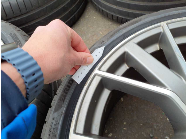
Beschädigung #17: 2.Radsatz: Leichtmetallfelgensatz komplett - verkratzt / verschürft - erneuern
