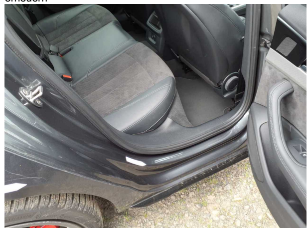
Beschädigung #7: Seitenwand rechts: Einstieg - Kratzer - lackieren
