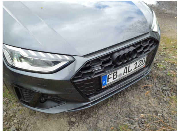
Beschädigung #11: Motorhaube: Kühlergrill (Emblem) - beschädigt - erneuern
