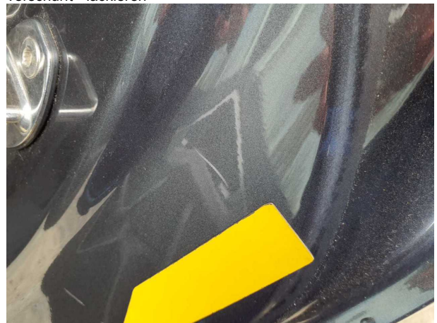
Beschädigung #8: Seitenwand links: Einstieg - verkratzt / verschürft - lackieren
