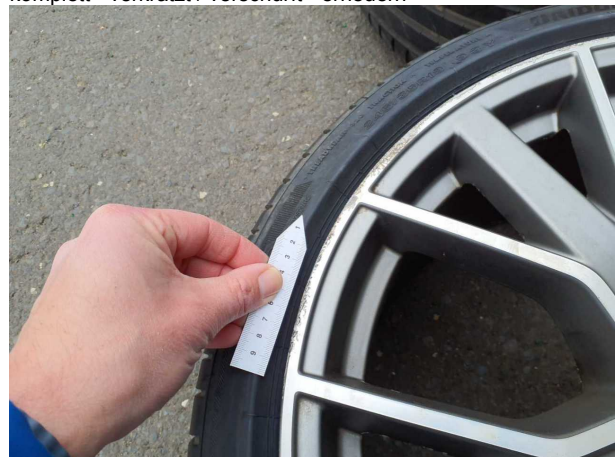
Beschädigung #17: 2.Radsatz: Leichtmetallfelgensatz komplett - verkratzt / verschürft - erneuern
