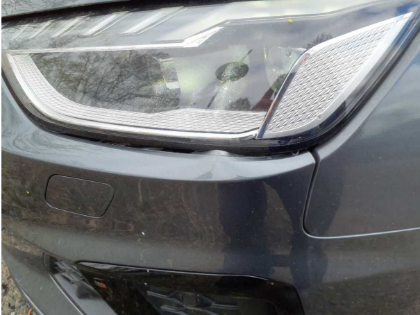
Beschädigung #9: Stossfänger vorn: Stossfänger vorn - verformt - erneuern
