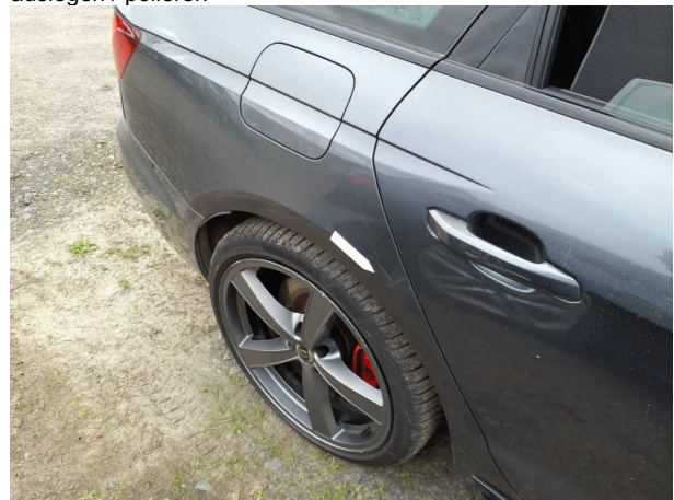
Beschädigung #14: Seitenwand rechts: Seitenwand - verkratzt / verschürft - lackieren
