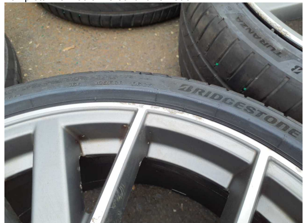
Beschädigung #17: 2.Radsatz: Leichtmetallfelgensatz komplett - verkratzt / verschürft - erneuern
