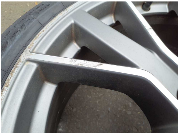
Beschädigung #17: 2.Radsatz: Leichtmetallfelgensatz komplett - verkratzt / verschürft - erneuern
