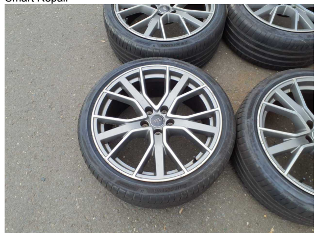
Beschädigung #17: 2.Radsatz: Leichtmetallfelgensatz komplett - verkratzt / verschürft - erneuern
