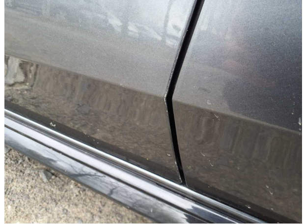
Beschädigung #15: Tür vorn links: Türkante - verkratzt / verschürft - auslegen / polieren
