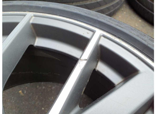
Beschädigung #17: 2.Radsatz: Leichtmetallfelgensatz komplett - verkratzt / verschürft - erneuern
