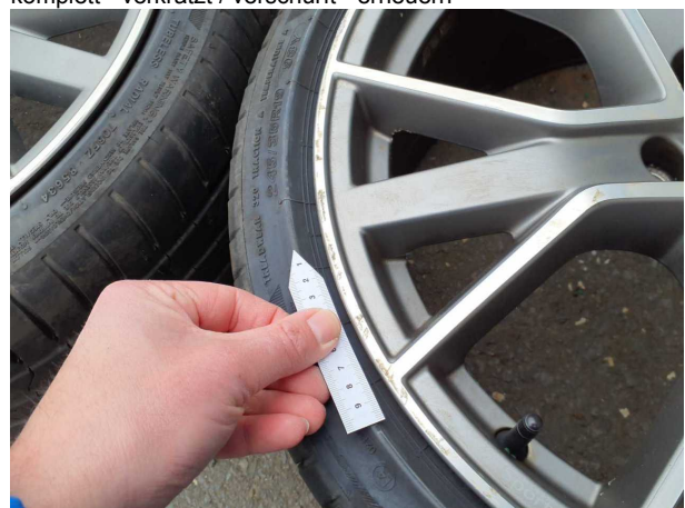
Beschädigung #17: 2.Radsatz: Leichtmetallfelgensatz komplett - verkratzt / verschürft - erneuern
