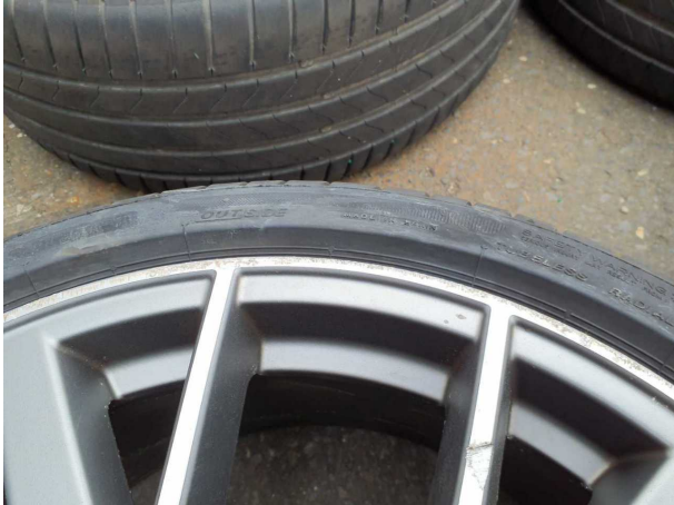
Beschädigung #17: 2.Radsatz: Leichtmetallfelgensatz komplett - verkratzt / verschürft - erneuern
