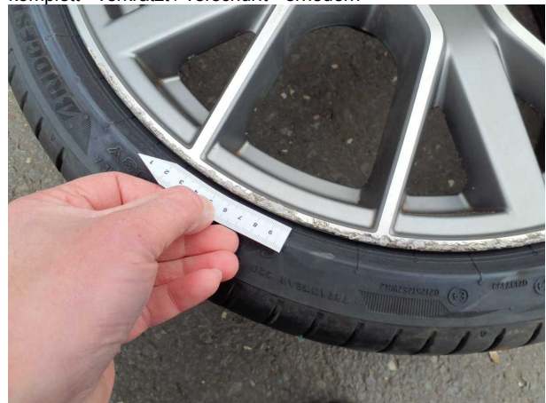
Beschädigung #17: 2.Radsatz: Leichtmetallfelgensatz komplett - verkratzt / verschürft - erneuern
