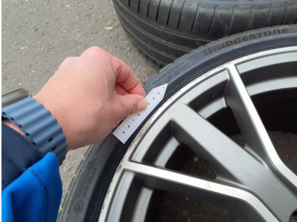
Beschädigung #17: 2.Radsatz: Leichtmetallfelgensatz komplett - verkratzt / verschürft - erneuern
