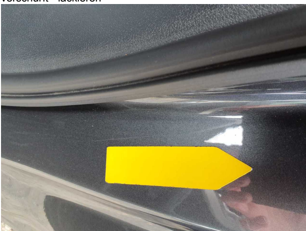
Beschädigung #8: Seitenwand links: Einstieg - verkratzt / verschürft - lackieren
