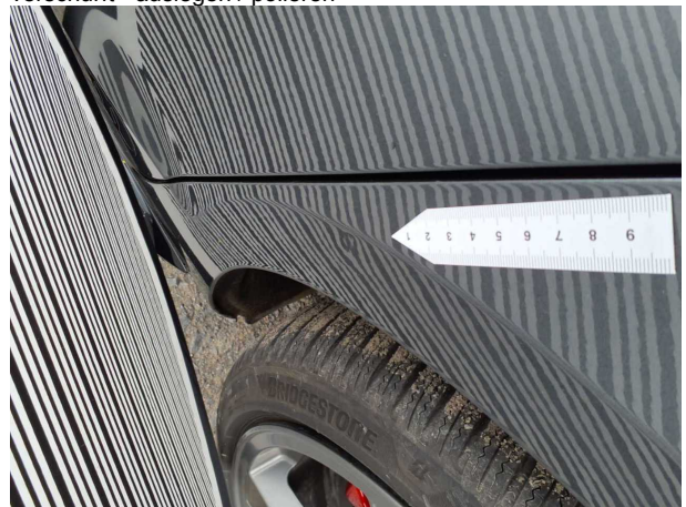
Beschädigung #16: Seitenwand links: Seitenwand - Delle(n) - Smart Repair
