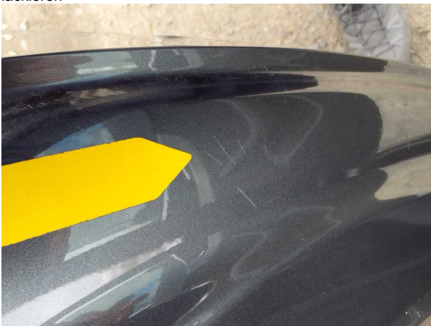
Beschädigung #8: Seitenwand links: Einstieg - verkratzt / verschürft - lackieren
