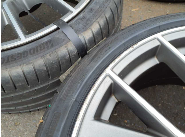
Beschädigung #17: 2.Radsatz: Leichtmetallfelgensatz komplett - verkratzt / verschürft - erneuern
