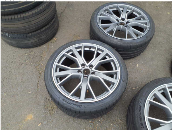
Beschädigung #7: 2.Radsatz: 2 Leichtmetallfelgen - verkratzt / verschürft - erneuern
