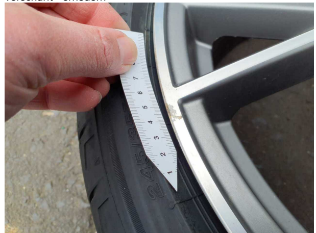
Beschädigung #7: 2.Radsatz: 2 Leichtmetallfelgen - verkratzt / verschürft - erneuern
