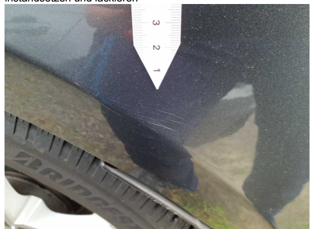
Beschädigung #5: Seitenwand links: Seitenwand - Kratzer - Smart Repair
