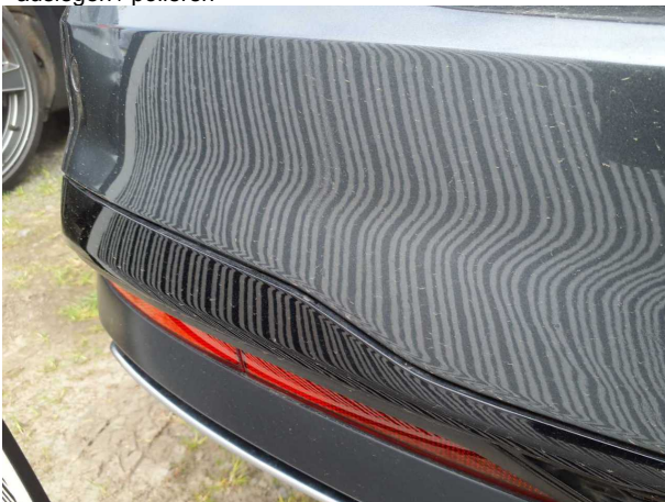
Beschädigung #4: Heckklappe/-tür: Heckklappe - verformt - instandsetzen und lackieren
