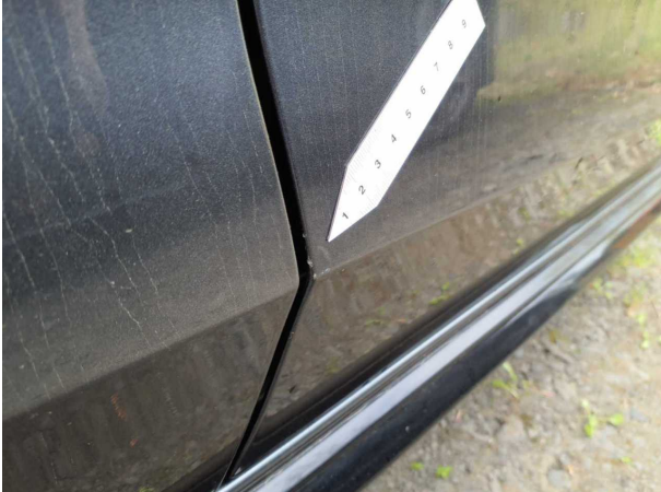
Beschädigung #3: Tür vorn rechts: Türkante - verkratzt / verschü... - auslegen / polieren
