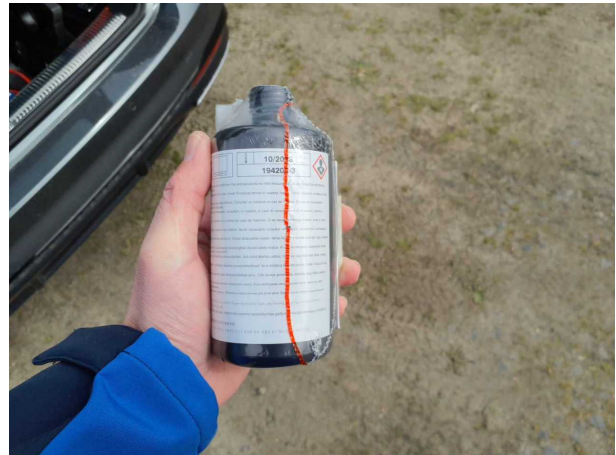
Beschädigung #2: Ausrüstung: Tirefit Füllmittel - abgelaufen - erneuern
