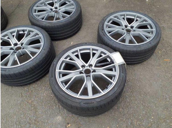
Beschädigung #7: 2.Radsatz: 2 Leichtmetallfelgen - verkratzt / verschürft - erneuern
