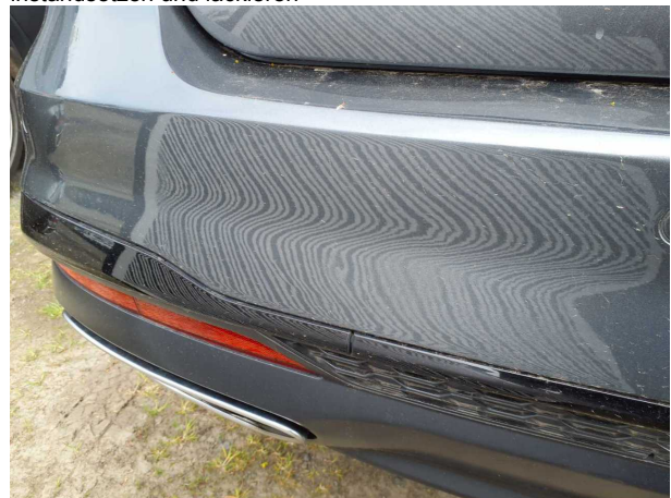
Beschädigung #4: Heckklappe/-tür: Heckklappe - verformt - instandsetzen und lackieren
