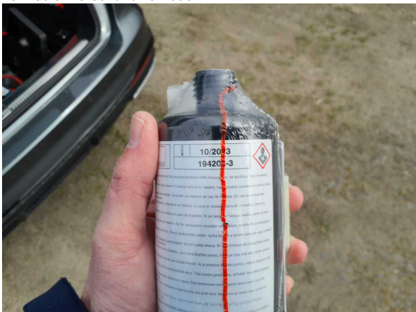
Beschädigung #2: Ausrüstung: Tirefit Füllmittel - abgelaufen - erneuern
