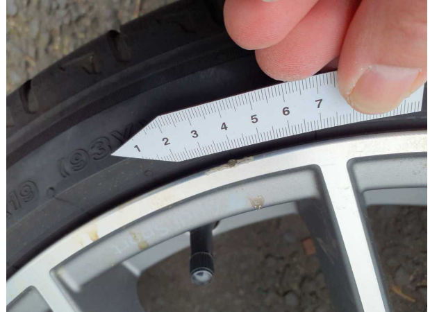
Beschädigung #7: 2.Radsatz: 2 Leichtmetallfelgen - verkratzt / verschürft - erneuern
