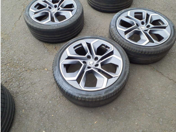
Beschädigung #11: 2.Radsatz: Leichtmetallfelgensatz komplett - verkratzt / verschürft - erneuern
