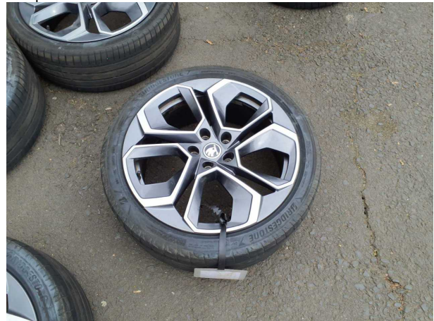
Beschädigung #11: 2.Radsatz: Leichtmetallfelgensatz komplett - verkratzt / verschürft - erneuern
