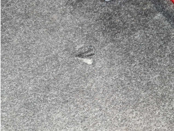
Beschädigung #5: Interieur: Laderaumboden - beschädigt - erneuern
