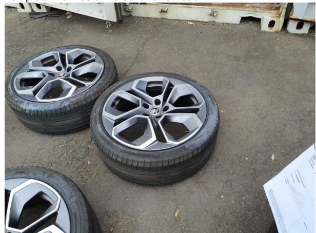
Beschädigung #12: 2.Radsatz: 2 Reifen - verschlissen - erneuern
