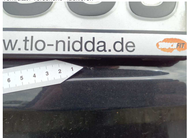
Beschädigung #4: Heckklappe/-tür: Heckklappe - Korrosion - instandsetzen und lackieren
