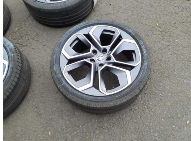
Beschädigung #11: 2.Radsatz: Leichtmetallfelgensatz komplett - verkratzt / verschürft - erneuern
