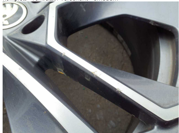
Beschädigung #11: 2.Radsatz: Leichtmetallfelgensatz komplett - verkratzt / verschürft - erneuern
