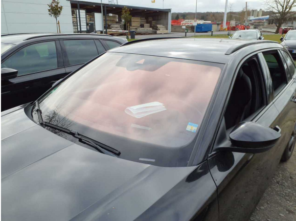
Beschädigung #1: Verglasung: Frontscheibe - Steinschlag - erneuern
