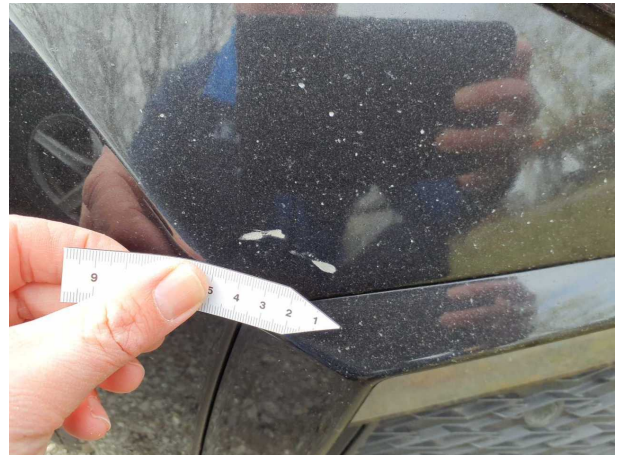
Beschädigung #2: Stossfänger vorn: Stossfänger vorn - verkratzt / verschürft - lackieren
