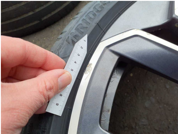
Beschädigung #11: 2.Radsatz: Leichtmetallfelgensatz komplett - verkratzt / verschürft - erneuern
