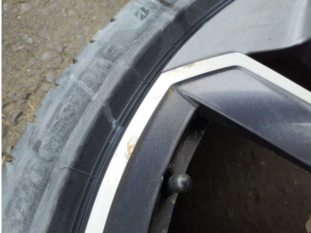
Beschädigung #11: 2.Radsatz: Leichtmetallfelgensatz komplett - verkratzt / verschürft - erneuern
