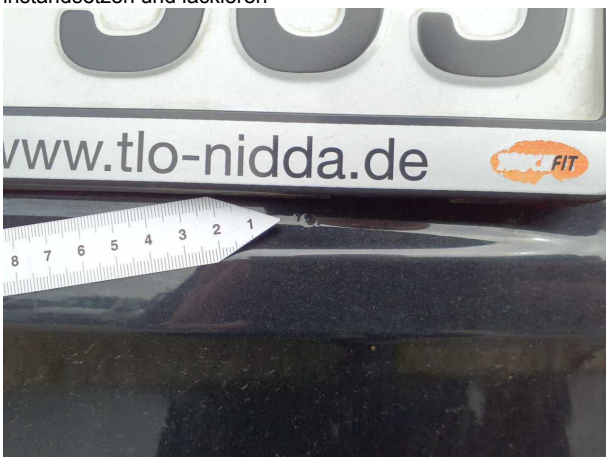
Beschädigung #4: Heckklappe/-tür: Heckklappe - Korrosion - instandsetzen und lackieren
