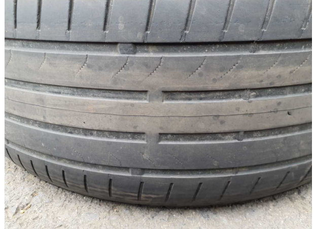
Beschädigung #12: 2.Radsatz: 2 Reifen - verschlissen - erneuern
