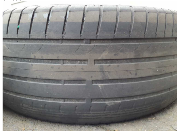
Beschädigung #12: 2.Radsatz: 2 Reifen - verschlissen - erneuern
