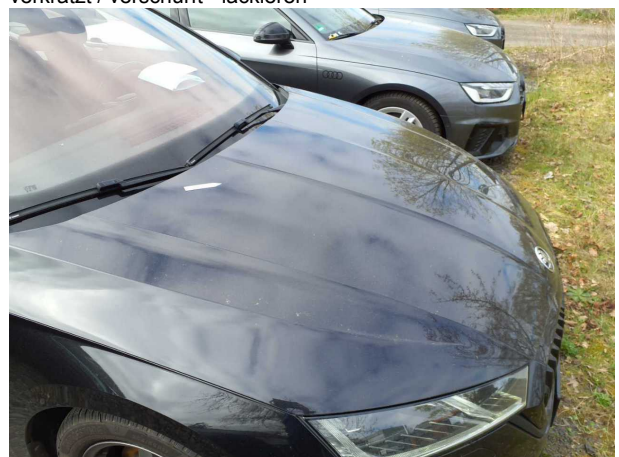
Beschädigung #9: Motorhaube: Motorhaube - Kratzer - lackieren
