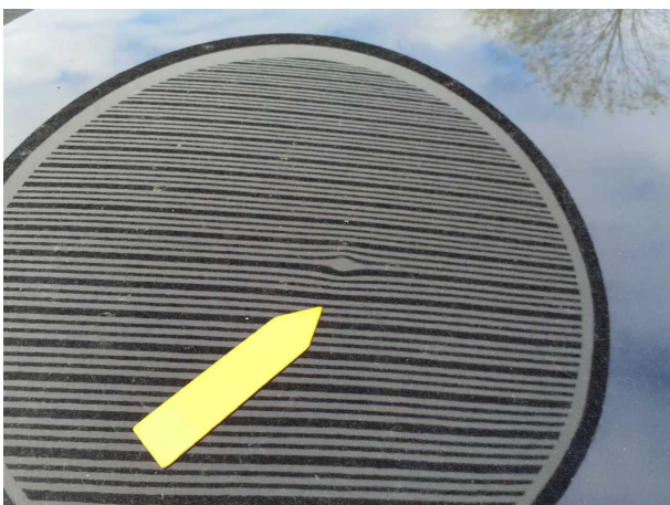
Beschädigung #10: Fahrzeugdach: Dach - Delle(n) - Smart Repair
