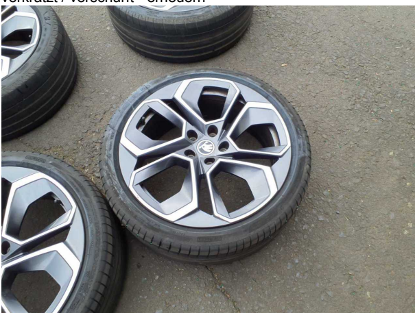
Beschädigung #11: 2.Radsatz: Leichtmetallfelgensatz komplett - verkratzt / verschürft - erneuern
