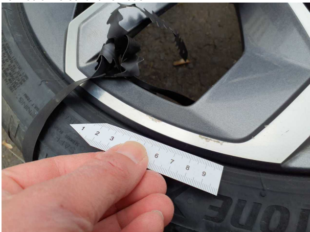
Beschädigung #11: 2.Radsatz: Leichtmetallfelgensatz komplett - verkratzt / verschürft - erneuern
