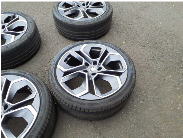
Beschädigung #12: 2.Radsatz: 2 Reifen - verschlissen - erneuern
