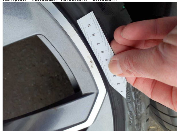
Beschädigung #11: 2.Radsatz: Leichtmetallfelgensatz komplett - verkratzt / verschürft - erneuern
