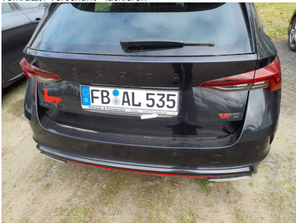
Beschädigung #4: Heckklappe/-tür: Heckklappe - Korrosion - instandsetzen und lackieren
