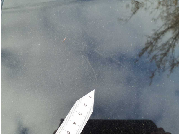
Beschädigung #9: Motorhaube: Motorhaube - Kratzer - lackieren
