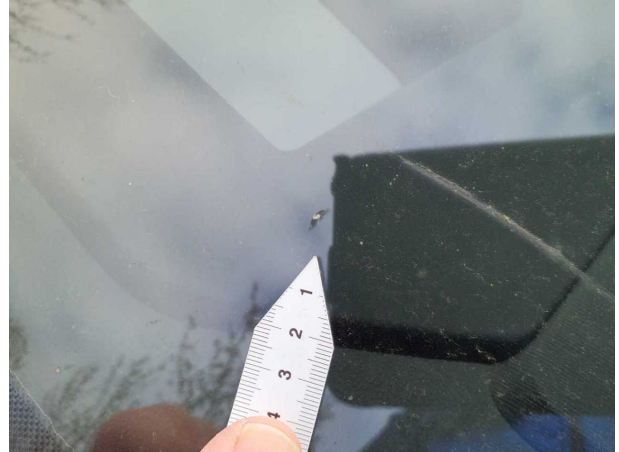
Beschädigung #1: Verglasung: Frontscheibe - Steinschlag - erneuern
