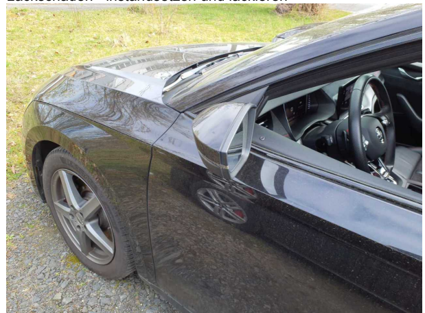
Beschädigung #8: Außenspiegel links: Abdeckkappe - verkratzt / verschürft - lackieren
