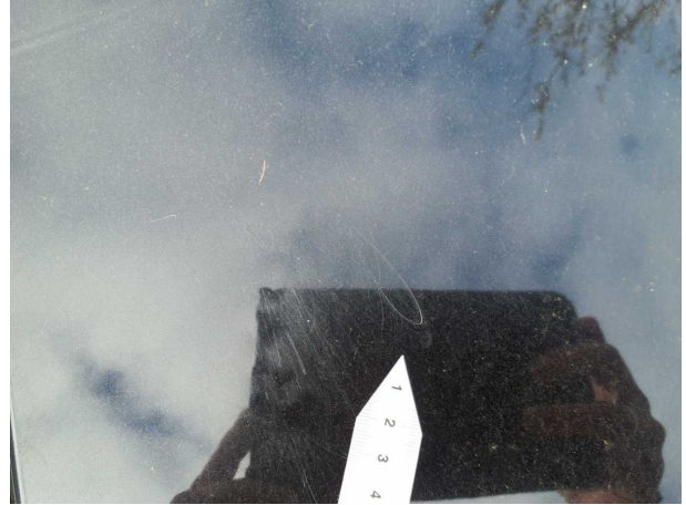
Beschädigung #9: Motorhaube: Motorhaube - Kratzer - lackieren
