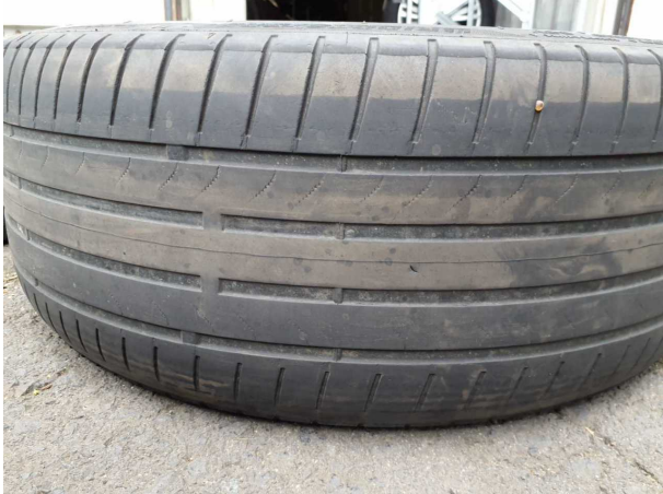
Beschädigung #12: 2.Radsatz: 2 Reifen - verschlissen - erneuern
