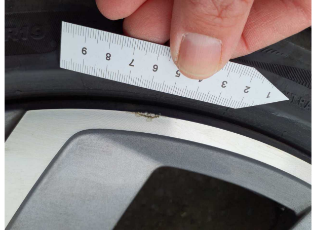
Beschädigung #11: 2.Radsatz: Leichtmetallfelgensatz komplett - verkratzt / verschürft - erneuern
