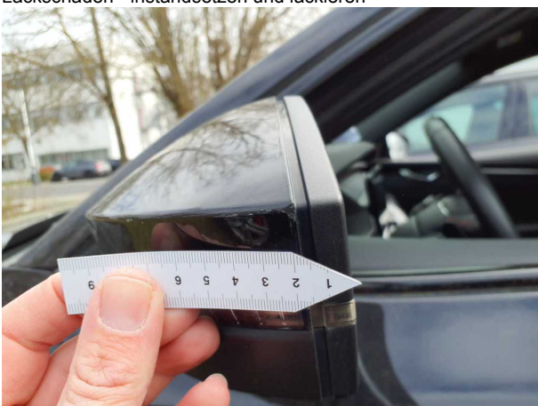
Beschädigung #8: Außenspiegel links: Abdeckkappe - verkratzt / verschürft - lackieren
